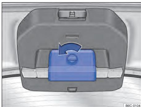
Fig. 47 Na tampa traseira: suporte para o triângulo de segurança.
