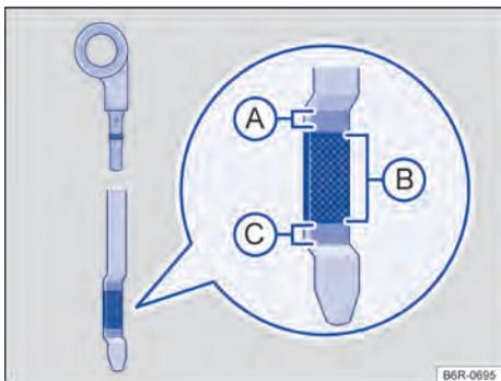
Fig. 186 Vareta de medição do óleo com marcas de nível do óleo do motor.
