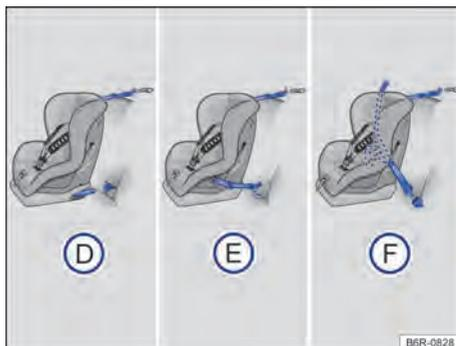
**Fig. 41** No banco traseiro: as figuras **D** e **E** mostram o princípio da fixação do sistema de retenção para crianças nos olhalês de retenção inferiores e com o cinto de fixação superior. A figura **F** mostra a fixação do sistema de retenção para crianças com o cinto de segurança do veículo e com o cinto de fixação superior.
