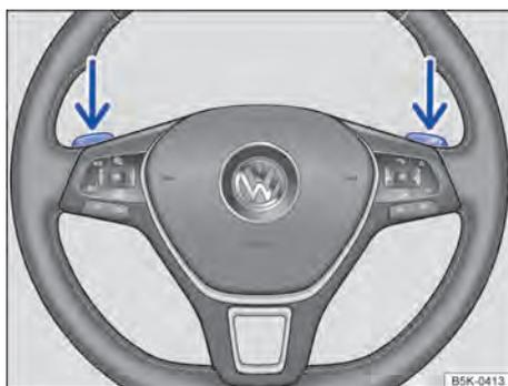
Fig. 93 Volante com seletores basculantes do Tiptronic.
