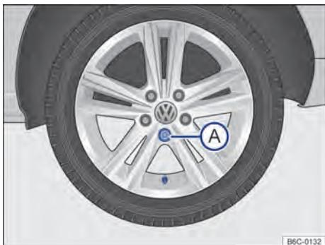
Fig. 199 Retirar a calota integral.
