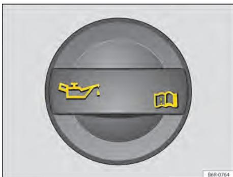
Fig. 187 No compartimento do motor: tampa da abertura para enchimento de óleo do motor.
