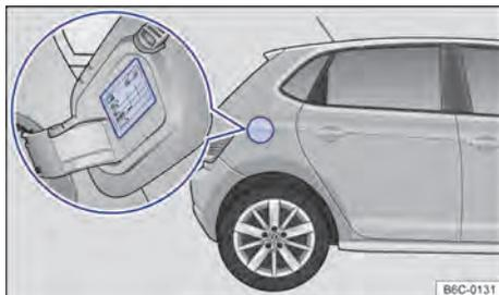
Fig. 195 Na parte interna da portinhola do tanque de combustível: etiqueta com a pressão dos pneus.
