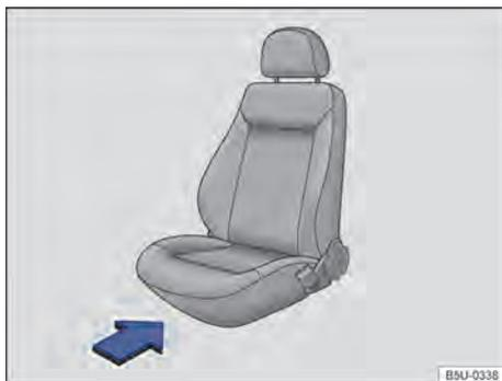
**Fig. 48** Na parte frontal do banco do passageiro dianteiro: localização para instalação do suporte do extintor de incêndio.
