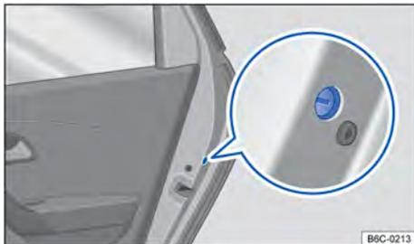
**Fig. 56** Na porta traseira: travamento de emergência.
