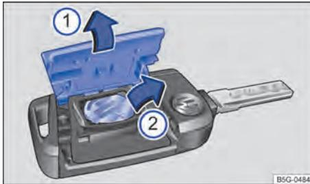
Fig. 50 Chave do veículo: substituir a bateria.
