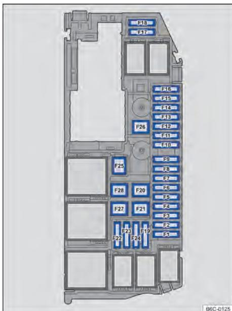
**Fig. 176** No compartimento do motor: disposição dos fusíveis.
