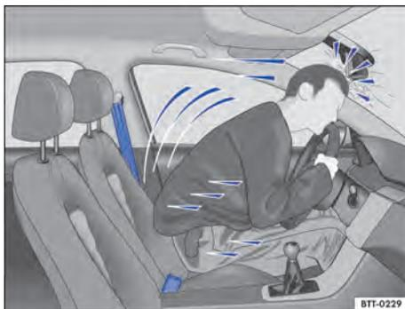
Fig. 26 O condutor sem cinto de segurança é lançado para frente.
