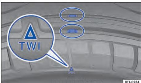
Fig. 196 Perfil do pneu: indicadores de desgaste.
