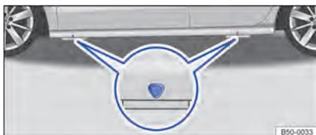
**Fig. 201** Pontos de apoio do macaco.
