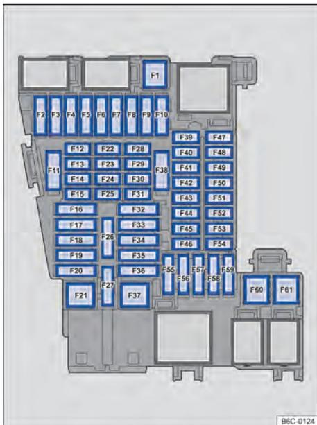
Fig. 174 No painel de instrumentos: disposição dos fusíveis.
