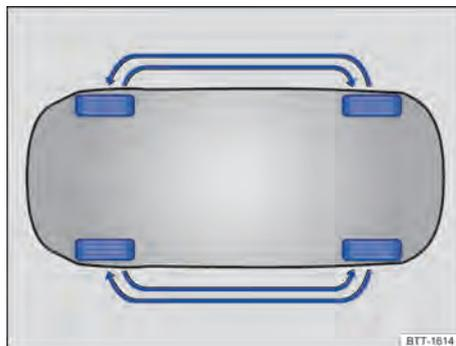
Fig. 193 Esquema para a troca das rodas.
