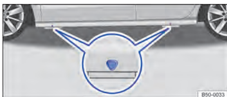
Fig. 201 Pontos de apoio do macaco.
