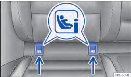
Fig. 42 No banco do veículo: identificação dos pontos de ancoragem inferiores para cadeiras de criança.
