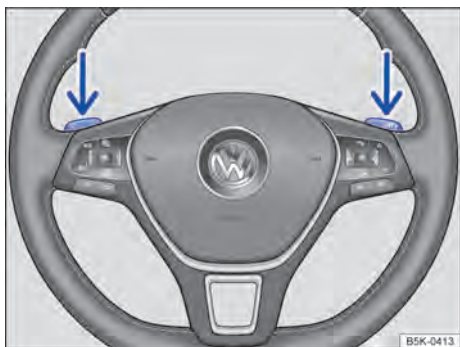
Fig. 93 Volante com seletores basculantes do Tiptronic.
