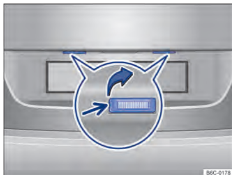
Fig. 169 No para-choque traseiro: lanterna da placa de licença.
