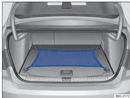
Fig. 160 No compartimento de bagagem: rede para bagagem.
