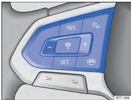
Fig. 102 Lado esquerdo do volante multifunções: botões para comandar o ACC.
