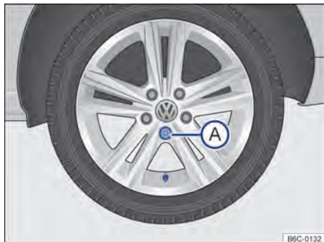
Fig. 196 Retirar a calota integral.
