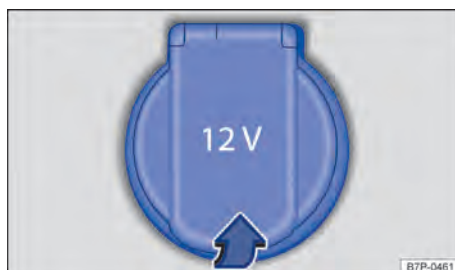
Fig. 116 No console central dianteiro: tomada 12 V.
