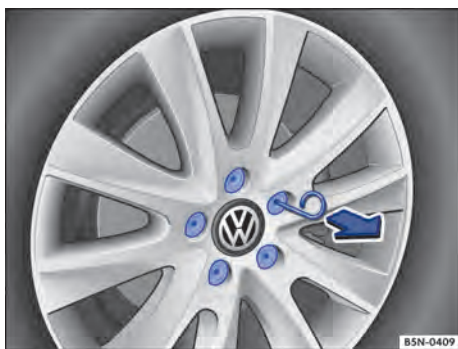
Fig. 197 Remover as capas de cobertura dos parafusos de roda.
