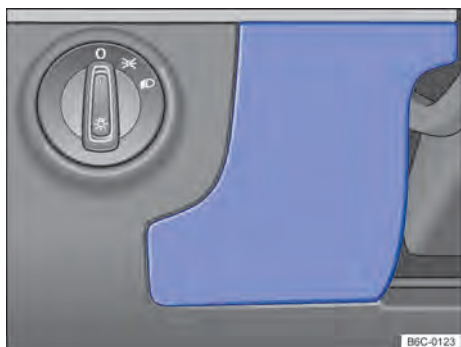
Fig. 171 No lado do condutor do painel de instrumentos: cobertura da caixa de fusíveis.
