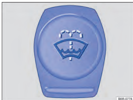
Fig. 183 No compartimento do motor: tampa do reservatório de água dos lavadores do para-brisa.
