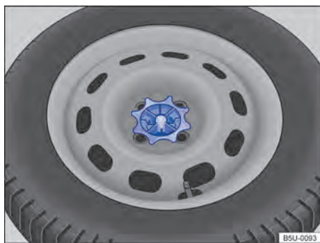
Fig. 194 No compartimento de bagagem: manípulo para fixação da roda de emergência.
