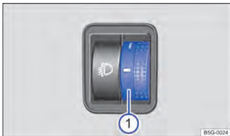
Fig. 74 Ao lado do volante: regulador do alcance do farol ①
