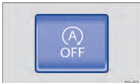
Fig. 97 Na parte inferior do console central: botão do sistema Start-Stop.
