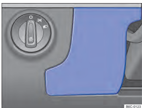
Fig. 142 No lado do condutor do painel de instrumentos: cobertura da caixa de fusíveis.
