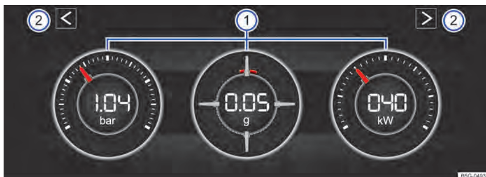
Fig. 24 No display do rádio: monitor de potência.
