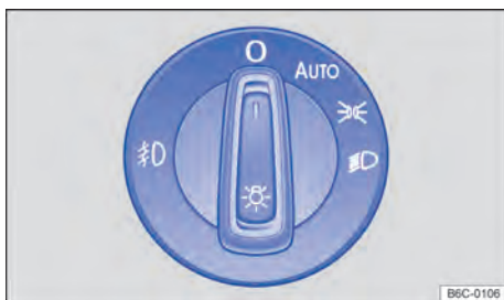
Fig. 77 Ao lado do volante: interruptor de luzes (uma variante).
