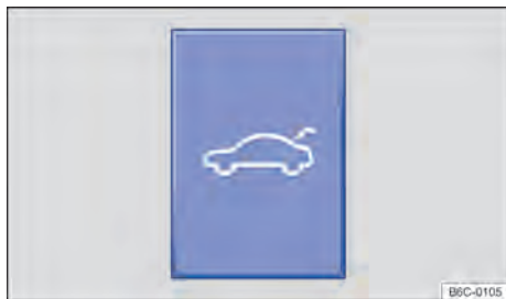
Fig. 65 No console central: botão de destravamento da tampa traseira.
