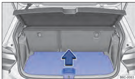
Fig. 120 No compartimento de bagagem: levantar o assoalho do compartimento de bagagem.
