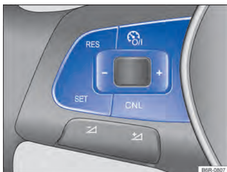
Fig. 105 Lado esquerdo do volante multifunções: botões para comandar o GRA.
