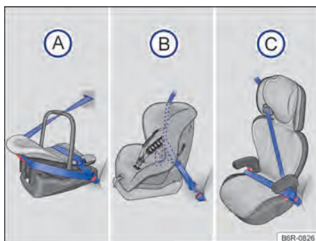
Fig. 46 As ilustrações A, B e C mostram a fixação do sistema de retenção para crianças apenas com o cinto de segurança do veículo.
