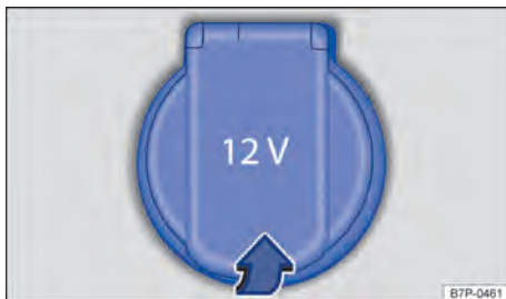
Fig. 117 No console central dianteiro: tomada 12 V.
