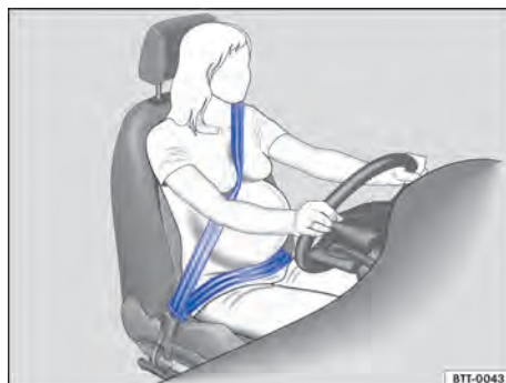
Fig. 38 Posição correta do cadarço do cinto de segurança para mulheres grávidas.
