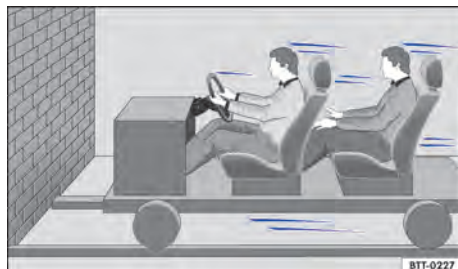
Fig. 30 Um veículo com os ocupantes do veículo sem cintos de segurança está em rota de colisão com um muro.
