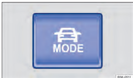
Fig. 103 No console central: botão MODE na seleção do perfil de condução.
