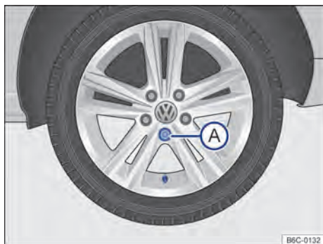
Fig. 167 Retirar a calota integral.
