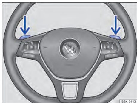
Fig. 101 Volante com seletores basculantes do Tiptronic.
