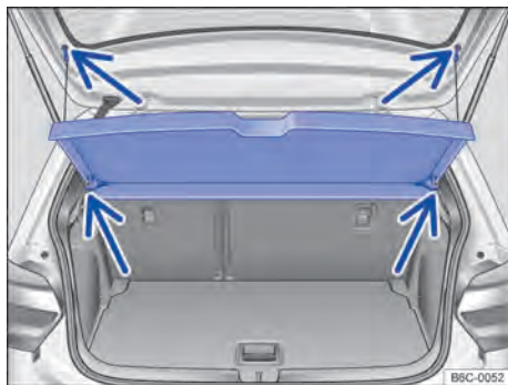
Fig. 119 No compartimento de bagagem: remover e instalar a cobertura do compartimento de bagagem.
