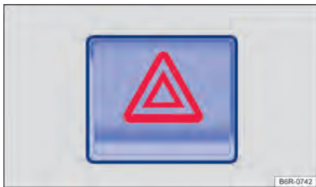
Fig. 52 Na parte superior do console central: interruptor das luzes de advertência.
