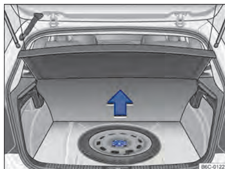
Fig. 127 No compartimento de bagagem, sob o revestimento de assoalho: roda de emergência e ferramentas de bordo.
