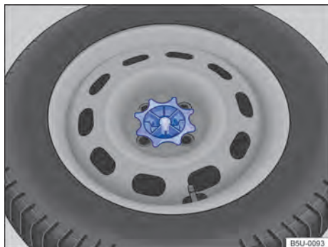
Fig. 165 No compartimento de bagagem: manípulo para fixação da roda de emergência.
