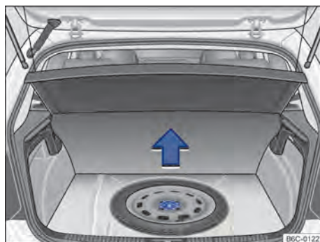
Fig. 162 No compartimento de bagagem, sob o revestimento de assoalho: roda de emergência e ferramentas de bordo.
