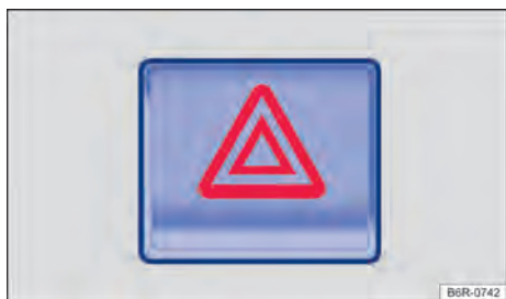
Fig. 49 Na parte superior do console central: interruptor das luzes de advertência.
