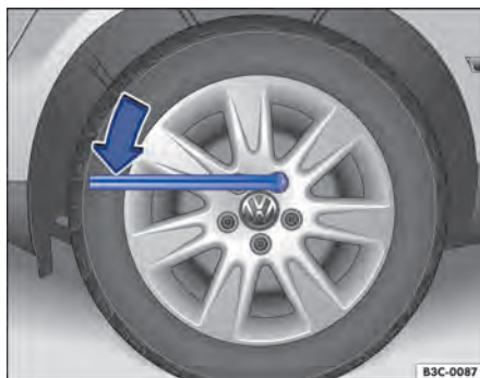
Fig. 202 Troca de roda: soltar os parafusos da roda. ►
