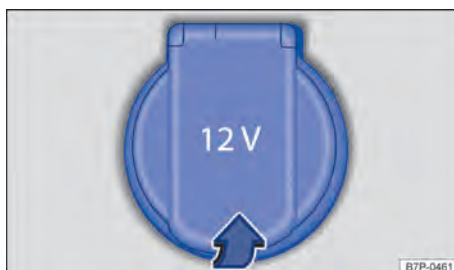
Fig. 113 No console central dianteiro: tomada 12 V.
