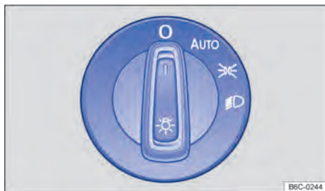
Fig. 71 Ao lado do volante: interruptor de luzes (uma variante).
