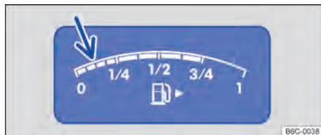
Fig. 13 No instrumento combinado analógico: indicador do nível de combustível.
