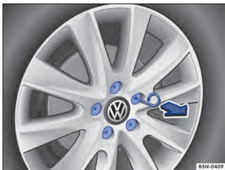
Fig. 201 Remover as capas de cobertura dos parafusos de roda.
