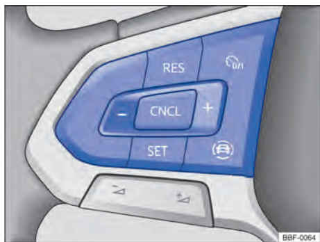
Fig. 98 Lado esquerdo do volante multifunções: botões para comandar o GRA.
