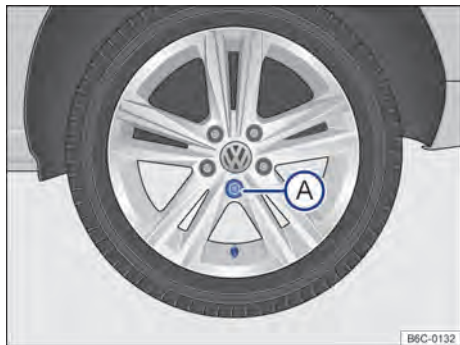
Fig. 200 Retirar a calota integral.
