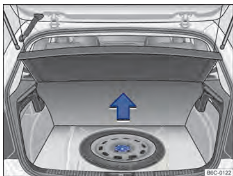
Fig. 177 No compartimento de bagagem, sob o revestimento de assoalho: roda de emergência e ferramentas de bordo.
