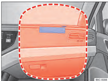
Fig. 39 Local de instalação e área de expansão do airbag frontal do passageiro dianteiro.
