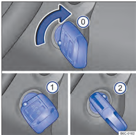
Fig. 91 Ao lado do volante, à direita: posições da chave do veículo no cilindro da ignição.
