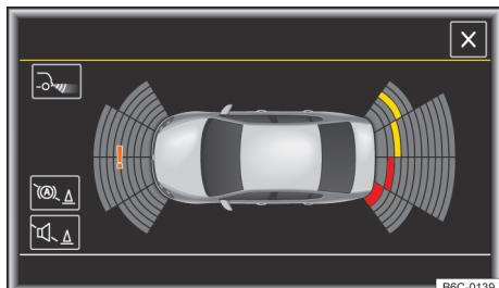
**Fig. 103** Indicação no sistema do rádio: modo de te-la cheia. As áreas registradas dependem da versão do veículo.
