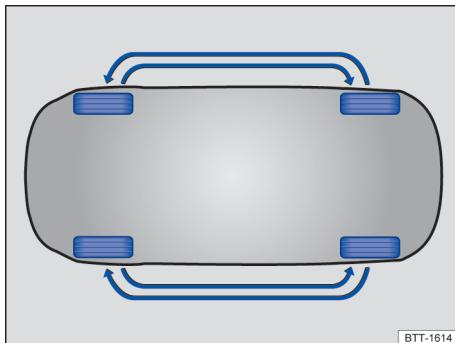
**Fig. 156** Esquema para a troca das rodas.
