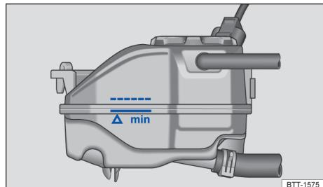
Fig. 151 No compartimento do motor: marcação no reservatório de expansão do líquido de arrefecimento do motor.
