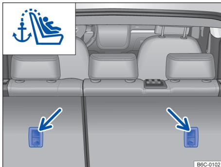
Fig. 46 Olhos de retenção para o cinto de fixação superior no lado de trás do banco traseiro.
