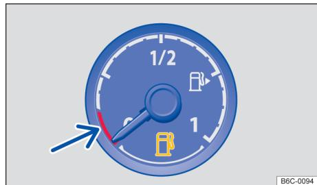
Fig. 15 No instrumento combinado analógico: indicador do nível de combustível (variante 2).
