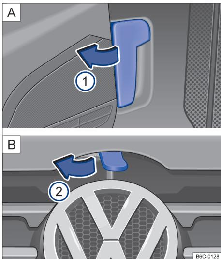
**Fig. 145** **A** Alavanca de destravamento da tampa do compartimento do motor na área para os pés do lado do condutor. **B** Alavanca de destravamento na parte interna da tampa do compartimento do motor.
