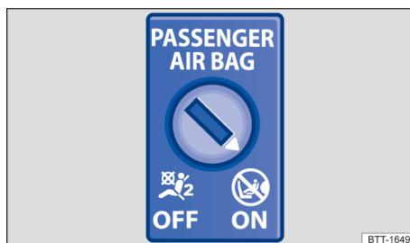
[Fig. 40](#) No painel de instrumentos no lado do passageiro dianteiro: interruptor acionado pela chave para desligar e ligar o airbag frontal do passageiro dianteiro.
