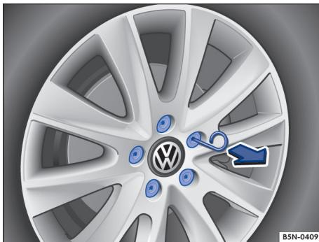
Fig. 163 Remover as capas de cobertura dos parafusos de roda.
