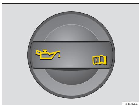
Fig. 150 No compartimento do motor: tampa da abertura para enchimento de óleo do motor.
