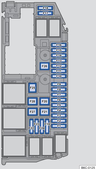
Fig. 140 No compartimento do motor: disposição dos fusíveis.
