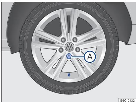
Fig. 162 Retirar a calota integral.
