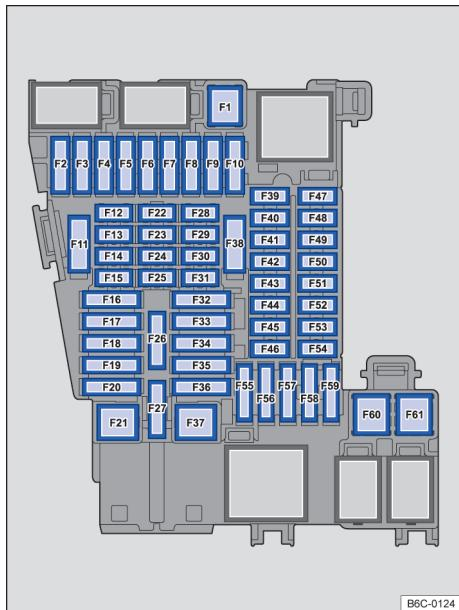
Fig. 138 No painel de instrumentos: disposição dos fusíveis.
