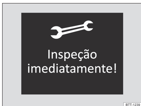
Fig. 19 No display do instrumento combinado: exemplo de indicação para um evento de serviço próximo de vencer (representação esquemática).
