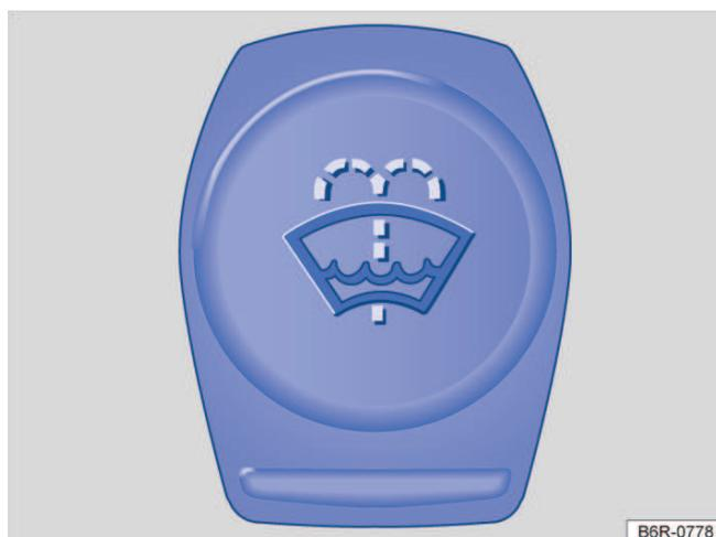
**Fig. 150** No compartimento do motor: tampa do reservatório de água dos lavadores dos vidros.
