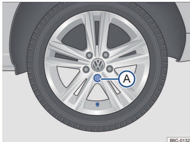
Fig. 164 Retirar a calota integral.
