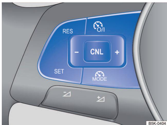
**Fig. 101** Lado esquerdo do volante multifunções: botões para comandar o GRA.
