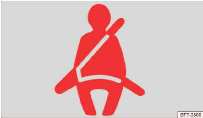
Fig. 25 Luz de advertência no display do instrumento combinado.
