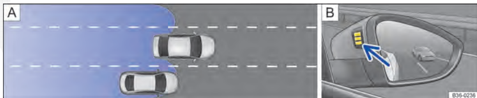
Fig. 239 A) Situação de condução ao ultrapassar e mudar frequentemente de faixa. B) Indicação visual no espelho retrovisor externo direito.
