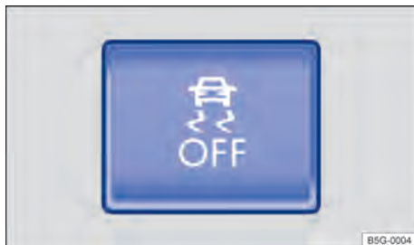
Fig. 187 Na parte inferior do console central: botão para desligar e ligar manualmente o ASR, ASR com ESC ou ESC Sport.
