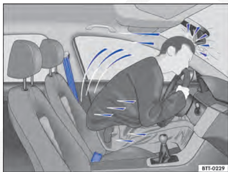
Fig. 79 O condutor sem cinto de segurança é lançado para frente.
