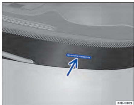
Fig. 322 No para-brisa: número de identificação do veículo.
