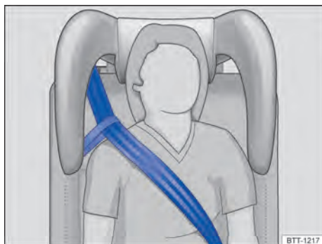
Fig. 107 Cadeira de criança integrada: posição do cadarço do cinto de segurança com alça de passagem do cinto de segurança.
