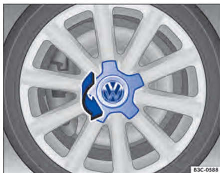
Fig. 290 Virar a calota central.
