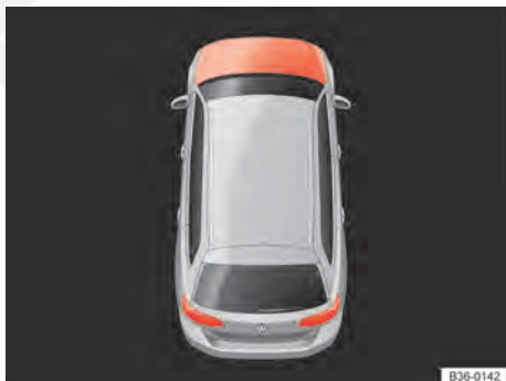
Fig. 257 Representação esquemática do display do instrumento combinado: tampa do compartimento do motor aberta ou fechada incorretamente.
