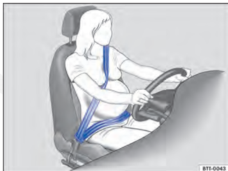
Fig. 85 Posição correta do cadarço do cinto de segurança para mulheres grávidas.
