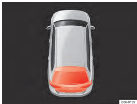
Fig. 46 Passat Variant: no display do instrumento combinado: tampa do compartimento de bagagem aberta ou fechada incorretamente.
