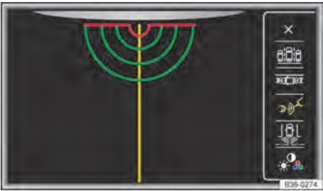
Fig. 207 Exibição do display da câmera de marcha a ré: assistente do reboque.
