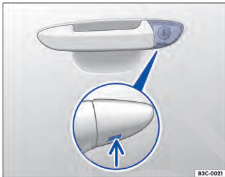
Fig. 243 Maçaneta da porta do condutor: cilindro da fechadura coberto.
