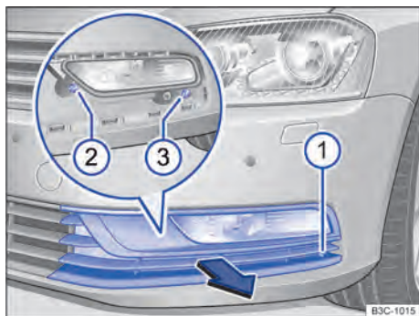
Fig. 274 No para-choque dianteiro à esquerda: lanterna para luz de neblina, farol de rodagem diurna e farol de conversão.
