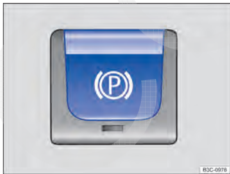
Fig. 168 Na parte inferior do console central: botão do freio de estacionamento eletrônico.
