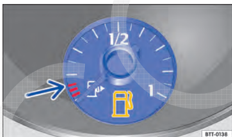
Fig. 215 No instrumento combinado: indicador do nível de combustível para gasolina e óleo diesel.
