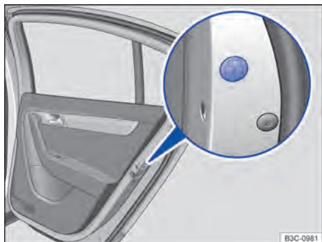
Fig. 244 Na parte dianteira da porta traseira direita: travamento de emergência, coberto por uma vedação de borracha.
