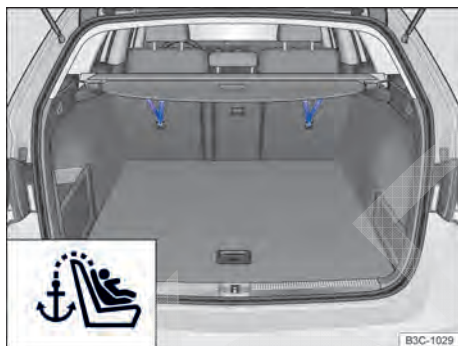
Fig. 89 Cintos de fixação superiores encaixados no compartimento de bagagem.
