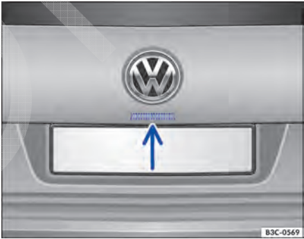
Fig. 37 Botão acima do suporte da placa de licença traseira: abrir a tampa traseira por fora.
