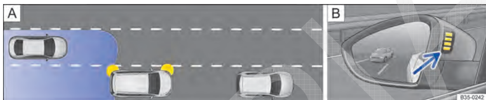
Fig. 204 Representação esquemática: A: situação de condução ao ultrapassar com o trânsito traseiro. B: indicador do assistente de mudança de faixa no espelho retrovisor externo esquerdo.
