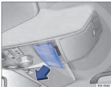
Fig. 247 No revestimento do teto: remover a cobertura.
