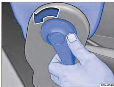
Fig. 66 Destravar o encosto do banco do passageiro dianteiro rebatível.
