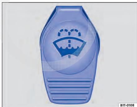
Fig. 106 No compartimento do motor: tampa do reservatório de água dos lavadores dos vidros.
