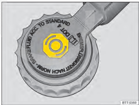
Fig. 170 No compartimento do motor: tampa do reservatório do fluido de freio.
