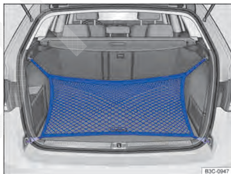
Fig. 120 No compartimento de bagagem: rede para bagagem presa no canto do compartimento de bagagem.
