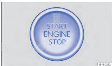
Fig. 158 Na parte inferior do console central: botão de partida do sistema de travamento e de partida Keyless Access sem chave.
