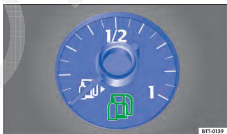
Fig. 216 No instrumento combinado: indicador do nível de combustível para gás natural.
