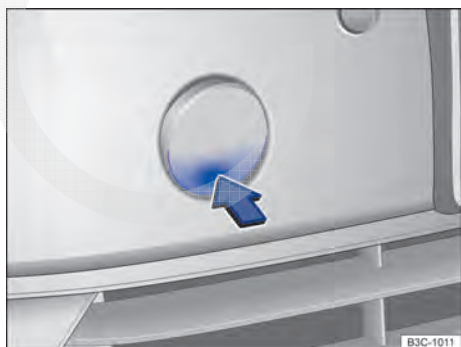
Fig. 285 No para-choque dianteiro à direita: retirar a cobertura.
