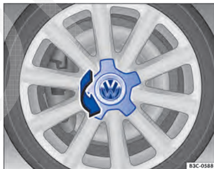
Fig. 255 Desparafusar a calota central.
