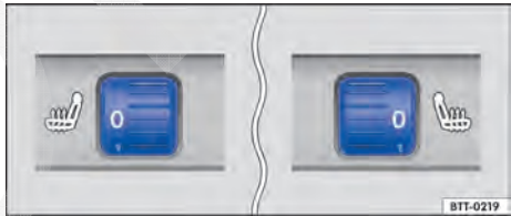
Fig. 59 No console central traseiro: regulador do aquecimento dos bancos dos assentos traseiros.
