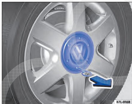
Fig. 254 Retirar a calota central.
