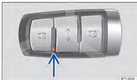
Fig. 25 Luz de controle da chave do veículo.
