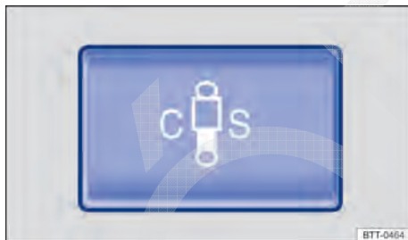
Fig. 208 No console central: botão de ajuste da regulagem dinâmica da suspensão.
