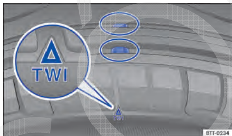
Fig. 236 Perfil do pneu: indicador de desgaste.
