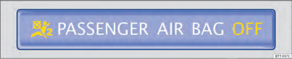
Fig. 79 Na parte superior do console central: luz de aviso de airbag dianteiro do passageiro dianteiro desligado.
