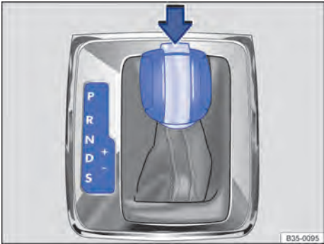
Fig. 164 Direção à esquerda: alavanca seletora da transmissão automática com trava de bloqueio (seta).
