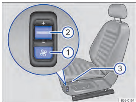
Fig. 60 No assento dianteiro: interruptor para a ventilação do assento
