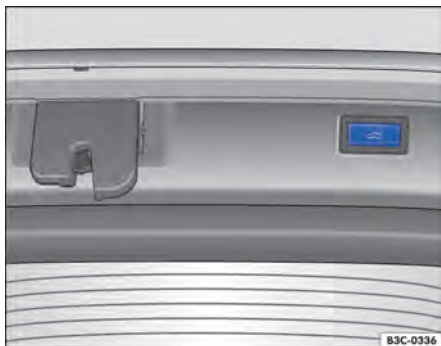
Fig. 39 Na tampa traseira aberta: botão para fechar eletricamente a tampa traseira.
