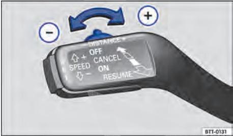
Fig. 197 Alavanca de operação ACC à esquerda na coluna de direção: ajustar o nível de distância.
