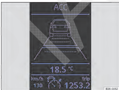
Fig. 195 No display do instrumento combinado: ACC não ativado no momento, veículo adiante reconhecido.
