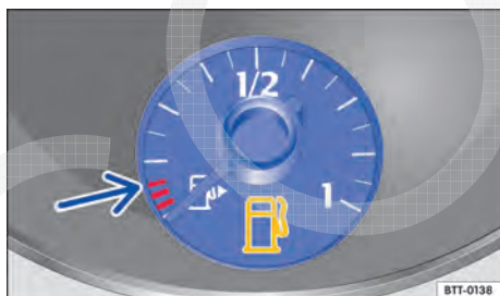
Fig. 214 No instrumento combinado: indicador do nível de combustível para gasolina e óleo diesel.
