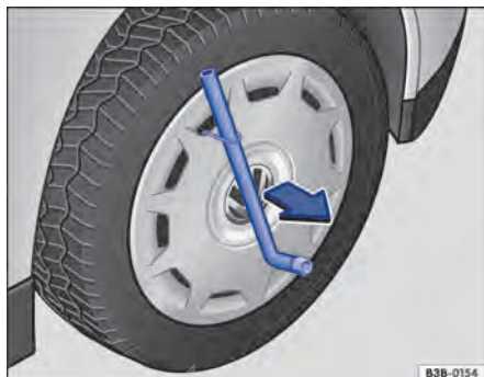
Fig. 254 Retirar a calota integral.
