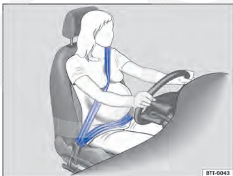
Fig. 77 Posição correta do cadarço do cinto de segurança para mulheres grávidas.
