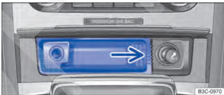
Fig. 151 No console central dianteiro: retirar cinzeiro.
