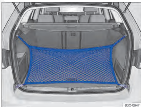
Fig. 121 No compartimento de bagagem: rede para bagagem presa no canto do compartimento de bagagem.
