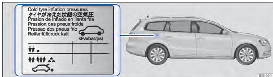
Fig. 233 Do lado interno da portinhola do tanque: placa de pressão dos pneus.
