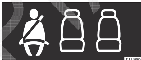
Fig. 68 Indicador do status do cinto para os assentos traseiros no instrumento combinado.
