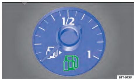
Fig. 215 No instrumento combinado: indicador do nível de combustível para gás natural.
