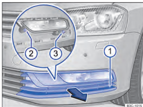
Fig. 272 No para-choque dianteiro à esquerda: lanterna para luz de neblina, farol de rodagem diurna e farol de conversão.
