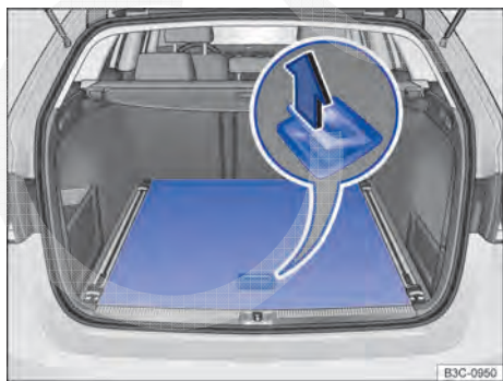
Fig. 126 No compartimento de bagagem: abrir o assoalho do compartimento de bagagem.
