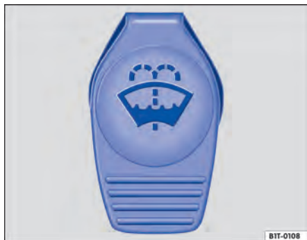
Fig. 107 No compartimento do motor: tampa do reservatório de água dos lavadores dos vidros.
