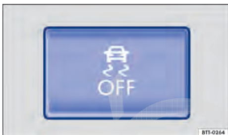
Fig. 171 No console central: botão para desligar e ligar o ASR manualmente.
