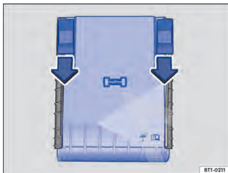
Fig. 267 No compartimento do motor: cobertura da caixa de fusíveis.
