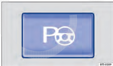
Fig. 188 Na parte inferior do console central: botão para ligar o assistente de direção para estacionamento.
