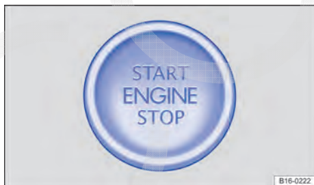
Fig. 160 Na parte inferior do console central: botão de partida do sistema de travamento e de partida Keyless Access sem chave.
