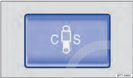
Fig. 207 No console central: botão de ajuste da regulagem dinâmica da suspensão.
