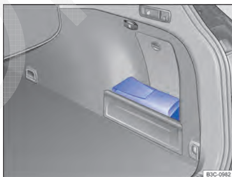
Fig. 250 No compartimento de bagagem à direita: porta-objetos com bolsa com ferramentas de bordo e, se for o caso, bolsa com macaco e chave de roda.
