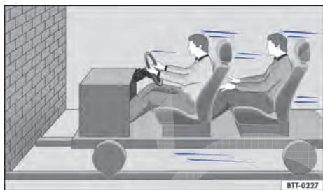
Fig. 69 Um veículo com os ocupantes do veículo sem cintos de segurança está em rota de colisão com um muro.
