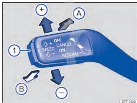
Fig. 193 À esquerda na coluna da direção: alavanca de comando do GRA.
