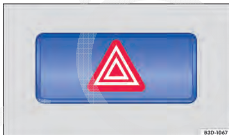
Fig. 239 Na parte superior do console central: interruptor para o pisca alerta.
