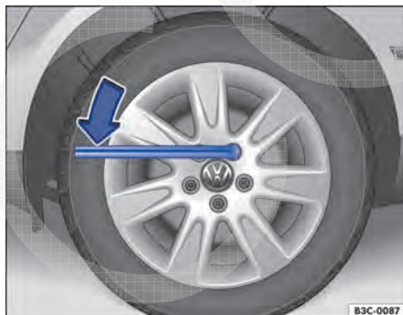
Fig. 256 Troca de roda: Afrouxar os parafusos de roda.
