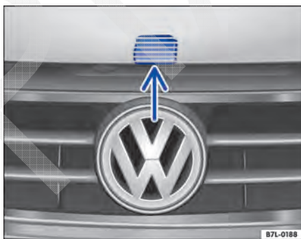
Fig. 221 Alavanca de destravamento para abrir a tampa do compartimento do motor na grade do radiador.
