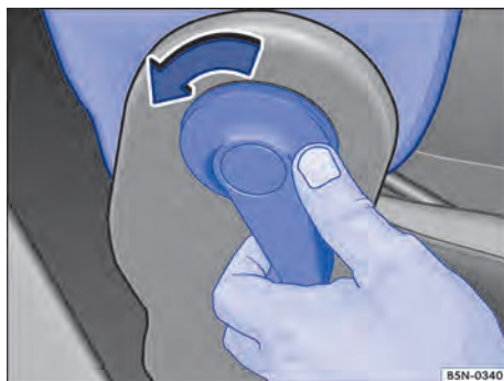
Fig. 66 Destravar o encosto do banco do passageiro dianteiro rebatível.
