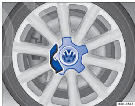
Fig. 253 Desparafusar a calota central.
