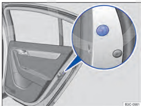
Fig. 242 Na parte dianteira da porta traseira direita: travamento de emergência, coberto por uma vedação de borracha.
