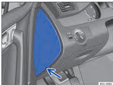
Fig. 266 No lado do condutor do painel de instrumentos: cobertura da caixa de fusíveis.
