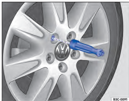
Fig. 264 Troca de roda: desparafusar os parafusos de roda com o punho da chave de fenda.
