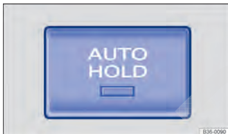
Fig. 176 No console central: tecla para Auto Hold.
