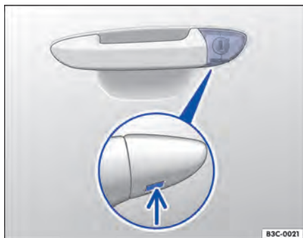
Fig. 241 Maçaneta da porta do condutor: cilindro da fechadura coberto.
