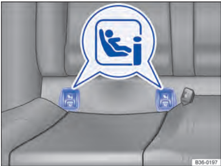
Fig. 58 No banco do veículo: identificação dos pontos de ancoragem ISOFIX para cadeiras de criança.
