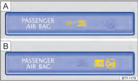
Fig. 45 Na parte superior do console central: luz de controle para o airbag frontal do passageiro dianteiro desligado [A] ou luz de controle para o airbag frontal do passageiro dianteiro ligado [B].
