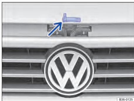
Fig. 254 Acima da grade do radiador: alavanca de abertura da tampa de compartimento do motor
