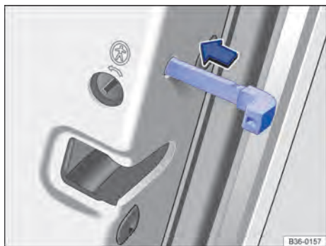
Fig. 80 Na parte dianteira da porta traseira direita: travamento de emergência do veículo com a chave de emergência.
