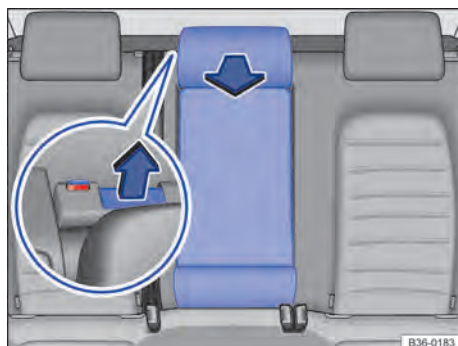
Fig. 218 No habitáculo: abrir o dispositivo para transporte de objetos longos.
