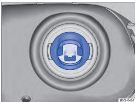
Fig. 225 No bocal de abastecimento do reservatório: proteção contra abastecimento incorreto.
