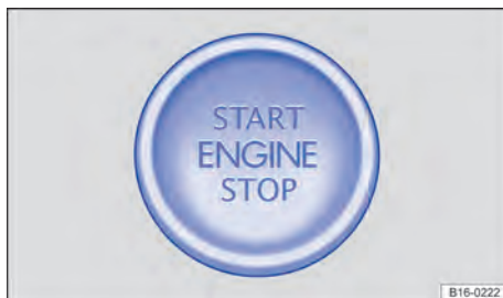
Fig. 131 Na parte inferior do console central: botão de partida para arrancar o motor.
