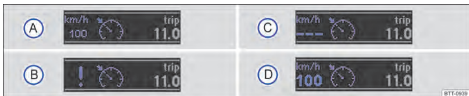
Fig. 146 No display do instrumento combinado: indicadores de status do GRA (representação esquemática).
