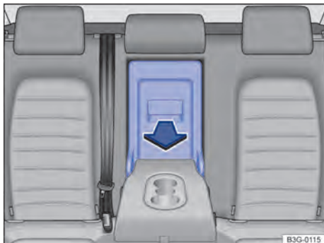
Fig. 216 No habitáculo: abrir o dispositivo para transporte de objetos longos.
