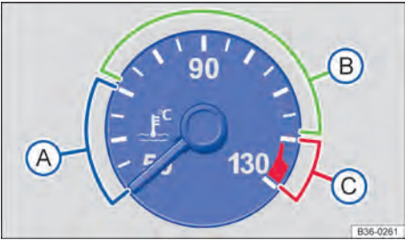
Fig. 23 Indicador de temperatura do líquido de arrefecimento do motor no instrumento combinado: (A) área fria; (B) área normal; (C) área de advertência.
