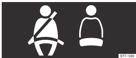
Fig. 34 No display do instrumento combinado: indicador de status do cinto de segurança para os assentos traseiros.
