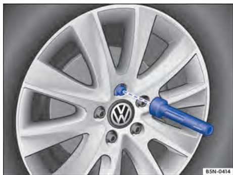
Fig. 282 Troca de roda: desaparafusar os parafusos de roda com o punho da chave de fenda.
