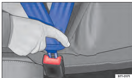
Fig. 40 Introduzir a lingueta do cinto de segurança no fecho do cinto de segurança.
