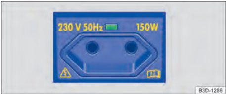
Fig. 185 No console central traseiro: tomada 230 V (padrão euro).
