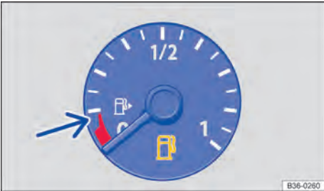
Fig. 22 No instrumento combinado: indicador do nível de combustível para gasolina e óleo diesel.
