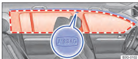
Fig. 52 No lado esquerdo do veículo (Passat Variant): local de instalação e área de expansão do airbag para cabeça.
