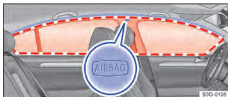
Fig. 51 No lado esquerdo do veículo (Passat): local de instalação e área de expansão do airbag para cabeça.
