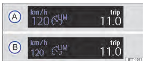
Fig. 150 No display do instrumento combinado: indicadores de status do limitador de velocidade (representação esquemática).
