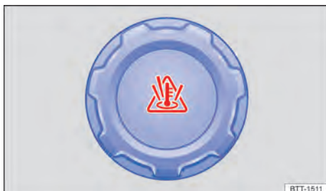
Fig. 260 No compartimento do motor: tampa do reservatório de expansão do líquido de arrefecimento (representação esquemática).
