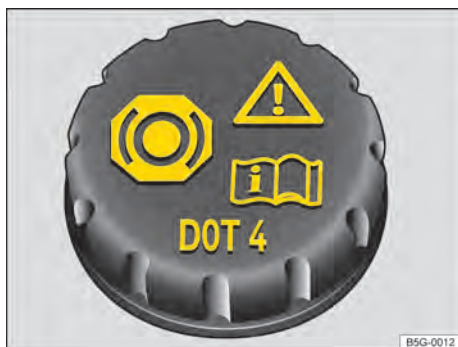
Fig. 261 No compartimento do motor: tampa do reservatório de fluido de freio.
