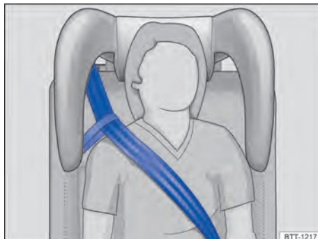
Fig. 65 Cadeira de criança integrada: posição do cadarço do cinto de segurança com alça de passagem do cinto de segurança.
