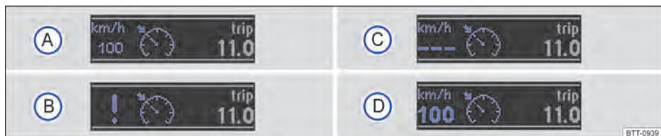
Fig. 148 No display do instrumento combinado: indicadores de status do GRA (representação esquemática).
