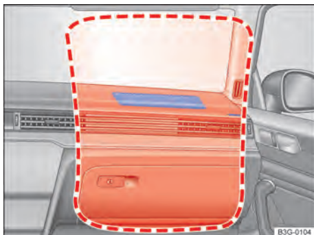
Fig. 47 Local de instalação e área de expansão do airbag frontal do passageiro dianteiro.
