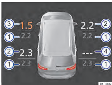
Fig. 265 Representação esquemática do indicador do display no display do instrumento combinado: pressões dos pneus atuais.
