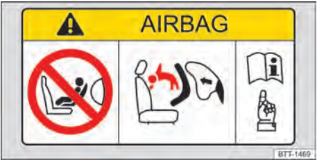
Fig. 56 Representação esquemática: etiqueta de airbag no para-sol.
