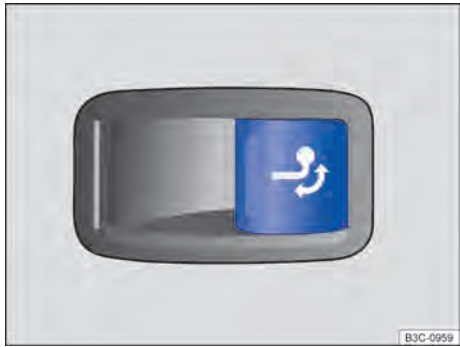
Fig. 220 No compartimento de bagagem, à direita: botão para destravamento da rótula de engate.
