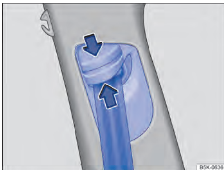
Fig. 44 Ao lado dos bancos dianteiros: regulagem de altura do cinto de segurança. ➤
