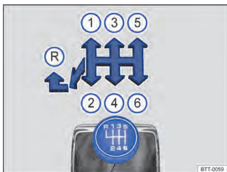
Fig. 135 Esquema de troca de marchas da transmissão manual de 6 marchas.
