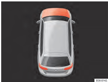
Fig. 255 No display do instrumento combinado: tampa do compartimento do motor aberta ou fechada incorretamente.
