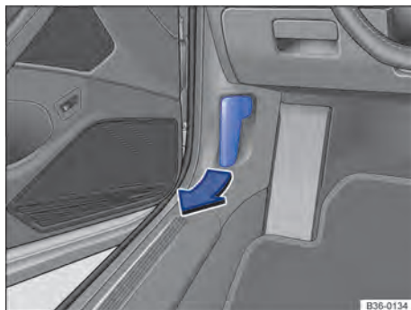
Fig. 253 No área para os pés no lado do condutor: alavanca de destravamento da tampa do compartimento do motor.
