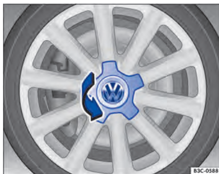
Fig. 273 Virar a calota central.
