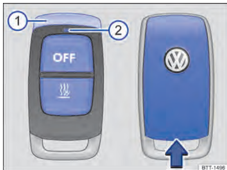
Fig. 125 Aquecimento estacionário: controle remoto (esq.) com compartimento da bateria (dir.).
