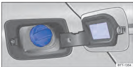
Fig. 224 Atrás da portinhola do tanque: tampa do tanque.
