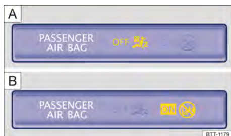
Fig. 14 Na parte superior do console central: luz de controle para o airbag frontal do passageiro dianteiro desligado A ou luz de controle para o airbag frontal do passageiro dianteiro ligado B .
