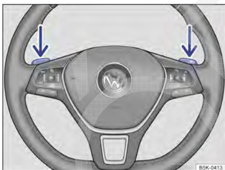
Fig. 153 Volante com seletores basculantes do Tiptronic.
