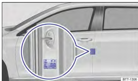
Fig. 309 Na coluna da porta do condutor: etiqueta de pressão dos pneus (alternativamente no lado interno da portinhola do tanque).
