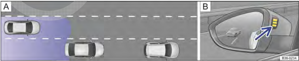
Fig. 180 [A] Situação de condução ao ultrapassar com o trânsito traseiro. [B] Indicação visual no espelho retrovisor externo esquerdo.
