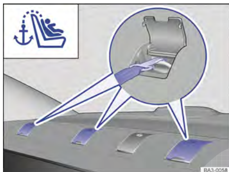
Fig. 29 Representação esquemática: olhal de retenção do Top Tether no porta-objetos atrás dos bancos traseiros (Passat).
