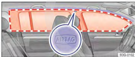
Fig. 21 No lado esquerdo do veículo (Passat Variant): local de instalação e área de expansão do airbag para cabeça.
