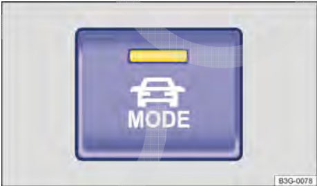
Fig. 156 Na parte inferior do console central: botão de seleção do perfil de condução.
