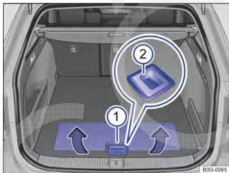
Fig. 235 No compartimento de bagagem: assoalho do compartimento de bagagem repartido.
