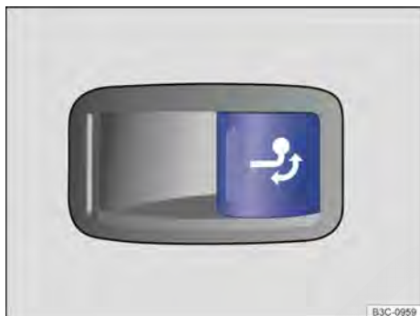
Fig. 261 No compartimento de bagagem, à direita: botão para destravamento da rótula de engate.
