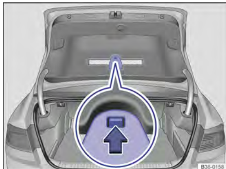
Fig. 36 Na tampa do compartimento de bagagem: suporte para o triângulo de segurança (Passat).
