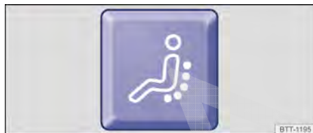
Fig. 116 Na região inferior do banco do condutor: botão da função de massagem.
