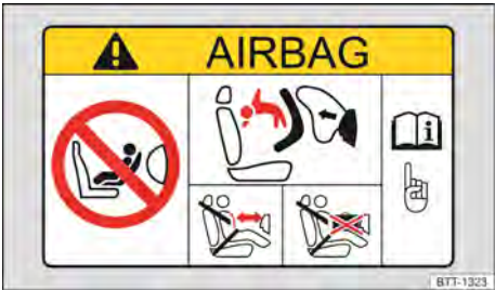
Fig. 25 Representação esquemática: etiqueta de airbag no para-sol.
