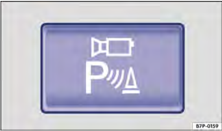
Fig. 205 Na parte superior do console central: botão para ligar manualmente a visão do ambiente.
