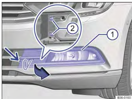
Fig. 275 No para-choque dianteiro à esquerda: lanterna para luz de neblina e farol de rodagem diurna.
