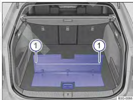
Fig. 236 No compartimento de bagagem: assoalho do compartimento de bagagem dividido.
