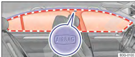
Fig. 20 No lado esquerdo do veículo (Passat): local de instalação e área de expansão do airbag para cabeça.
