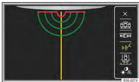
Fig. 197 Exibição do display da câmera de marcha a ré: assistente do reboque.
