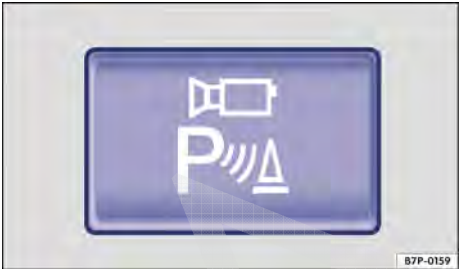
Fig. 187 Na parte superior do console central: Botão para ligar ou desligar o Park Pilot (depende da versão).
