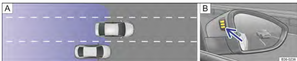
Fig. 181 (A) Situação de condução ao ultrapassar e mudar frequentemente de faixa. (B) Indicação visual no espelho retrovisor externo direito.
