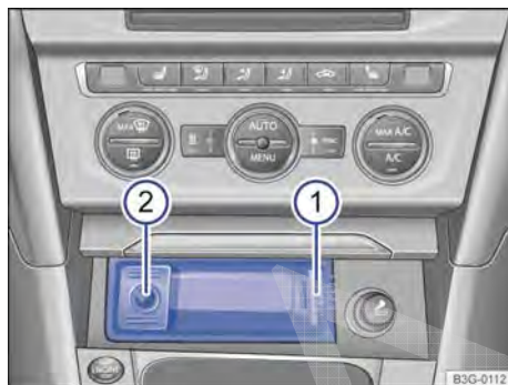
Fig. 220 No console central dianteiro: retirar o cinzeiro ① e apagador de cigarro ②.
