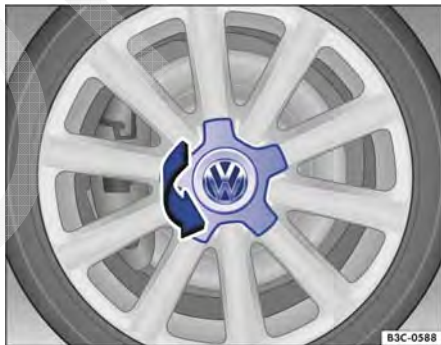
Fig. 314 Virar a calota central.
