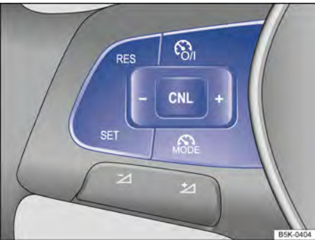
Fig. 162 Lado esquerdo do volante multifunções: botões para comandar o GRA.
