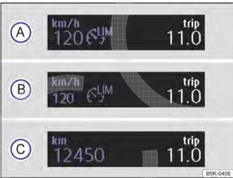
Fig. 163 No display do instrumento combinado: indicadores de status do limitador de velocidade.
