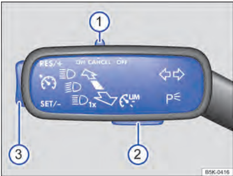
Fig. 219 À esquerda na coluna de direção: interruptores e botões para comandar o GRA.
