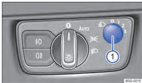
Fig. 110 Ao lado do volante: regulador da regulagem de alcance do farol ①.
