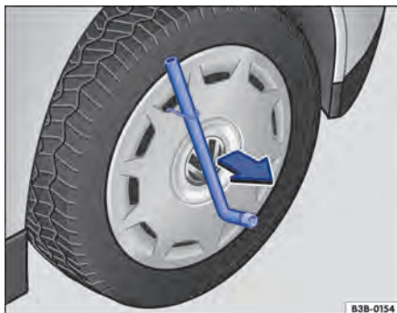
Fig. 291 Retirar a calota integral.
