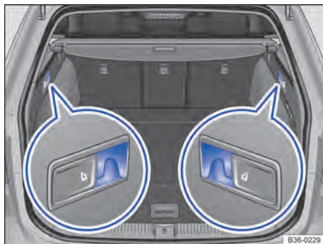
Fig. 138 No compartimento de bagagem: ganchos para sacolas na parte traseira.
