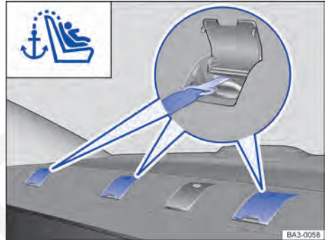
Fig. 102 Representação esquemática: olhais de retenção do Top Tether no porta-objetos atrás dos bancos traseiros (Passat).
