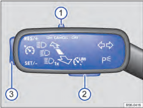
Fig. 222 À esquerda na coluna de direção: interruptores e botões para comandar o limitador de velocidade.
