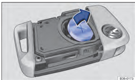
Fig. 35 Chave do veículo: remover a célula tipo botão.
