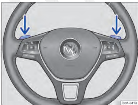
Fig. 184 Volante com 2 seletores basculantes do Tiptronic.
