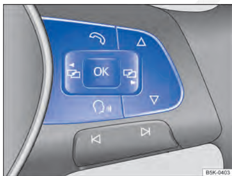
Fig. 27 Lado direito do volante multifunções: botões para comando dos menus e exibições de informação do instrumento combinado.
