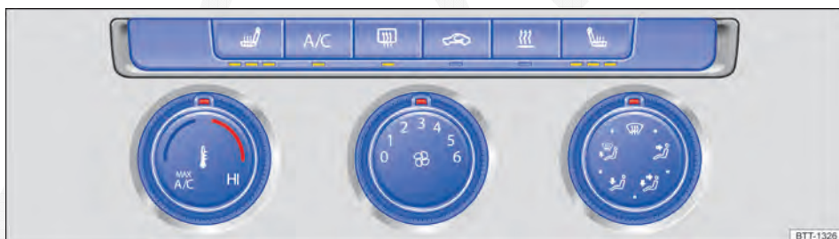
Fig. 245 Na parte superior do console central: comandos do ar-condicionado manual ou do sistema de ventilação e aquecimento.
