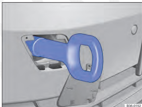
Fig. 318 No para-choque dianteiro à direita: argola de reboque rosqueada.
