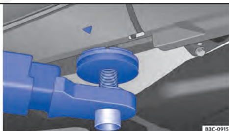
Fig. 277 Suspender com a plataforma elevatória: pontos de apoio em veículos sem cobertura.
