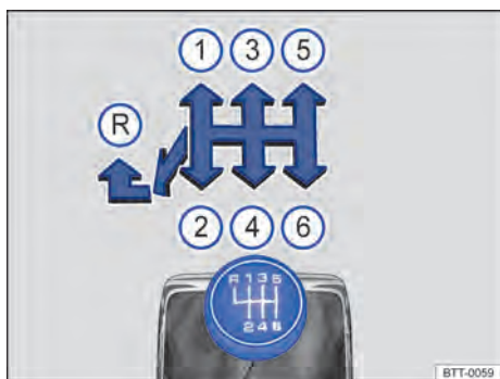
Fig. 180 Esquema de troca de marchas da transmissão manual de 6 marchas.
