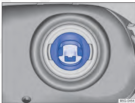
Fig. 254 Com a portinhola do tanque aberta: proteção contra abastecimento errado no bocal de abastecimento do tanque.
