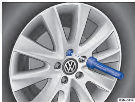
Fig. 299 Troca de roda: desaparafusar os parafusos de roda com o punho da chave de fenda.
