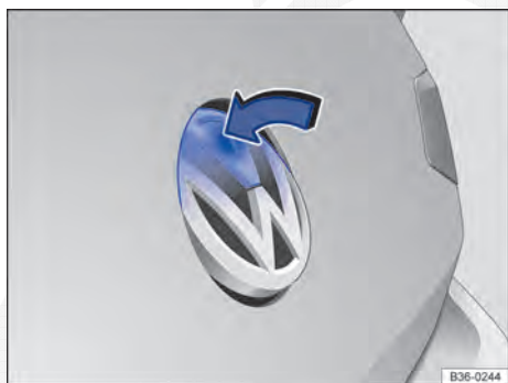
Fig. 51 Na tampa do compartimento de bagagem: logo da Volkswagen para abrir eletricamente a tampa do compartimento de bagagem. ►
