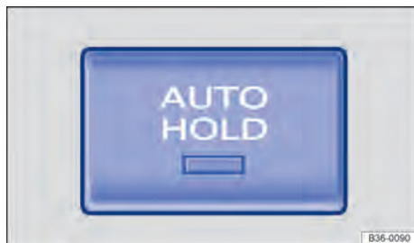
Fig. 153 No console central: botão do Auto Hold.
