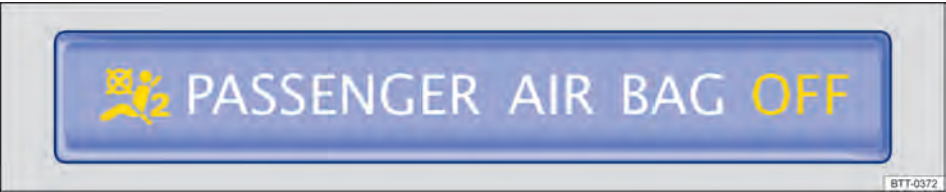
Fig. 72 Na parte superior do console central: luz de controle para o airbag frontal do passageiro dianteiro desligado.
