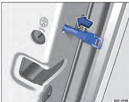
Fig. 222 Na parte dianteira da porta traseira direita: travamento de emergência do veículo com a chave de emergência.
