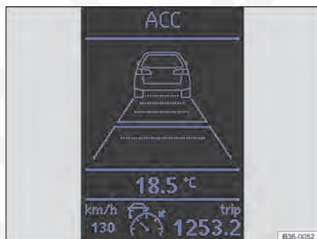
Fig. 171 No display do instrumento combinado: ACC não ativo temporariamente, veículo à frente reconhecido.
