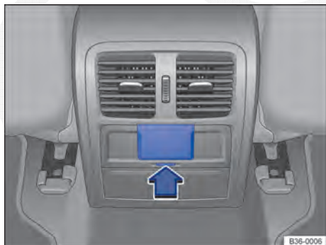
Fig. 136 Console central traseiro: abrir a cobertura com um botão.
