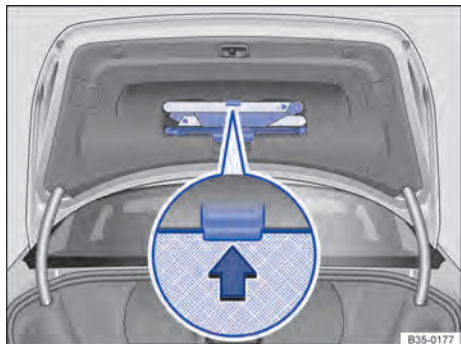
Fig. 219 Na tampa do compartimento de bagagem: suporte para o triângulo de segurança.
