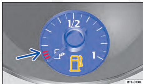
Fig. 193 No instrumento combinado: indicador do nível de combustível para gasolina e óleo diesel.
