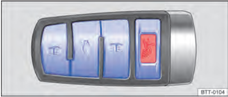
Fig. 27 Chave do veículo com botão do alarme.
