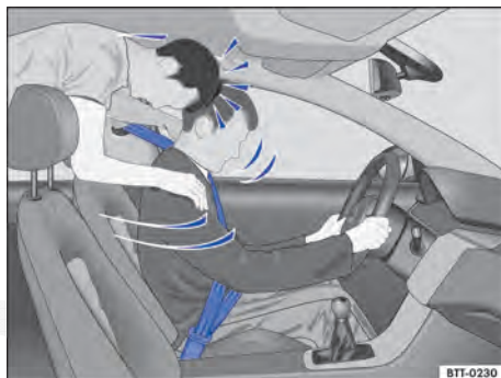
Fig. 65 O passageiro sem cinto de segurança no banco traseiro é lançado para frente sobre o condutor com cinto de segurança.
