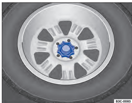
Fig. 214 No compartimento de bagagem: manípulo para fixação da roda sobressalente.
