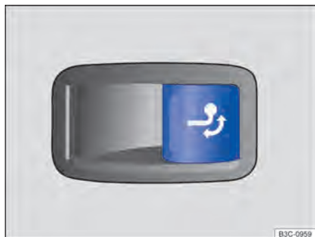
Fig. 114 No compartimento de bagagem, à direita: botão para destravamento da rótula de engate.
