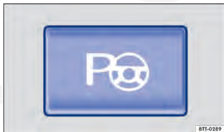
Fig. 164 Na parte inferior do console central: botão para ligar o assistente de direção para estacionamento.
