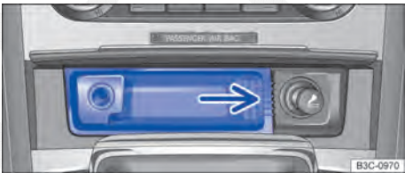
Fig. 131 No console central dianteiro: remover o cinzeiro.
