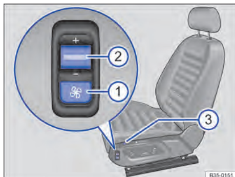
Fig. 55 No banco dianteiro: interruptor da ventilação do banco
