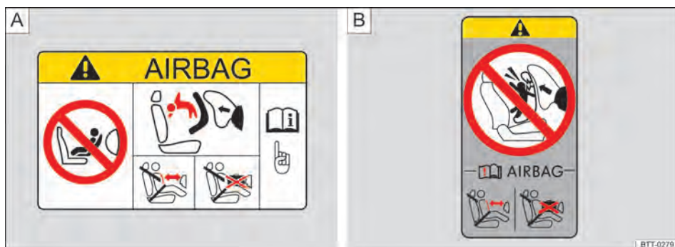
Fig. 78 Representação esquemática: etiqueta do airbag no para-sol (A) ou na coluna B (B).
