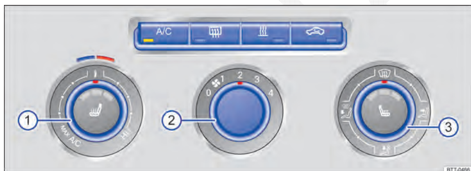
Fig. 188 No console central: comandos do ar-condicionado (manual).
