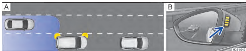
Fig. 182 Representação esquemática: A: situação de condução ao ultrapassar com o trânsito traseiro. B: indicador do assistente de mudança de faixa no espelho retrovisor externo esquerdo.
