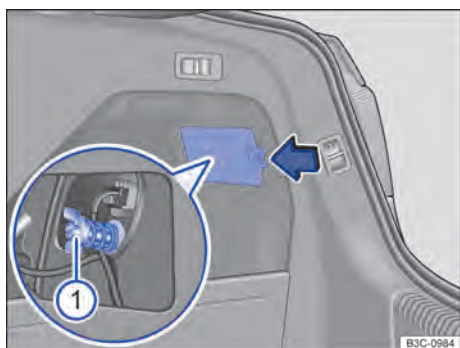
Fig. 257 Na carroceria: desinstalar as lanternas traseiras.
