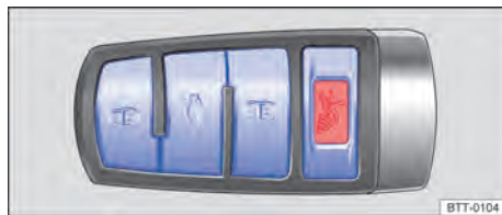
Fig. 21 Chave do veículo com botão do alarme.
