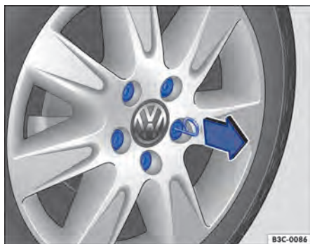
Fig. 234 Remover as capas de cobertura dos parafusos de roda.
