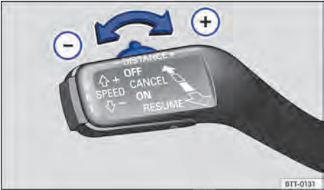
Fig. 175 Alavanca de operação ACC à esquerda na coluna de direção: ajustar o nível de distância.
