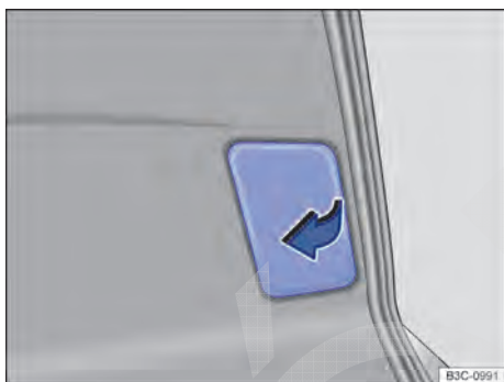
Fig. 253 Na tampa do compartimento de bagagem: remover a cobertura.
