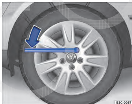
Fig. 233 Troca de roda: Afrouxar os parafusos de roda.
