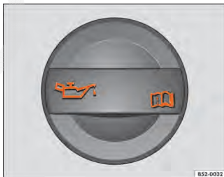
Fig. 201 No compartimento do motor: tampa da abertura de enchimento de óleo do motor.
