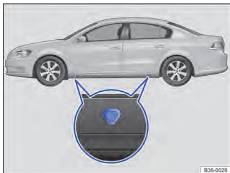
Fig. 235 Pontos de apoio do macaco.
