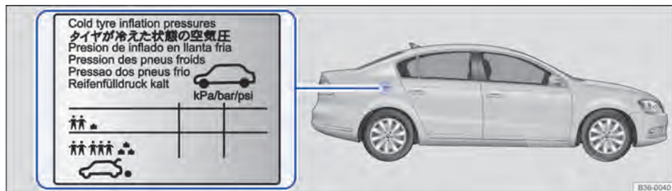
Fig. 210 Na parte interna da portinhola do tanque: etiqueta com a pressão dos pneus.
