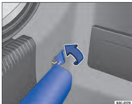
Fig. 112 No compartimento de bagagem: ponto de fixação para o pano de proteção do para-choque traseiro.
