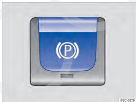
Fig. 151 Na parte inferior do console central: botão do freio de estacionamento eletrônico.
