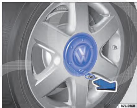
Fig. 229 Retirar a calota central.
