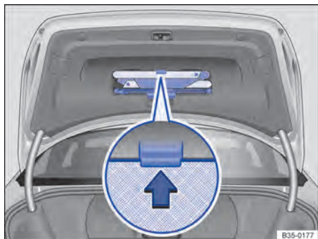
Fig. 217 Na tampa do compartimento de bagagem: suporte para o triângulo de segurança.
