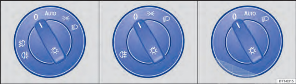
Fig. 90 Ao lado do volante: interruptor das luzes (representação de algumas variantes).
