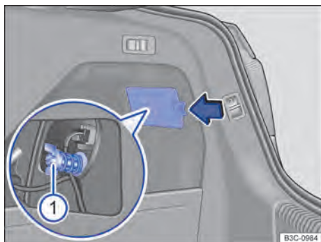
Fig. 255 Na carroceria: desinstalar a lanternas traseiras.
