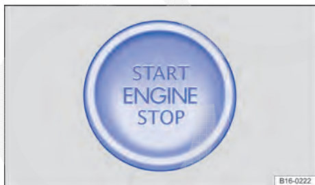
Fig. 141 Na parte inferior do console central: botão de partida do sistema de travamento e de partida Keyless Access sem chave.
