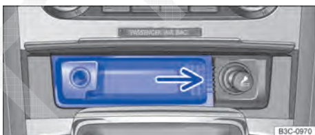
Fig. 132 No console central dianteiro: remover o cinzeiro.
