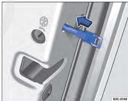
Fig. 220 Na parte dianteira da porta traseira direita: travamento de emergência do veículo com a chave de emergência.
