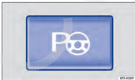
Fig. 166 Na parte inferior do console central: botão para ligar o assistente de direção para estacionamento.
