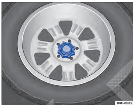
Fig. 212 No compartimento de bagagem: manipule para fixação da roda sobressalente.
