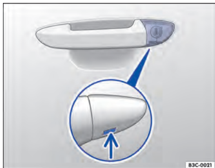
Fig. 218 Maçaneta da porta do condutor: cilindro da fechadura coberto.
