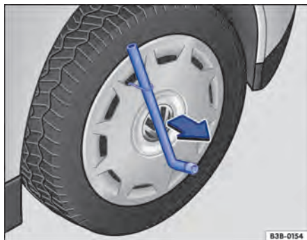
Fig. 231 Retirar a calota integral.
