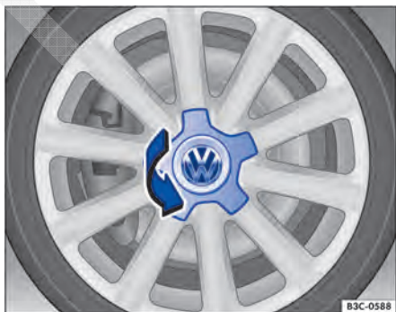
Fig. 230 Virar a calota central.
