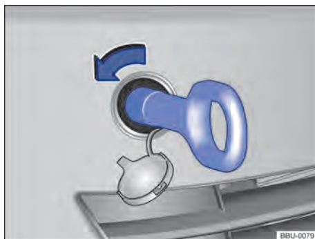
Fig. 160 No para-choque dianteiro à direita: rosquear a argola de reboque.
