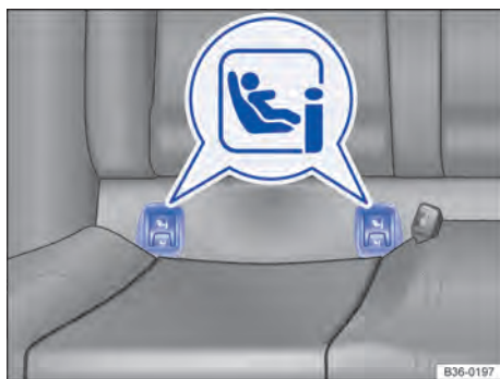
Fig. 45 Identificação dos pontos de ancoragem do i-Size para cadeiras de criança.
