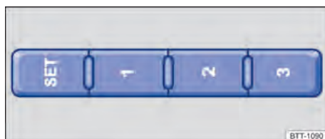
Fig. 81 Parte externa do banco do condutor: botões de memória.
