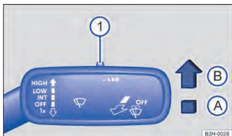
Fig. 89 À direita da coluna de direção: alavanca dos limpadores dos vidros.
