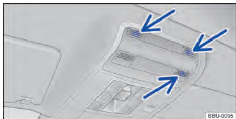
Fig. 64 No console do teto: sensores do monitoramento do interior do veículo (setas).
