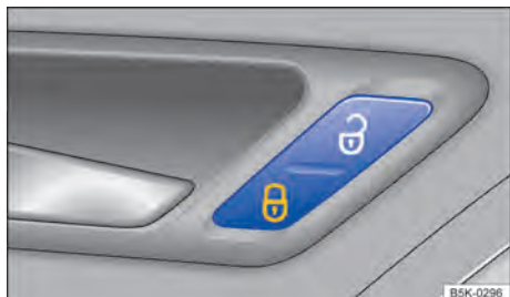
Fig. 59 Na porta do condutor: botão do travamento central.
