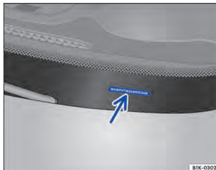
Fig. 197 No para-brisa: número de identificação do veículo.
