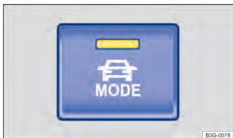
Fig. 111 No console central: botão MODE na seleção do perfil de condução.
