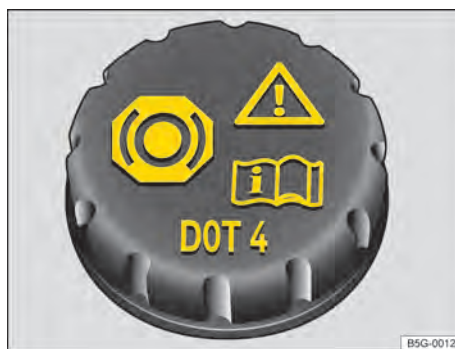
Fig. 169 No compartimento do motor: tampa do reservatório do fluido de freio.
