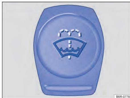
Fig. 164 No compartimento do motor: tampa do reservatório de água dos lavadores do para-brisa.
