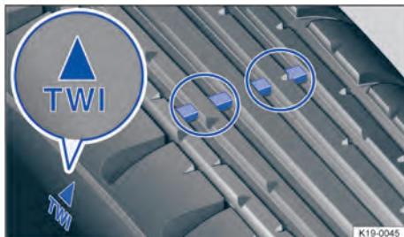
Fig. 175 Perfil do pneu: indicador de desgaste.
