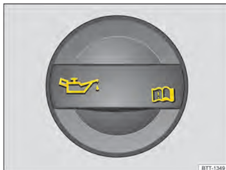
Fig. 166 No compartimento do motor: tampa da abertura para enchimento de óleo do motor (representação esquemática).
