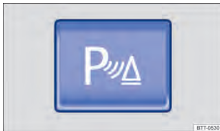
Fig. 127 No console central: botão para ligar ou desligar o auxílio de estacionamento.
