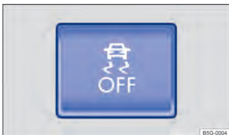
Fig. 131 No console central: botão para desligar e ligar manualmente o ASR, e o ESC Sport (dependendo da versão).
