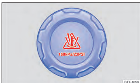
Fig. 168 No compartimento do motor: tampa do reservatório de expansão do líquido de arrefecimento (representação esquemática).
