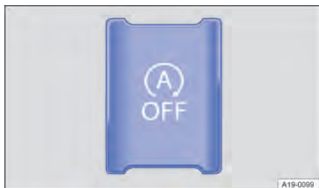
Fig. 104 Na parte inferior do console central: botão do sistema Start-Stop.
