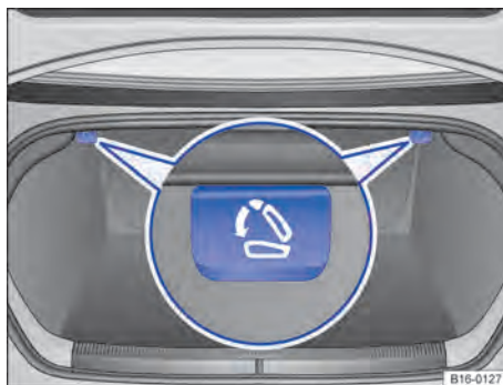
Fig. 75 No compartimento de bagagem: alavanca de destravamento.
