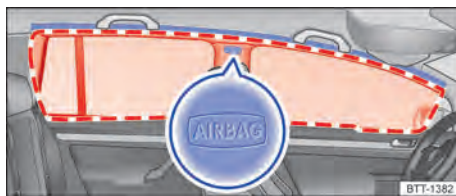
Fig. 40 No lado esquerdo do veículo: local de instalação e área de expansão do airbag para cabeça.
