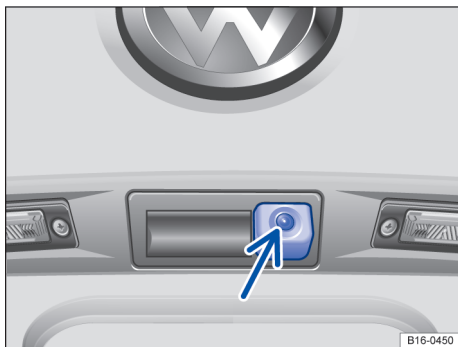
Fig. 198 Na parte traseira do veículo: câmera do assistente de marcha à ré na luz da placa de licença (representação esquemática).
