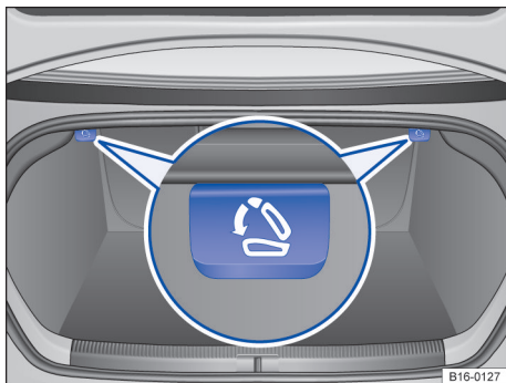
Fig. 79 No compartimento de bagagem: alavanca de destravamento para o encosto do banco traseiro.
