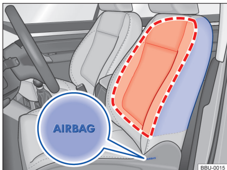
Fig. 43 Lateralmente no banco dianteiro: local de montagem e área de expansão dos airbags laterais.
