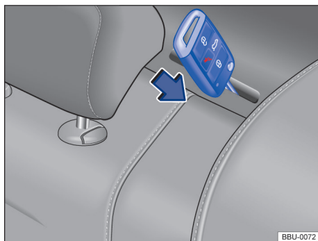
Fig. 71 Atrás do encosto do banco traseiro: destravamento de emergência do encosto do assento traseiro.
