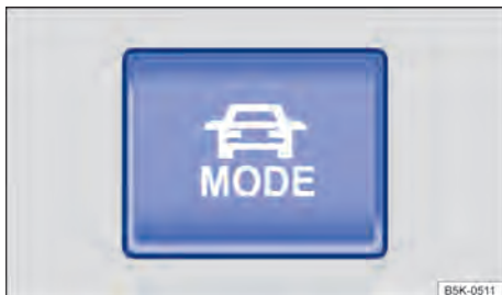
Fig. 94 Na parte superior do console central: botão MODE de seleção do perfil de condução.
