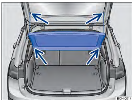
Fig. 137 No compartimento de bagagem: remover e instalar a cobertura do compartimento de bagagem.
