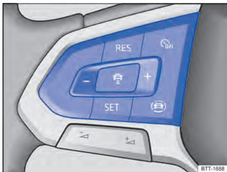
Fig. 102 Lado esquerdo do volante multifunções: botões para comandar o ACC. (variante 1)
