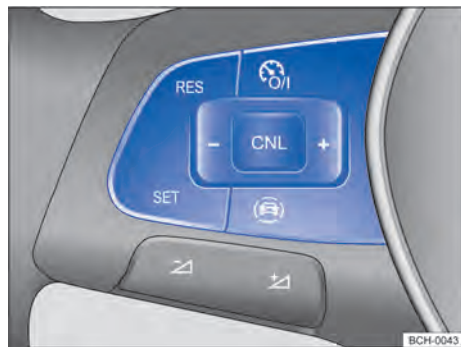
Fig. 95 Lado esquerdo do volante multifunções (variante 1): botões para comandar o GRA
