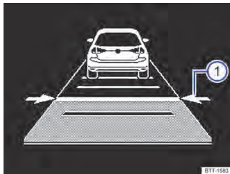
Fig. 104 No display do instrumento combinado: ajustar a distância (representação esquemática, o ACC regula).
