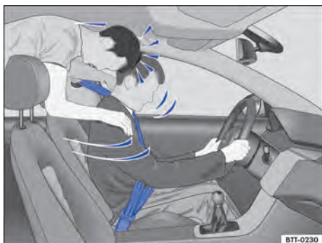
Fig. 24 O passageiro sem cinto de segurança no banco traseiro é lançado para frente sobre o condutor com cinto de segurança.
