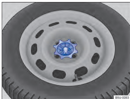
Fig. 172 No compartimento de bagagem: manipulador para fixação da roda de emergência.
