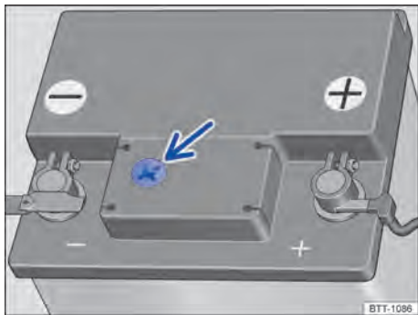
Fig. 167 No compartimento do motor: exemplo de posição do visor no lado superior da bateria do veículo.
