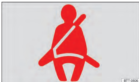
Fig. 19 Luz de advertência no display do instrumento combinado.
