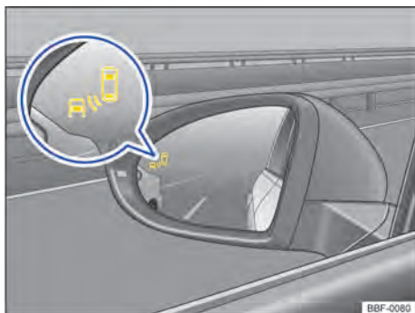
Fig. 108 Nos vidros dos espelhos retrovisores externos: indicador do sensor de “ponto cego”.
