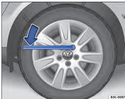
Fig. 174 Troca de roda: soltar os parafusos da roda.
