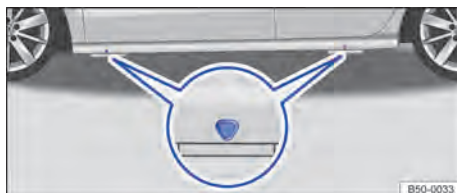
Fig. 175 Pontos de apoio do macaco.
