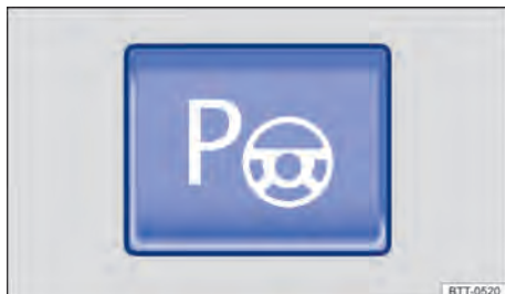
Fig. 113 No console central: botão para ligar o assistente de direção para estacionamento.
