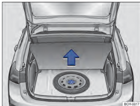
Fig. 141 No compartimento de bagagem, sob o revestimento de assoalho: roda de emergência e ferramentas de bordo.
