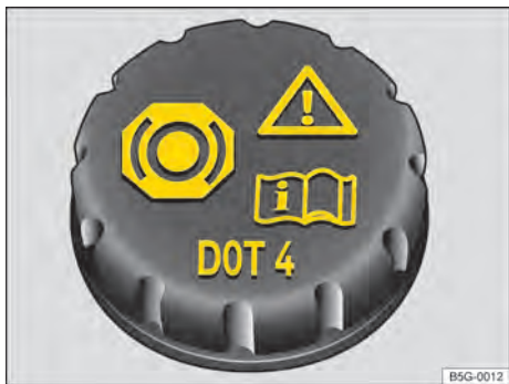
Fig. 166 No compartimento do motor: tampa do reservatório de fluido de freio.
