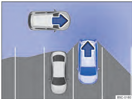
Fig. 117 Área monitorada ao redor do veículo que irá sair da vaga de estacionamento (representação esquemática).
