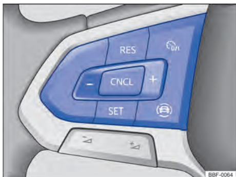
Fig. 96 Lado esquerdo do volante multifunções (variante 2): botões para comandar o GRA.
