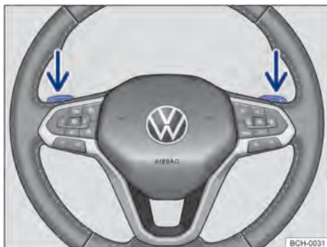
Fig. 92 Volante com seletores basculantes do Tiptronic.
