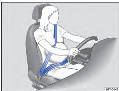
Fig. 29 Posição correta do cadarço do cinto de segurança para mulheres grávidas.
