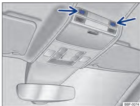
Fig. 57 No console do teto: sensores de monitoramento do interior do veículo (setas).
