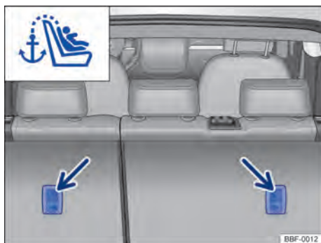
Fig. 41 Olhais de retenção para o cinto de fixação superior no lado de trás do banco traseiro.
