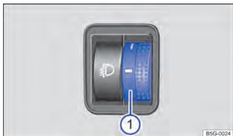
Fig. 73 Ao lado do volante: regulador do alcance do farol ①
