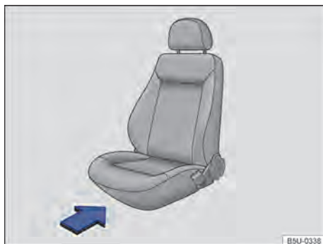
Fig. 44 Na parte frontal do banco do passageiro dianteiro: localização para instalação do suporte do extintor de incêndio.
