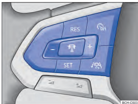
Fig. 103 Lado esquerdo do volante multifunções: botões para comandar o ACC. (variante 2)
