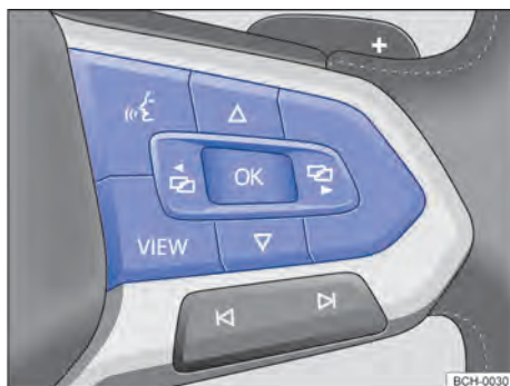
Fig. 16 Lado direito do volante multifunções (variante 2): botões para comando dos menus e exibições de informação do instrumento combinado.
