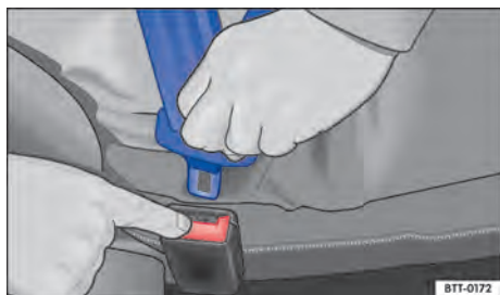
Fig. 27 Soltar a lingueta do cinto de segurança do fecho do cinto de segurança.
