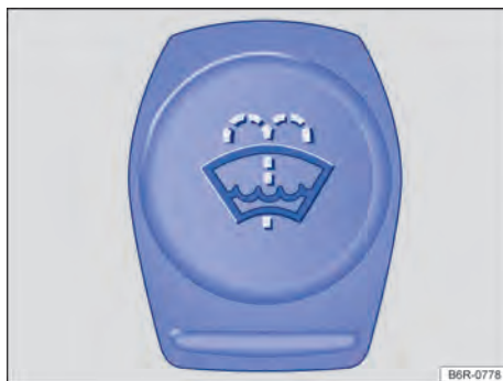
Fig. 161 No compartimento do motor: tampa do reservatório de água dos lavadores dos vidros.
