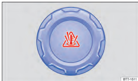
Fig. 165 No compartimento do motor: tampa do reservatório de expansão do líquido de arrefecimento do motor.
