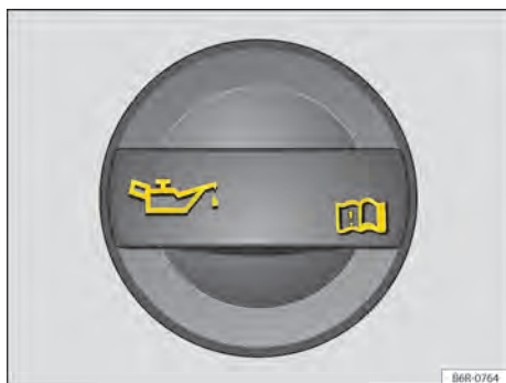
Fig. 163 No compartimento do motor: tampa da abertura para enchimento de óleo do motor.
