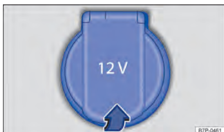
Fig. 125 No console central dianteiro: tomada 12 V.
