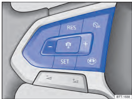
Fig. 103 Lado esquerdo do volante multifunções: botões para comandar o ACC (variante 1).
