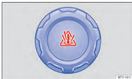
Fig. 193 No compartimento do motor: tampa do reservatório de expansão do líquido de arrefecimento do motor.
