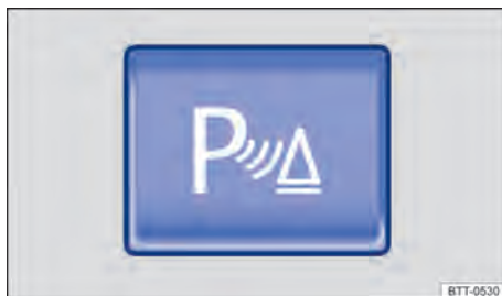
Fig. 111 No console central ou no display do rádio: botão para ligar e desligar o auxílio de estacionamento (dependendo da versão do veículo).
