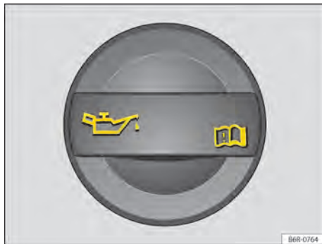
Fig. 191 No compartimento do motor: tampa da abertura para enchimento de óleo do motor.
