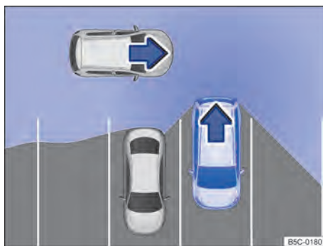
Fig. 117 Área monitorada ao redor do veículo que irá sair da vaga de estacionamento (representação esquemática).
