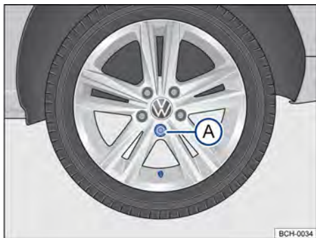
Fig. 206 Troca de roda: sequência de remoção dos parafusos da roda.
