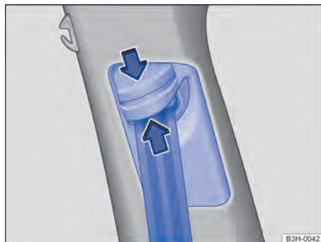
Fig. 31 Ao lado dos bancos dianteiros: regulagem de altura do cinto de segurança.
