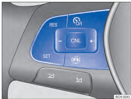
Fig. 98 Lado esquerdo do volante multifunções (variante 1): botões para comandar o limitador de velocidade.
