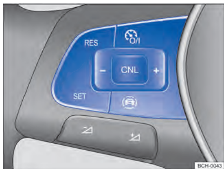
Fig. 96 Lado esquerdo do volante multifunções (variante 1): botões para comandar o GRA
