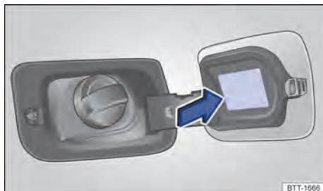
Fig. 199 Na parte interna da portinhola do tanque de combustível: etiqueta com a pressão dos pneus.
