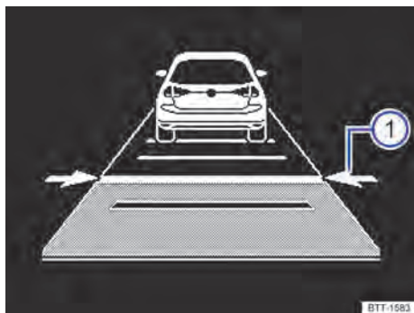
Fig. 105 No display do instrumento combinado: ajustar a distância (representação esquemática, o ACC regula).
