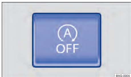
Fig. 90 Na parte superior do console central: botão do sistema Start-Stop.
