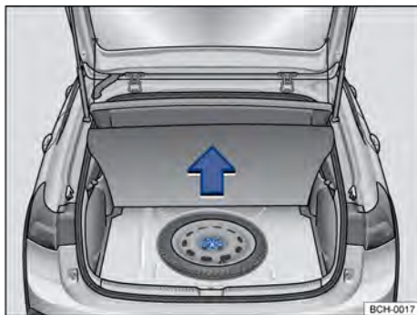
Fig. 169 No compartimento de bagagem, sob o revestimento de assoalho: roda de emergência e ferramentas de bordo.
