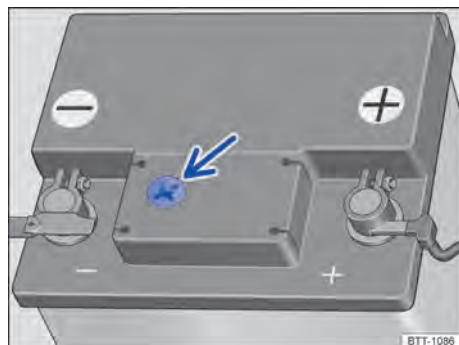
Fig. 195 No compartimento do motor: exemplo de posição do visor no lado superior da bateria do veículo.
