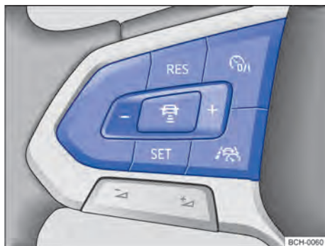
Fig. 104 Lado esquerdo do volante multifunções: botões para comandar o ACC (variante 2).
