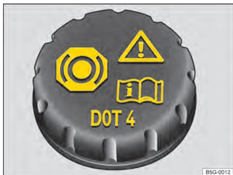
Fig. 194 No compartimento do motor: tampa do reservatório de fluido de freio.
