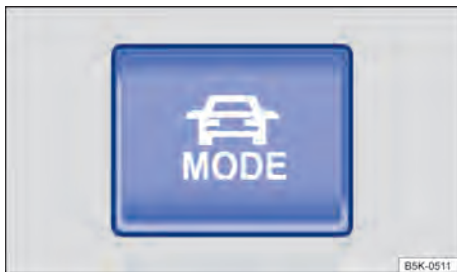
Fig. 95 Na parte superior do console central: botão MODE de seleção do perfil de condução.
