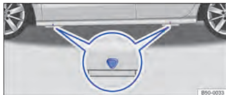
Fig. 204 Pontos de apoio do macaco.
