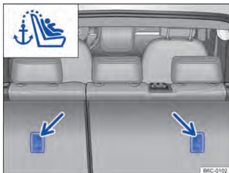
Fig. 42 Olhais de retenção para o cinto de fixação superior no lado de trás do banco traseiro.
