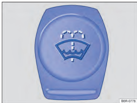
Fig. 189 No compartimento do motor: tampa do reservatório de água dos lavadores dos vidros.
