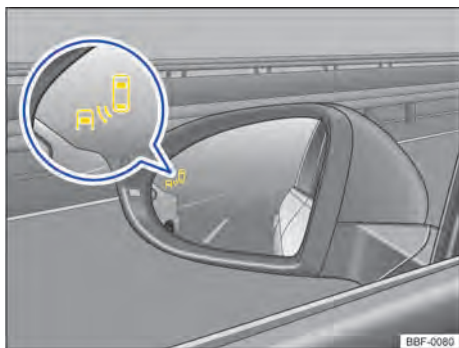
Fig. 109 Nos espelhos retrovisores externos: indicador do sensor de ponto cego.
