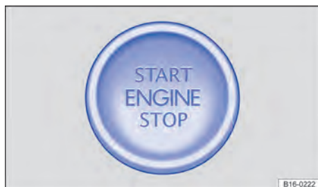
Fig. 88 Na parte inferior do console central: botão de partida para ligar o motor.
