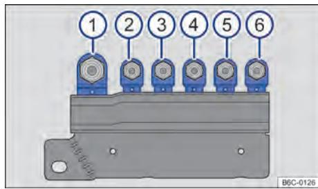
Fig. 173 No compartimento do motor em cima da bateria: disposição dos fusíveis.
