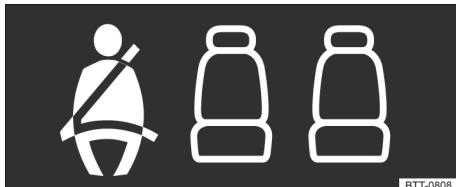
Fig. 21 Indicador de status do cinto de segurança para os assentos traseiros no display do instrumento combinado.
