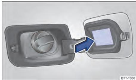
Fig. 191 Na parte interna da portinhola do tanque de combustível: etiqueta com a pressão dos pneus.
