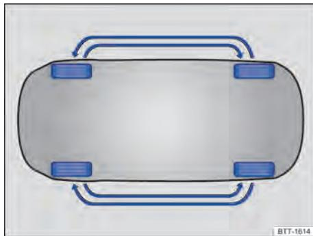
Fig. 189 Esquema para a troca das rodas.
