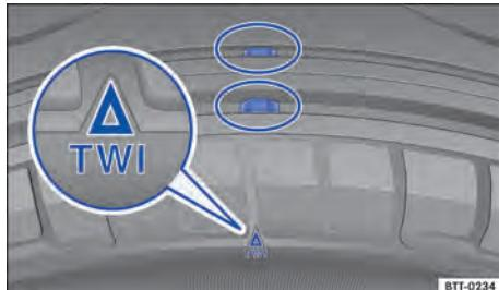
Fig. 192 Perfil do pneu: indicadores de desgaste.
