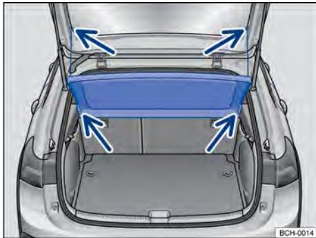
Fig. 155 No compartimento de bagagem: remover e instalar a cobertura do compartimento de bagagem.
