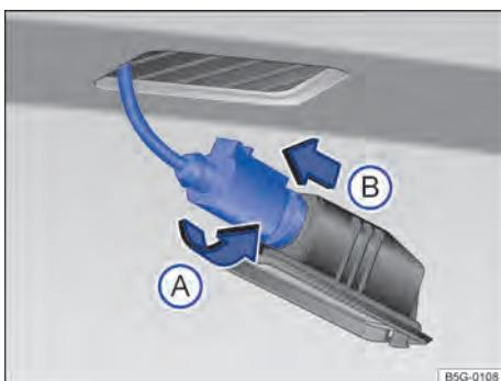
Fig. 168 Lanterna da placa de licença: desinstalar o suporte da lâmpada.
