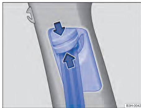
Fig. 31 Ao lado dos bancos dianteiros: regulagem de altura do cinto de segurança.
