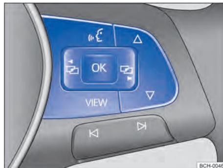
**Fig. 16** Lado direito do volante multifunções (versão 1): botões para comando dos menus e exibições de informação do instrumento combinado.
