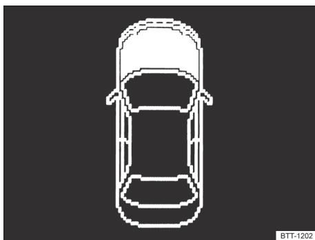
**Fig. 180** No display do instrumento combinado: tampa do compartimento do motor aberta ou fechada incorretamente (representação esquemática).
