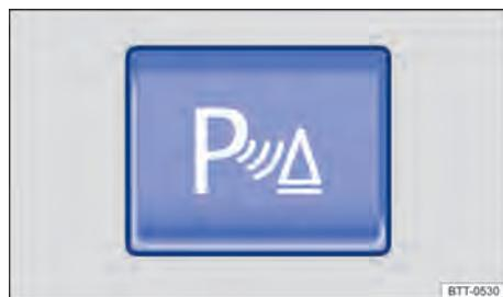
**Fig. 105** No rádio: ligar e desligar o auxílio de estacionamento.
