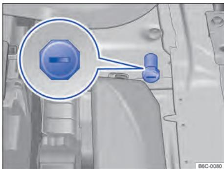
**Fig. 176** No compartimento do motor: ponto de auxílio à partida (ponto de aterramento).
