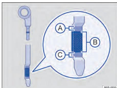
Fig. 182 Vareta de medição do óleo com marcas de nível do óleo do motor.
