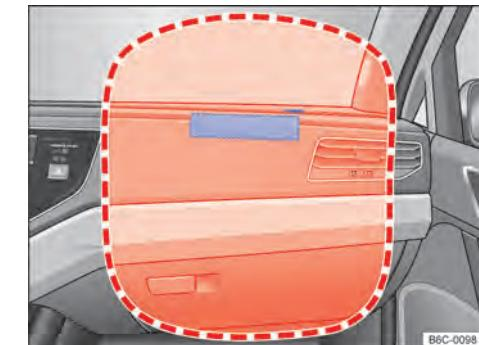
**Fig. 34** Local de instalação e área de expansão do airbag frontal do passageiro dianteiro.
