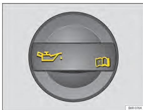
Fig. 183 No compartimento do motor: tampa da abertura para enchimento de óleo do motor.
