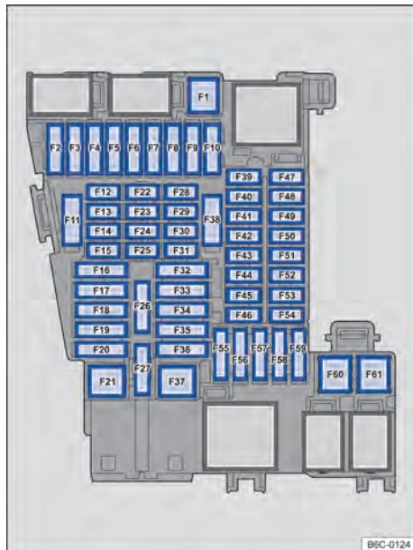
Fig. 170 No painel de instrumentos: disposição dos fusíveis.
