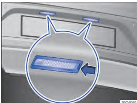
Fig. 167 No para-choque traseiro: lanterna da placa de licença.
