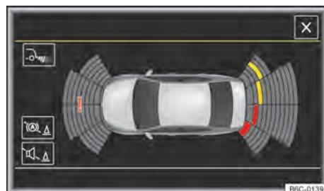
**Fig. 106** Indicação no sistema do rádio: modo de tela cheia. As áreas registradas dependem da versão do veículo.
