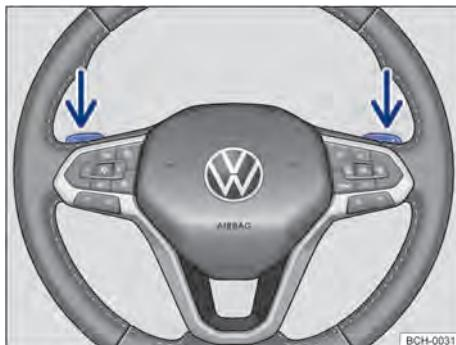
Fig. 93 Volante com seletores basculantes do Tiptronic.
