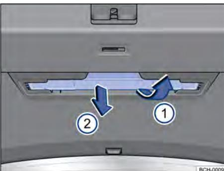
Fig. 46 Na tampa traseira: suporte para o triângulo de segurança.
