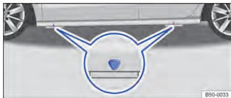
Fig. 196 Pontos de apoio do macaco.
