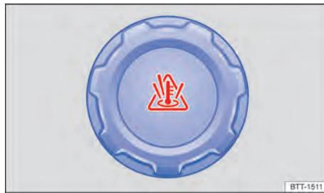
Fig. 185 No compartimento do motor: tampa do reservatório de expansão do líquido de arrefecimento do motor.
