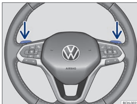
Fig. 91 Volante com seletores basculantes do Tiptronic.
