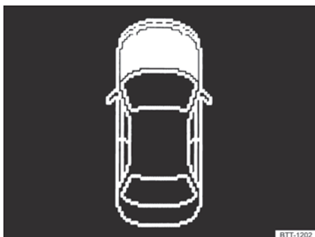
Fig. 179 No display do instrumento combinado: tampa do compartimento do motor aberta ou fechada incorretamente (representação esquemática).
