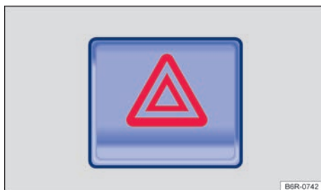
Fig. 45 Na parte superior do console central: interruptor das luzes de advertência.
