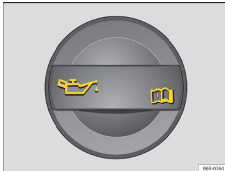
Fig. 182 No compartimento do motor: tampa da abertura para enchimento de óleo do motor.
