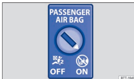
Fig. 35 No painel de instrumentos no lado do passageiro dianteiro: interruptor acionado pela chave para desligar e ligar o airbag frontal do passageiro dianteiro.
