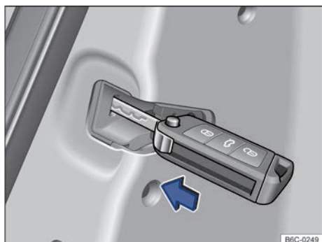
Fig. 56 Nas portas, dianteira direita e traseiras: travamento de emergência do veículo com a haste metálica da chave (variante 2).
