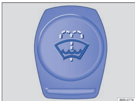
Fig. 180 No compartimento do motor: tampa do reservatório de água dos lavadores dos vidros.
