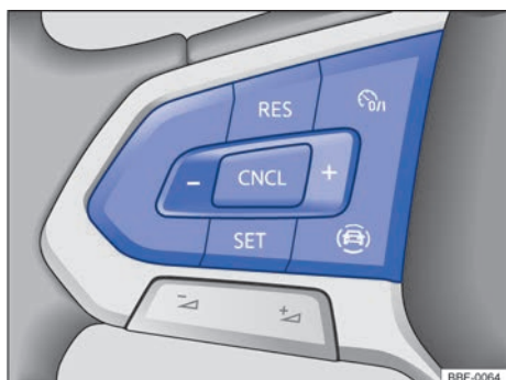
Fig. 94 Lado esquerdo do volante multifunções (variante 2): botões para comandar o GRA
