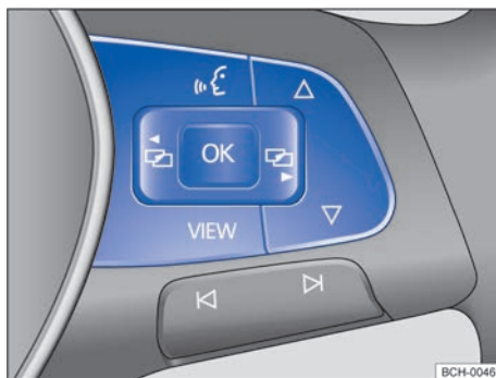
Fig. 16 Lado direito do volante multifunções (variante 1): botões para comando dos menus e exibições de informação do instrumento combinado.
