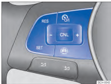
Fig. 92 Lado esquerdo do volante multifunções (variante 1): botões para comandar o GRA
