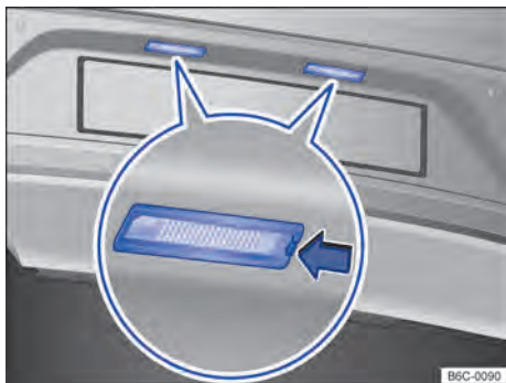
Fig. 165 No para-choque traseiro: lanterna da placa de licença.
