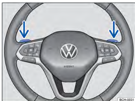
Fig. 90 Volante com seletores basculantes do Tiptronic.
