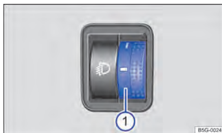
Fig. 72 Ao lado do volante: regulador do alcance do farol ①
