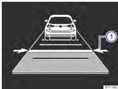
Fig. 100 No display do instrumento combinado: ajustar a distância (representação esquemática, o ACC regula).
