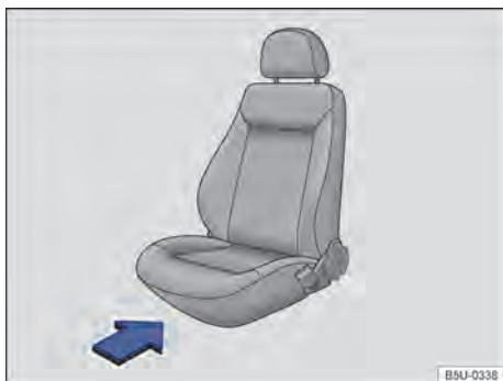
Fig. 47 Na parte frontal do banco do passageiro dianteiro: localização para instalação do suporte do extintor de incêndio.
