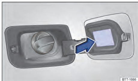
Fig. 188 Na parte interna da portinhola do tanque de combustível: etiqueta com a pressão dos pneus.
