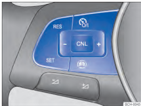
Fig. 94 Lado esquerdo do volante multifunções (variante 1): botões para comandar o limitador de velocidade.
