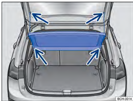
Fig. 153 No compartimento de bagagem: remover e instalar a cobertura do compartimento de bagagem.
