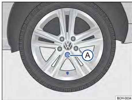
Fig. 195 Troca de roda: sequência de remoção dos parafusos da roda.
