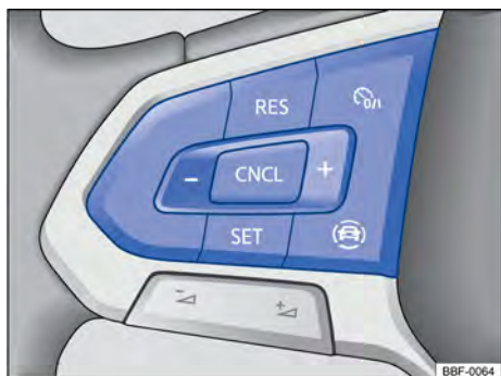
Fig. 93 Lado esquerdo do volante multifunções (variante 2): botões para comandar o GRA.
