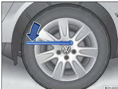
Fig. 192 Troca de roda: soltar os parafusos da roda.
