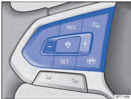
Fig. 99 Lado esquerdo do volante multifunções: botões para comandar o ACC.
