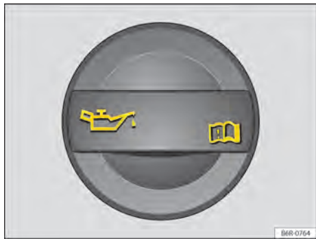
Fig. 180 No compartimento do motor: tampa da abertura para enchimento de óleo do motor.
