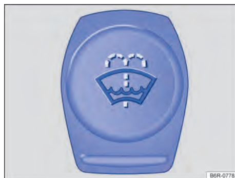
Fig. 178 No compartimento do motor: tampa do reservatório de água dos lavadores dos vidros.
