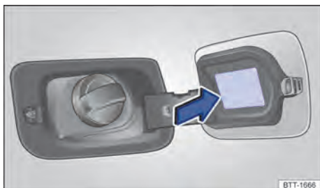
Fig. 190 Na parte interna da portinhola do tanque de combustível: etiqueta com a pressão dos pneus.
