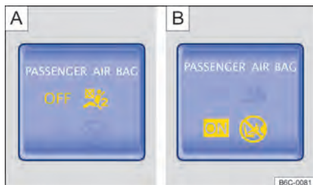
Fig. 32 Na parte superior do console central: luz de controle para o airbag frontal do passageiro dianteiro desligado [A] ou luz de controle para o airbag frontal do passageiro dianteiro ligado [B]. ▶
