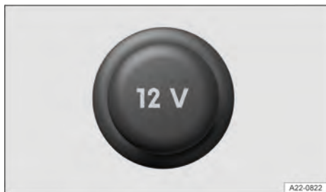
Fig. 136 Na parte dianteira do console central: tomada 12 V com cobertura removível (representação esquemática).
