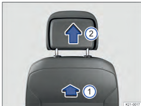
Fig. 74 Desinstalar o apoio para cabeça dianteiro (representação esquemática).
