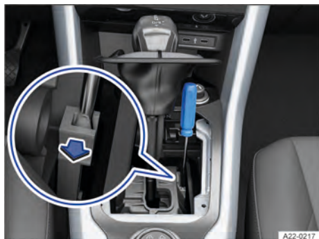
Fig. 106 No console central: destravar emergencialmente o bloqueio da alavanca seletora (variante 2).
