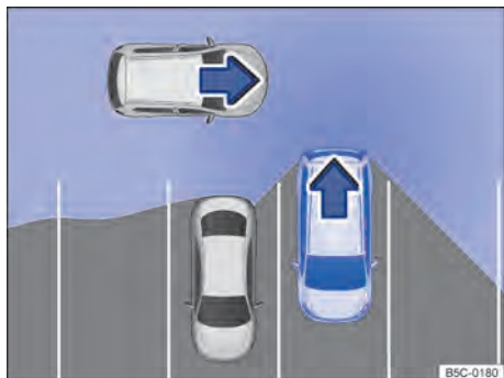
Fig. 131 Área monitorada ao redor do veículo que irá sair da vaga de estacionamento (representação esquemática).
