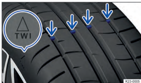
Fig. 188 Nos sulcos do perfil: indicador de desgaste.
