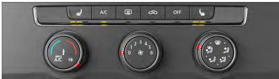
Fig. 94 Na parte superior do console central: painel de comando do ar-condicionado manual.
