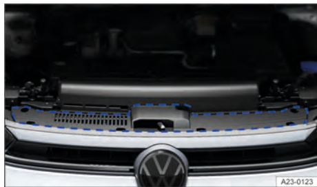
Fig. 175 Na área marcada: lugar da etiqueta adesiva da norma de óleo do motor e viscosidade do óleo do motor (representação esquemática).
