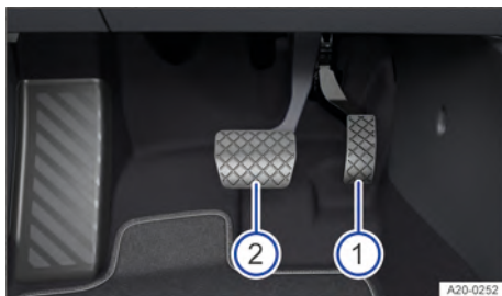
Fig. 96 Na área para os pés: pedais em veículos com transmissão automática.
