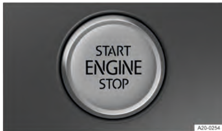
Fig. 98 Na parte inferior do console central: botão de partida.
