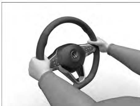
Fig. 66 No volante: posição de nove horas e três horas (representação esquemática).
