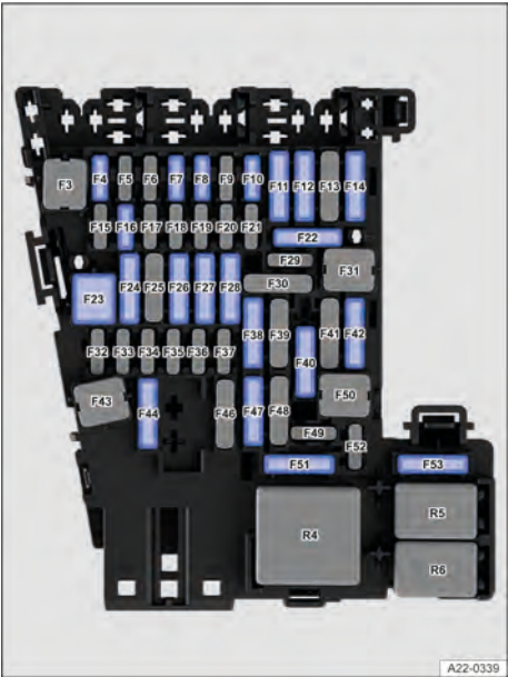
Fig. 157 No painel de instrumentos: disposição dos fusíveis.
