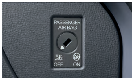
Fig. 33 No painel de instrumentos no lado do passageiro dianteiro: interruptor acionado pela chave para desligar e ligar o airbag frontal do passageiro dianteiro.
