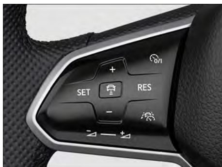
Fig. 115 Lado esquerdo do volante multifunções (variante 2).
