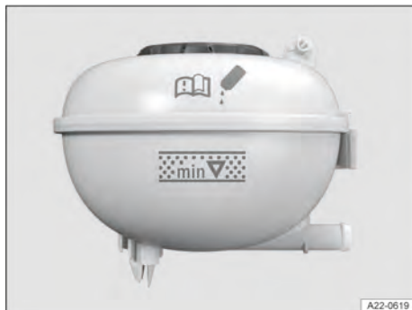
Fig. 180 No compartimento do motor: marcações no reservatório de expansão do líquido de arrefecimento (representação esquemática).
