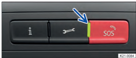
Fig. 47 No console do teto: comando de serviços de voz e luz de controle.
