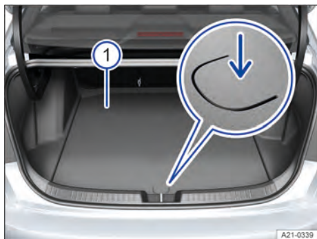
Fig. 142 No compartimento de bagagem: abrir o assoalho do compartimento de bagagem.
