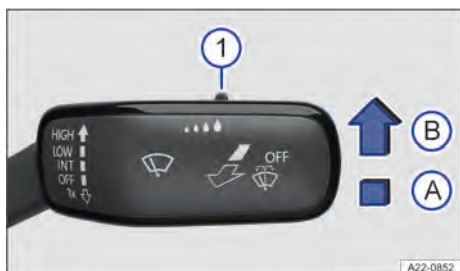
Fig. 88 À direita da coluna de direção: alavanca dos limpadores dos vidros.
