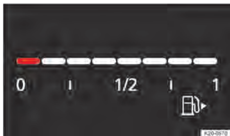
Fig. 16 No instrumento combinado digital Basic: indicador do nível de combustível (representação esquemática).
