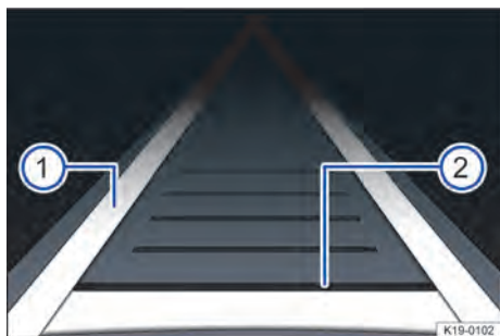
Fig. 122 No display do instrumento combinado: indicação da regulagem do controle.
