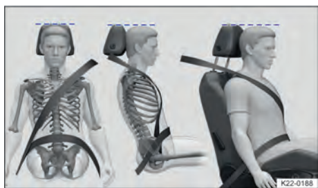
Fig. 28 Posição correta do cadarço do cinto de segurança e ajuste correto do apoio para cabeça (representação esquemática).
