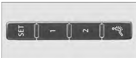
Fig. 80 Parte externa do banco do condutor: botões de memória.
