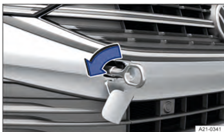
Fig. 164 No para-choque dianteiro à direita: rosquear a argola de reboque da variante 1.
