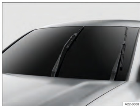
Fig. 151 Limpadores dos vidros na posição de serviço (representação esquemática).
