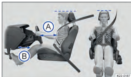
Fig. 24 Distância correta do condutor em relação ao volante, posição correta do cadarço do cinto de segurança e ajuste correto do apoio para cabeça (representação esquemática).
