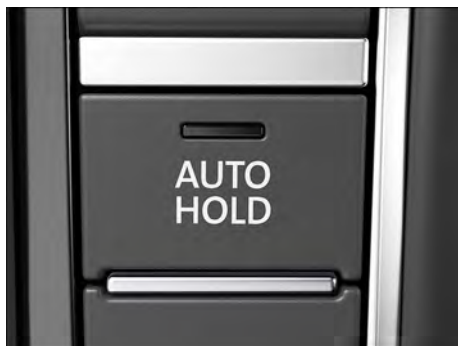
Fig. 127 No console central: botão do Auto Hold.
