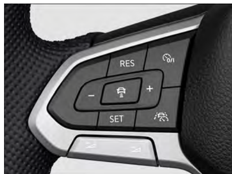
Fig. 123 Lado esquerdo do volante multifunções (variante 1).
