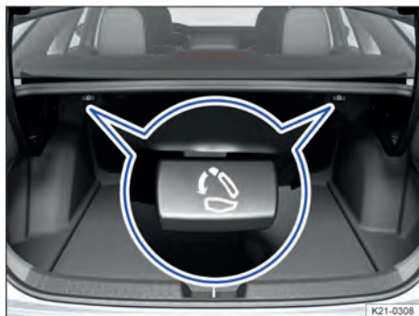
Fig. 70 No compartimento de bagagem: alavanca de destravamento.
