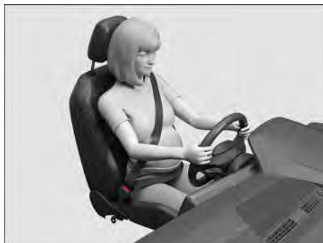
Fig. 29 Posição correta do cadarço do cinto de segurança para mulheres grávidas (representação esquemática).
