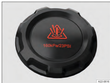
Fig. 179 No compartimento do motor: tampa do reservatório de expansão do líquido de arrefecimento (representação esquemática).
