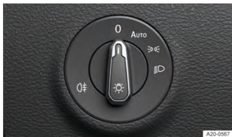
Fig. 82 Ao lado do volante: interruptor de luzes (uma variante).
