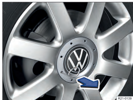
Fig. 191 Retirar a calota central.
