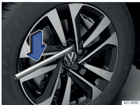
Fig. 194 Soltar os parafusos de roda.
