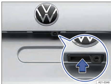
Fig. 62 Na tampa traseira: botão para abrir a tampa traseira.
