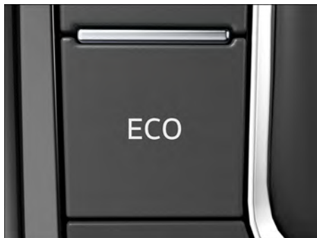
Fig. 108 No console central: botão do modo ECO.
