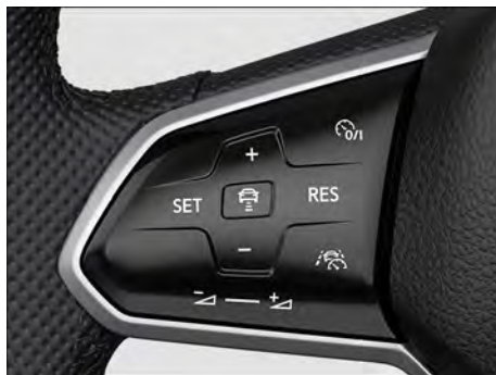
Fig. 119 Lado esquerdo do volante multifunções (variante 2).
