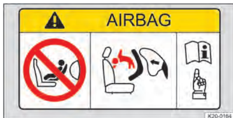
Fig. 40 No para-sol: etiqueta do airbag (representação esquemática).
