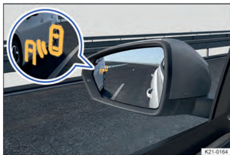
Fig. 125 Nos vidros dos espelhos retrovisores externos: indicador do sensor de “ponto cego”.
