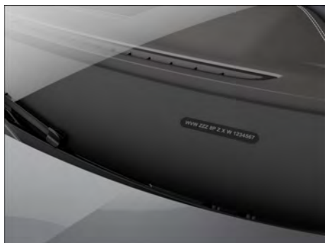
Fig. 244 No para-brisa: número de identificação do veículo.
