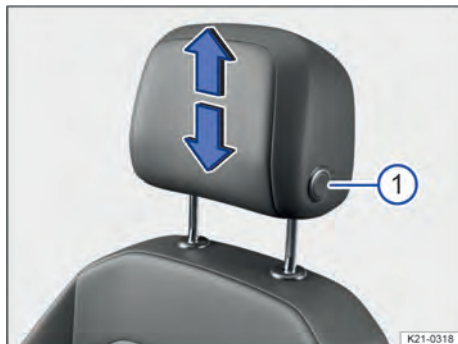
Fig. 72 Ajustar o apoio para cabeça dianteiro (representação esquemática).
