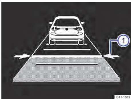
Fig. 120 No display do instrumento combinado: distância ajustada no caso de regulação (representação esquemática).
