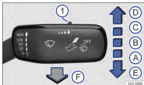
Fig. 87 À direita da coluna de direção: comandar os limpadores do para-brisa.
