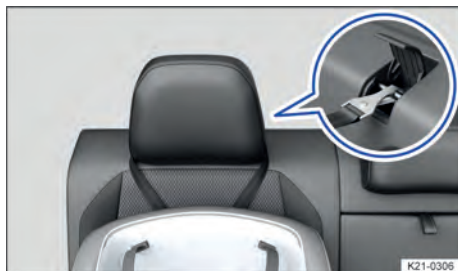
Fig. 45 No encosto do banco traseiro: posição do cinto de segurança no caso de apoios para cabeça não ajustáveis com cinto Top Tether em forma de V.
