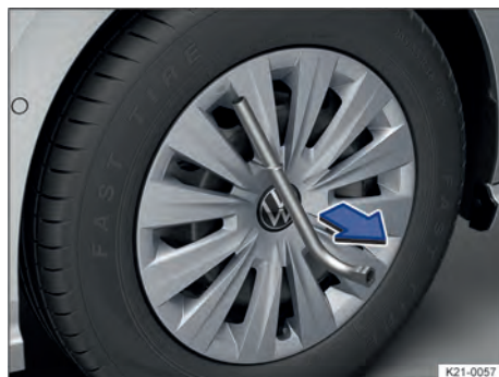
Fig. 192 Retirar a calota integral.
