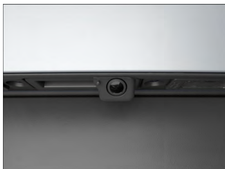
Fig. 206 Na traseira do veículo: câmera de marcha a ré no botão da alça (representação esquemática).
