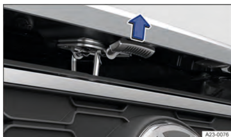
Fig. 171 Acima da grade do radiador: alavanca de comando da tampa dianteira (representação esquemática).
