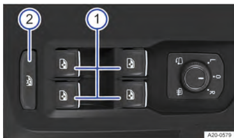
Fig. 63 Na porta do condutor: botões do acionamento do vidro.
