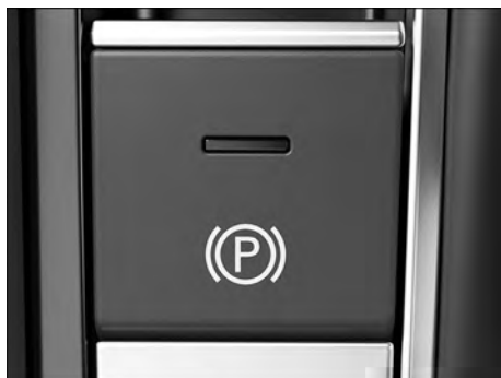
Fig. 126 No console central: botão do freio de estacionamento eletrônico.
