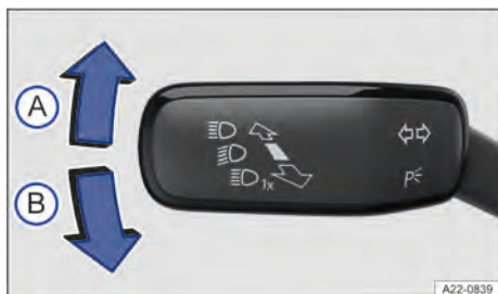
Fig. 85 À esquerda na coluna de direção: alavanca dos indicadores de direção e do farol alto.
