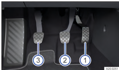
Fig. 95 Na área para os pés: pedais em veículos com transmissão manual.
