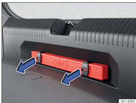
Fig. 46 Embaixo do canto do compartimento de carga: suporte para o triângulo de segurança.
