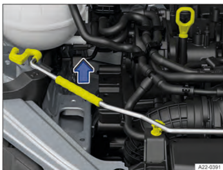
Fig. 172 No compartimento do motor: haste de sustentação da tampa no suporte.
