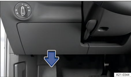
Fig. 156 À esquerda do volante: cobertura da caixa de fusíveis no painel de instrumentos.
