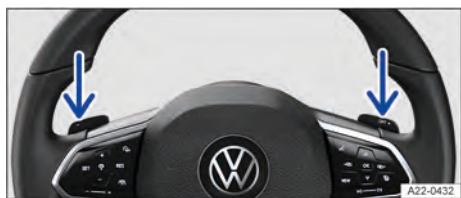
Fig. 104 Atrás do volante: seletores basculantes para o Tiptronic.
