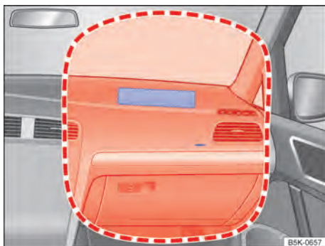
Fig. 32 No lado do passageiro dianteiro: local de instalação e área de expansão do airbag frontal do passageiro.
