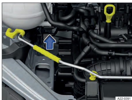
Fig. 163 No compartimento dianteiro: haste de sustentação da tampa no suporte (representação esquemática).
