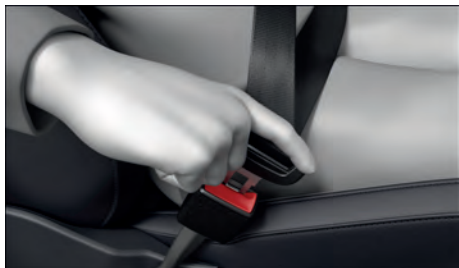
Fig. 23 Introduzir a lingueta do cinto de segurança no fecho do cinto de segurança (representação esquemática).
