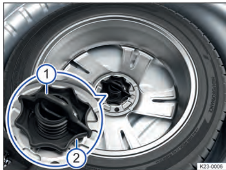
Fig. 182 Sob o assoalho do compartimento de bagagem: manípulo de fixação da roda sobressalente.
