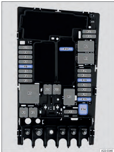
Fig. 146 No compartimento dianteiro: posições de conexão para fusíveis.
