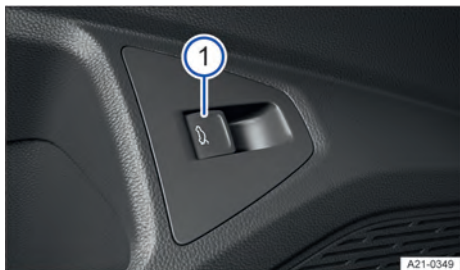
Fig. 55 Na porta do condutor: botão de destravamento da tampa traseira.
