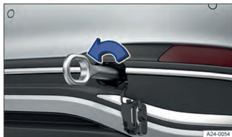
Fig. 159 No para-choque traseiro à direita: rosquear a argola de reboque.
