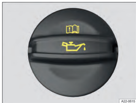
Fig. 169 No compartimento dianteiro: tampa da abertura de enchimento de óleo do motor (representação esquemática).
