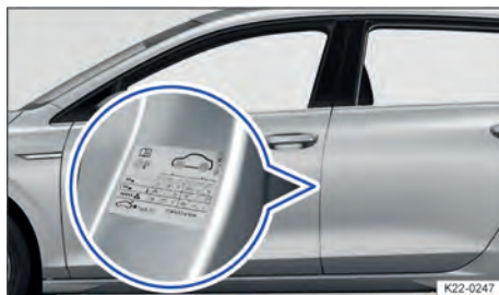
Fig. 177 Na coluna do condutor: etiqueta com as pressões dos pneus (alternativa ao lado interno da portinhola do tanque).
