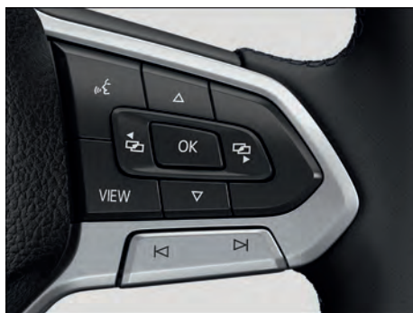
Fig. 12 Lado direito do volante multifunções: comandar o instrumento combinado digital Basic (representação esquemática).
