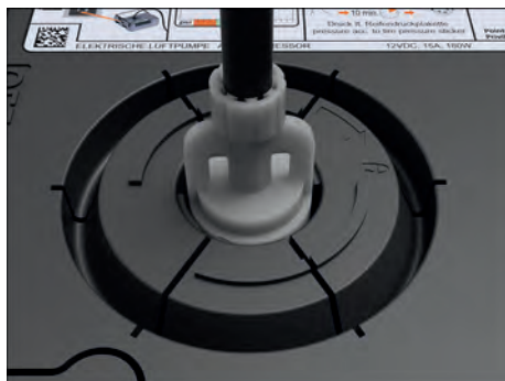
Fig. 196 Instalar a mangueira de enchimento dos pneus.
