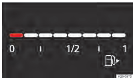
Fig. 14 No instrumento combinado digital Basic: indicador do nível de combustível (representação esquemática).
