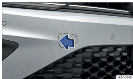
Fig. 154 No para-choque dianteiro à direita: desmontar a cobertura da variante 1.
