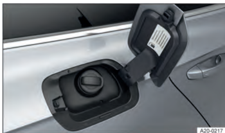
Fig. 138 Atrás da portinhola do tanque: tampa do tanque (representação esquemática).
