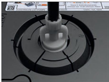
Fig. 199 Instalar a mangueira de enchimento dos pneus.
