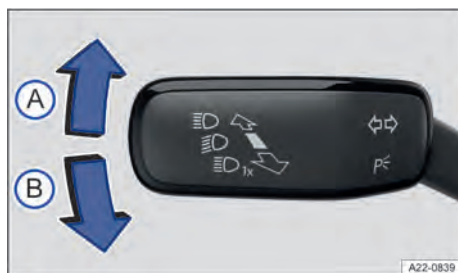
Fig. 79 À esquerda na coluna de direção: alavanca dos indicadores de direção e do farol alto.
