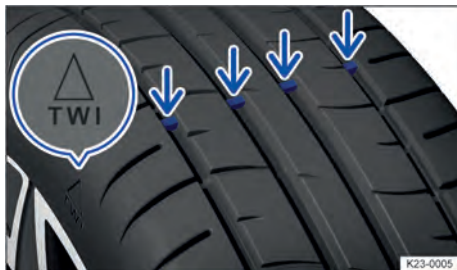
Fig. 180 Nos sulcos do perfil: indicador de desgaste.
