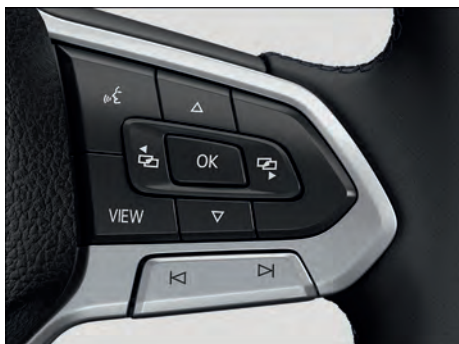
Fig. 10 Lado direito do volante multifunções: coman- dar o instrumento combinado digital Pro (representação esquemática).
