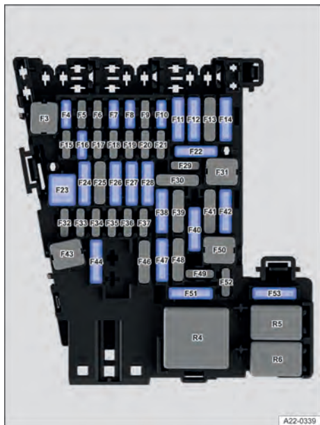
Fig. 148 No painel de instrumentos: disposição dos fusíveis.
