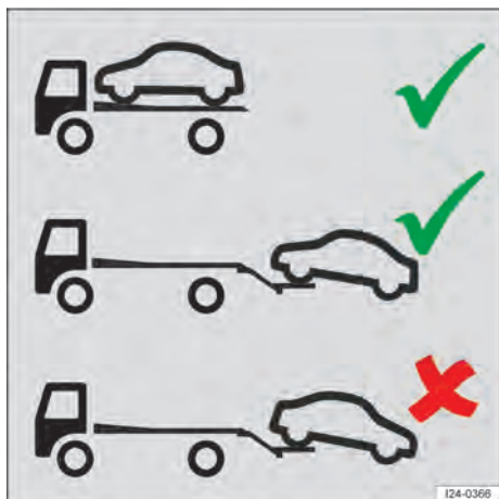
Fig. 153 Remoção com um veículo rebocador.
