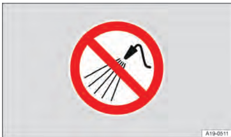
Fig. 201 No compartimento dianteiro: não usar lavador de alta pressão.
