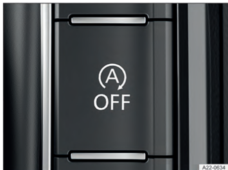
Fig. 93 Na parte inferior do console central ou, dependendo da versão, no sistema Infotainment: botão do sistema Start-Stop.
