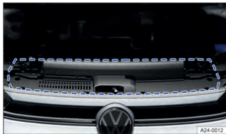
Fig. 167 Área da adesiva de óleo do motor (representação esquemática).
