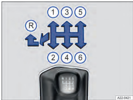
Fig. 94 Esquema de troca de marchas da transmissão manual de 6 marchas. Dependendo da versão, seu veículo pode dispor de uma transmissão manual de 5 marchas.
