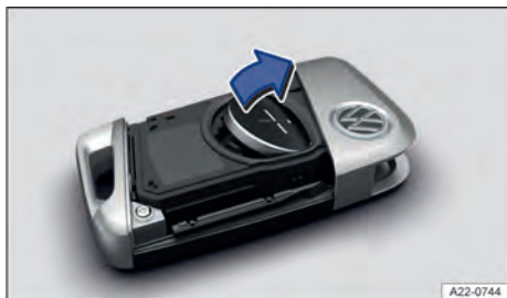
Fig. 46 Chave do veículo: trocar a pilha-botão.
