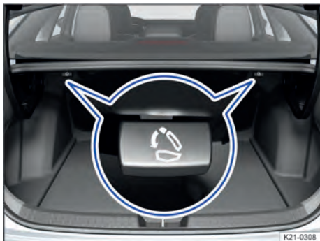
Fig. 64 No compartimento de bagagem: alavanca de destravamento.
