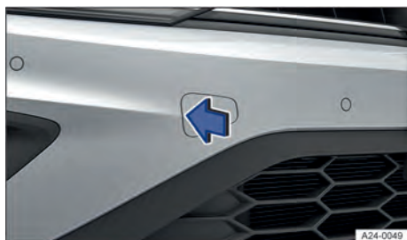
Fig. 155 No para-choque dianteiro à direita: desmontar a cobertura da variante 2.
