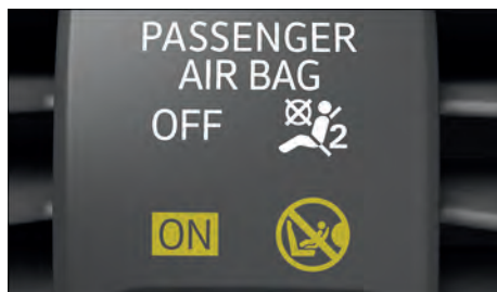
Fig. 30 No console central: luz de controle para airbag frontal do passageiro dianteiro ligado (conforme o país).
