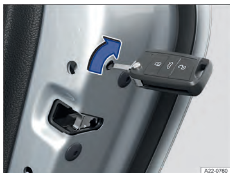
Fig. 52 Na parte dianteira da porta traseira direita: travamento de emergência do veículo com a chave do veículo (representação esquemática).
