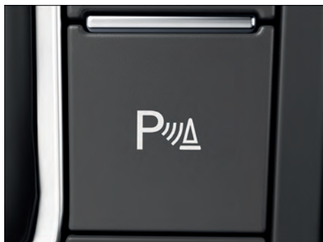
Fig. 119 No console central: botão do auxílio de estacionamento.
