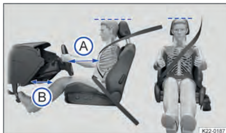
Fig. 22 Distância correta do condutor em relação ao volante, posição correta do cadarço do cinto de segurança e ajuste correto do apoio para cabeça (representação esquemática).
