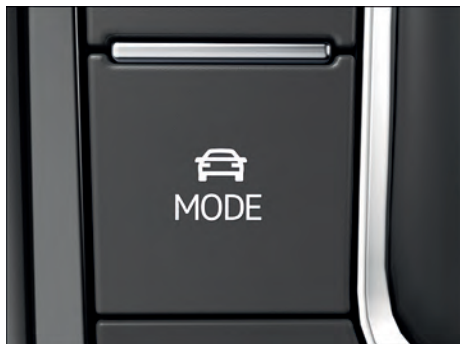
Fig. 100 No console central: botão MODE na seleção do perfil de condução.
