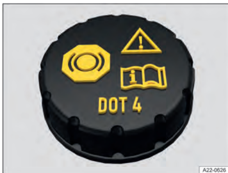
Fig. 173 No compartimento dianteiro: tampa do reservatório do fluido de freio.
