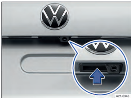
Fig. 56 Na tampa traseira: botão para abrir a tampa traseira.
