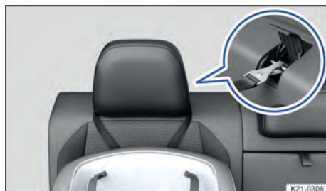
Fig. 39 No encosto do banco traseiro: posição do cinto de segurança no caso de apoios para cabeça não ajustáveis com cinto Top Tether em forma de V.
