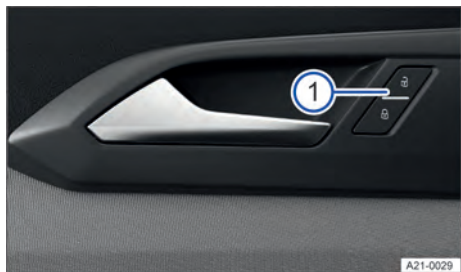
Fig. 49 Na porta do condutor: botão do travamento central (representação esquemática).
