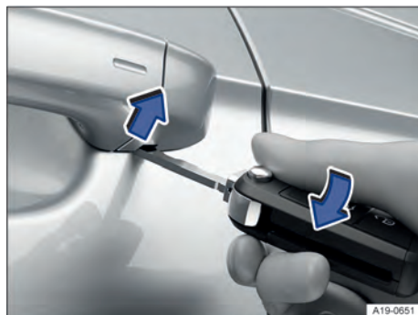
Fig. 50 Maçaneta da porta do condutor: alavancar a capa de cobertura para fora.
