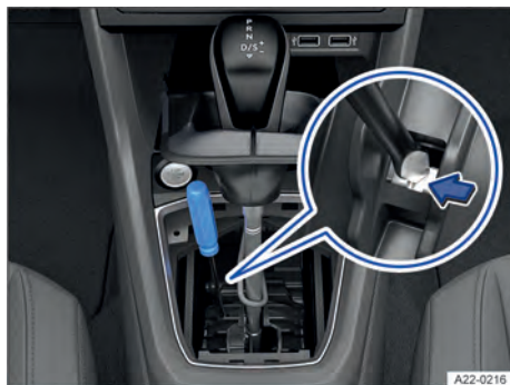
Fig. 98 No console central: destravar emergencialmente o bloqueio da alavanca seletora (variante 1).
