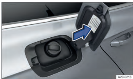
Fig. 134 No lado interno da portinhola do tanque: placa de indicação de combustível (representação esquemática).
