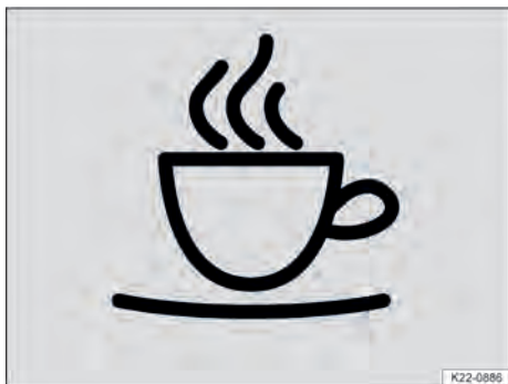
Fig. 21 No display do instrumento combinado digital: símbolo do alerta de cansaço.
