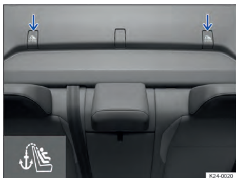
Fig. 37 No porta-objetos atrás dos bancos traseiros: pontos de ancoragem Top Tether do cinto de segurança Top Tether.
