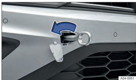
Fig. 157 No para-choque dianteiro à direita: rosquear a argola de reboque da variante 2.
