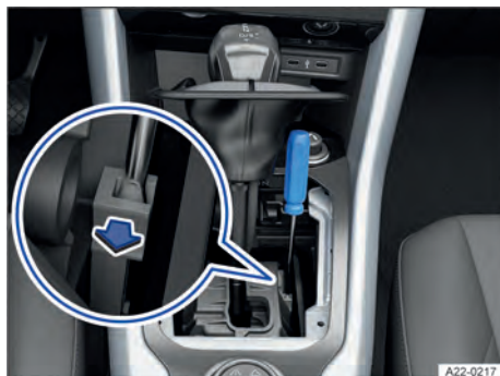
Fig. 99 No console central: destravar emergencialmente o bloqueio da alavanca seletora (variante 2).
