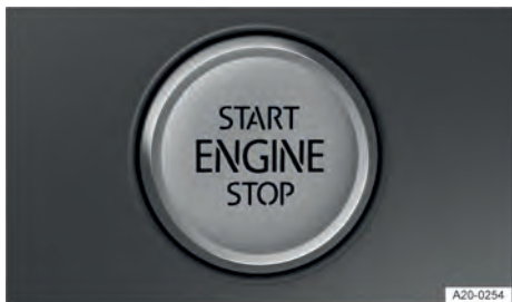
Fig. 91 Na parte inferior do console central: botão de partida.
