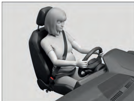
Fig. 26 Posição correta do cadarço do cinto de segurança para mulheres grávidas (representação esquemática).
