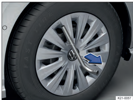
Fig. 183 Retirar a calota integral.
