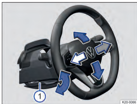
Fig. 59 Embaixo do volante no revestimento da coluna de direção: alavanca de ajuste mecânico da posição do volante (representação esquemática).
