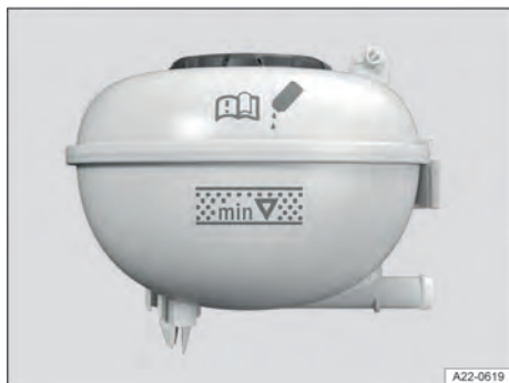
Fig. 172 No compartimento dianteiro: marcas no reservatório de expansão do líquido de arrefecimento (representação esquemática).
