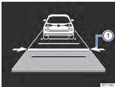
Fig. 112 No display do instrumento combinado: distância ajustada no caso de regulagem (representação esquemática).
