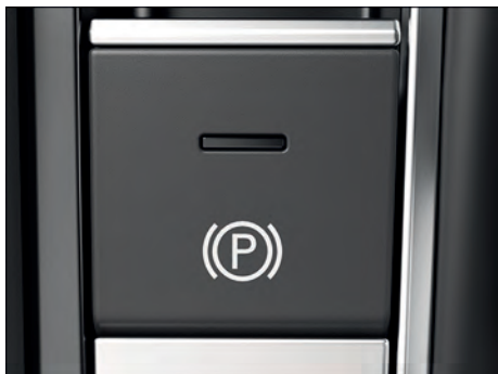
Fig. 117 No console central: botão do freio de estacionamento eletrônico.
