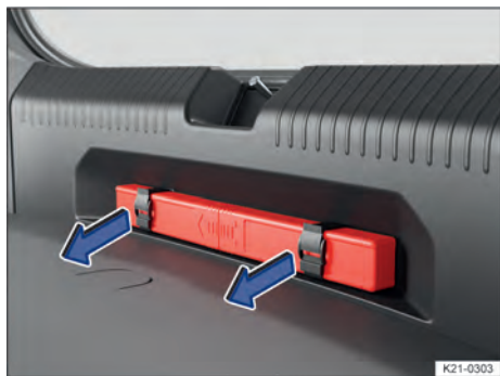
Fig. 40 Embaixo do canto do compartimento de carga: suporte para o triângulo de segurança.
