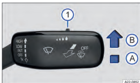
Fig. 82 À direita da coluna de direção: alavanca dos limpadores dos vidros.
