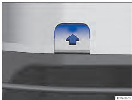
Fig. 194 No para-choque dianteiro à direita: retirar cobertura.
