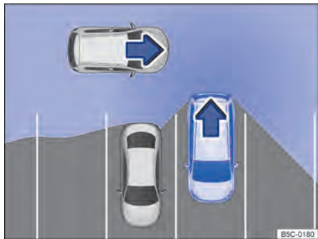
Fig. 132 Assistente de saída de vaga: área monitorada ao redor do veículo saindo da vaga de estacionamento (representação esquemática).
