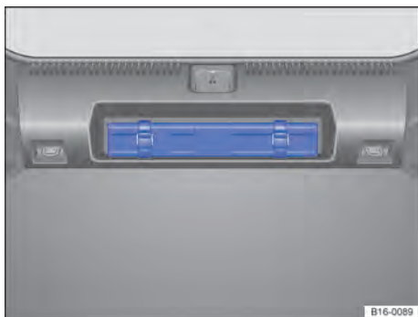
Fig. 44 Na tampa do compartimento de bagagem: suporte para o triângulo de segurança.
