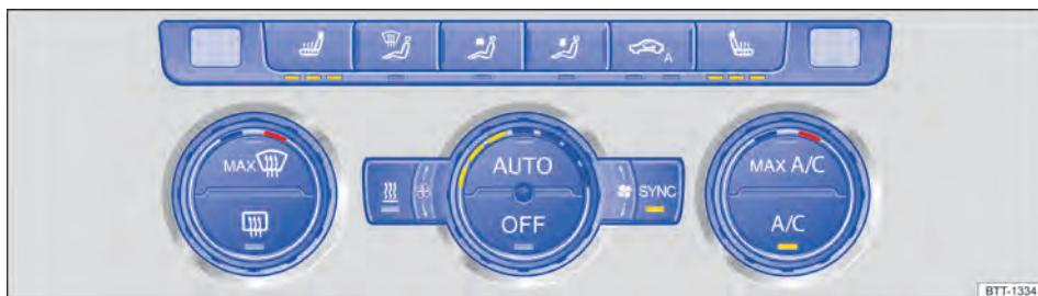
Fig. 97 Na parte superior do console central: comandos do Climatronic.
