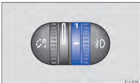
Fig. 85 Ao lado do volante: regulador da regulagem de alcance do farol
