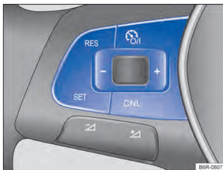
Fig. 119 Lado esquerdo do volante multifunções: botões para comandar o GRA.
