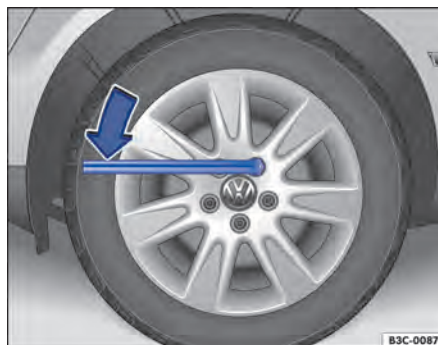
Fig. 219 Troca de roda: afrouxar os parafusos de roda.
