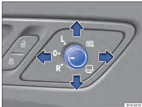
Fig. 92 Na porta do condutor: botão rotativo para espelho retrovisor externo elétrico.
