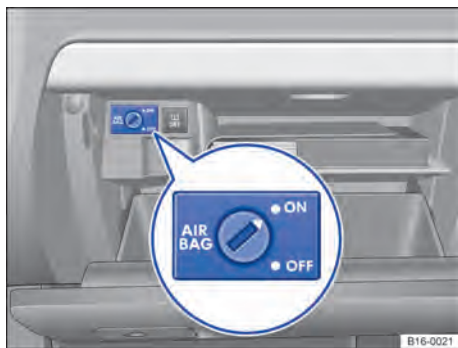
Fig. 33 No porta-luvas: interruptor acionado pela chave para desligar e ligar o airbag frontal do passageiro.
