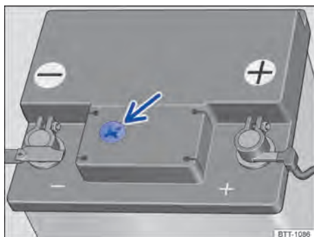
Fig. 207 Visor no lado superior da bateria do veículo 12 V (representação esquemática).
