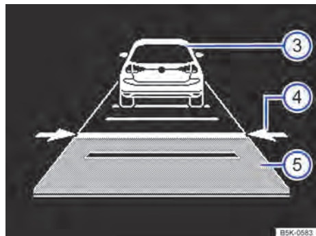
Fig. 121 No display do instrumento combinado: ACC ativo, veículo à frente reconhecido, distância temporal regulada.
