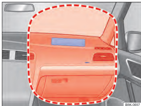
Fig. 32 Local de instalação e área de expansão do airbag frontal do passageiro dianteiro.
