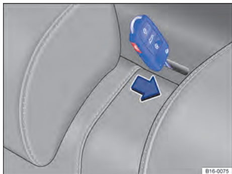
Fig. 61 Atrás do encosto do banco traseiro: destravamento de emergência do encosto do banco traseiro.
