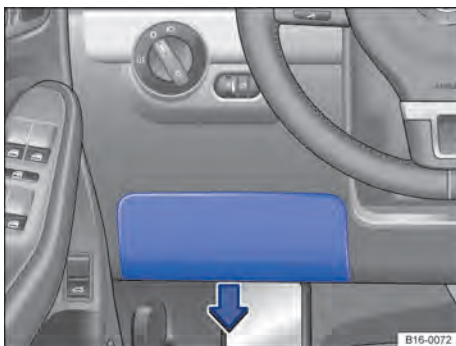
Fig. 187 No lado do condutor do painel de instrumentos: cobertura da caixa de fusíveis.
