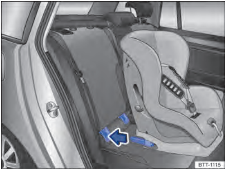
Fig. 41 Instalar a cadeira de criança ISOFIX com os braços de apoio (representação esquemática).
