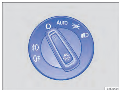
Fig. 82 Ao lado do volante: interruptor das luzes (uma variante).
