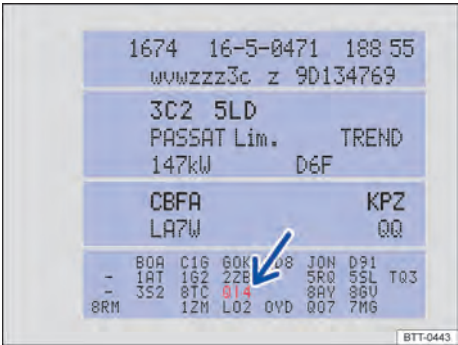
Fig. 227 Etiqueta de dados do veículo com número PR do respectivo serviço (Representação esquemática).
