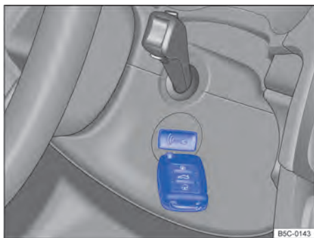
Fig. 107 À direita na coluna de direção: função de partida de emergência em veículos com sistema de travamento e de partida Keyless Access sem chave.
