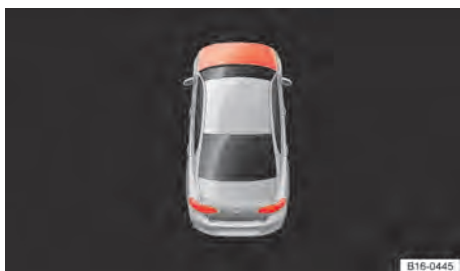
Fig. 199 No display do instrumento combinado: tampa do compartimento do motor aberta ou fechada incorretamente (variante 2).
