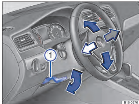
Fig. 67 Embaixo do volante no revestimento da coluna de direção: alavanca de ajuste mecânico da posição do volante.
