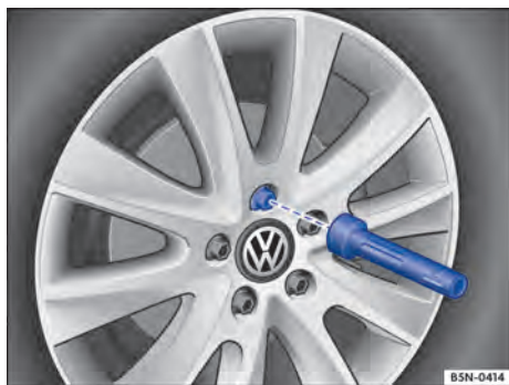
Fig. 225 Troca de roda: desaparafusar os parafusos de roda com o punho da chave de fenda.
