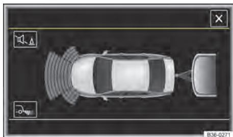
Fig. 140 Exibição do display (display colorido) do Park Pilot em condução com reboque (representação esquemática).
