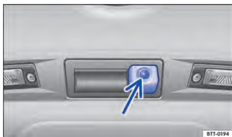
Fig. 143 Na tampa do compartimento de bagagem: local de instalação do assistente de condução em marcha a ré.
