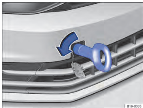
Fig. 195 No para-choque dianteiro à direita: rosquear a argola de reboque.
