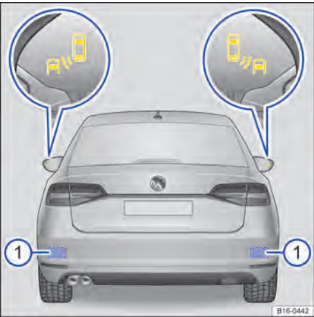
Fig. 129 Visão traseira do veículo: áreas dos sensores de radar e indicações do sensor de ponto cego. ►
