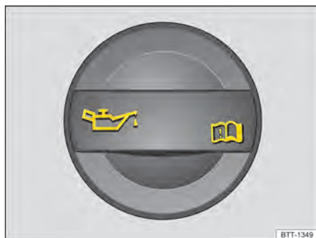
Fig. 202 No compartimento do motor: tampa da abertura para enchimento de óleo do motor (representação esquemática).
