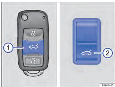
Fig. 58 Botão para destravar e abrir a tampa do compartimento de bagagem na chave do veículo e na porta do condutor.
