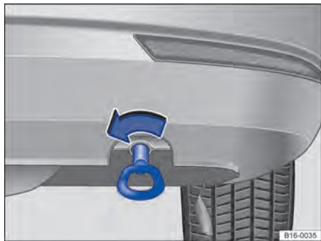
Fig. 193 No para-choque traseiro à direita: rosquear a argola de reboque.
