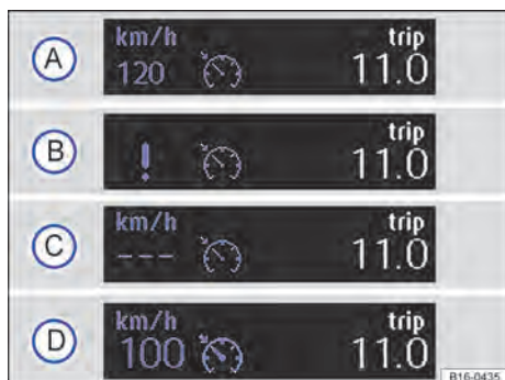
Fig. 117 No display do instrumento combinado: indicadores de status do GRA.
