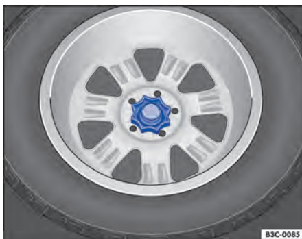
Fig. 213 No compartimento de bagagem: manípulo para fixação da roda sobressalente.
