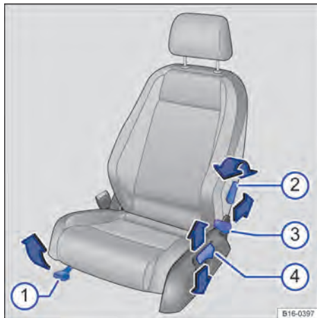
Fig. 69 No banco dianteiro esquerdo: elementos de comando (variante 1).
