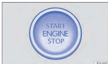
Fig. 106 Na parte inferior do console central: botão de partida para ligar o motor. ▶
