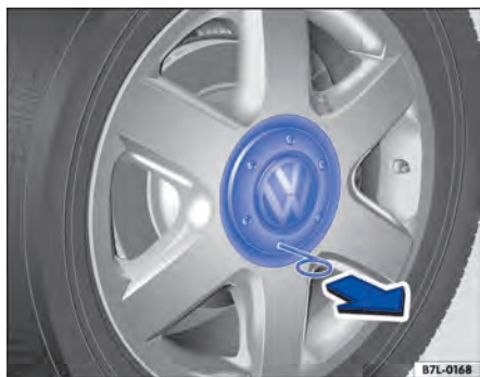
Fig. 215 Retirar a calota central.
