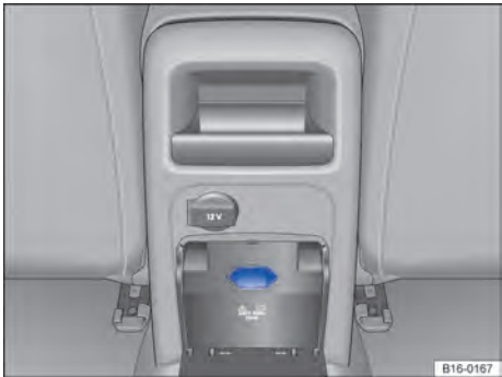
Fig. 162 Na parte traseira do console central: cobertura da tomada 230 V (padrão euro) ou 115 V aberta.
