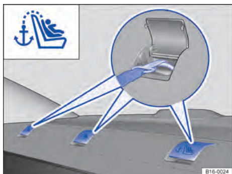
Fig. 42 Nos porta-objetos atrás do banco traseiro: olhais de retenção para o cinto de fixação superior.
