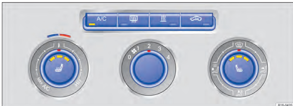
Fig. 95 Na parte superior do console central: comandos do ar-condicionado (manual) (variante 1).
