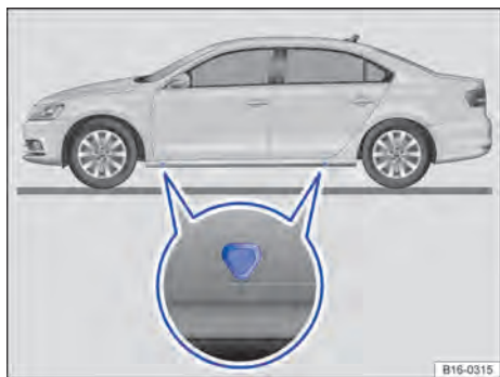
Fig. 221 Pontos de apoio do macaco.
