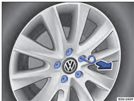
Fig. 218 Remover as capas de cobertura dos parafusos de roda.
