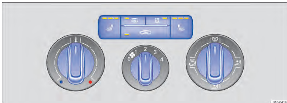
Fig. 98 Na parte superior do console central: comandos do sistema de ventilação e aquecimento.
