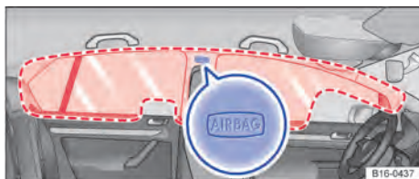
Fig. 36 No lado esquerdo do veículo: local de instalação e área de expansão do airbag para cabeça.
