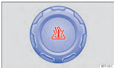
Fig. 204 No compartimento do motor: tampa do reservatório de expansão do líquido de arrefecimento do motor (representação esquemática).
