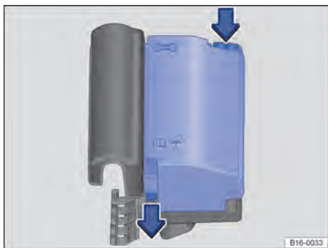
Fig. 188 No compartimento do motor: cobertura da caixa de fusíveis.
