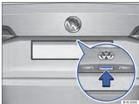
Fig. 59 Abrir a tampa do compartimento de bagagem por fora.
