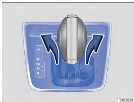
Fig. 115 Desinstalar a cobertura do quadro da alavanca seletora.
