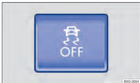
Fig. 144 Na parte inferior do console central: botão para desligar e ligar o ASR manualmente (dependendo do modelo).
