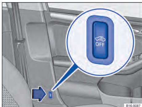
Fig. 52 Ao lado do banco do condutor: botão para desligar o monitoramento do interior do veículo e o alarme antirrebocagem.
