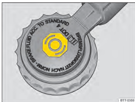
Fig. 205 No compartimento do motor: tampa do reservatório do fluido de freio (representação esquemática).
