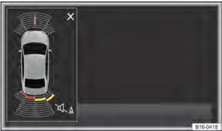
Fig. 137 Indicação do display (display a cores) da vista em miniatura nos arredores do veículo (representação esquemática).
