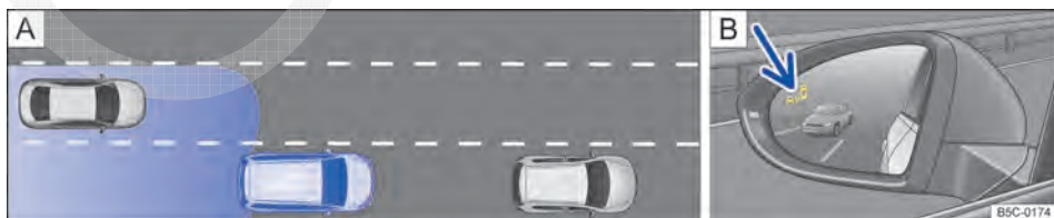
Fig. 175 A Situação de condução ao ultrapassar com o trânsito traseiro. B Indicação do sensor de ponto cego no espelho retrovisor externo esquerdo (representação esquemática).
