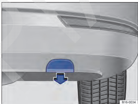
Fig. 251 No para-choque traseiro à direita: remover cobertura.
