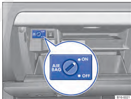
Fig. 78 No porta-luvas: interruptor acionado pela chave para desligar e ligar o airbag frontal do passageiro.
