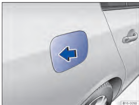
Fig. 191 Lado do veículo tras. direito: Abertura da tampa do tanque.
