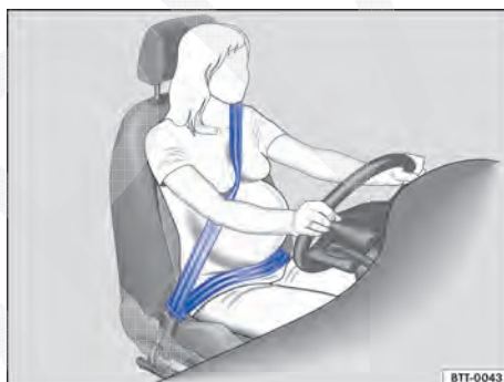
Fig. 73 Posição correta do cadarço do cinto de segurança para mulheres grávidas.
