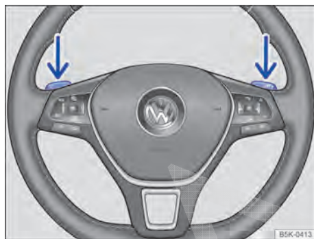
Fig. 145 Volante com seletores basculantes do Tiptronic.
