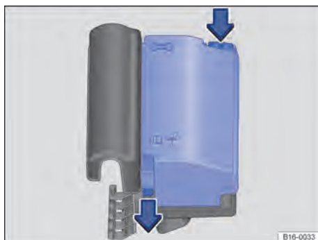
Fig. 238 No compartimento do motor: cobertura da caixa de fusíveis.
