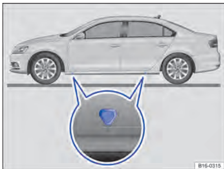
Fig. 231 Pontos de apoio do macaco.
