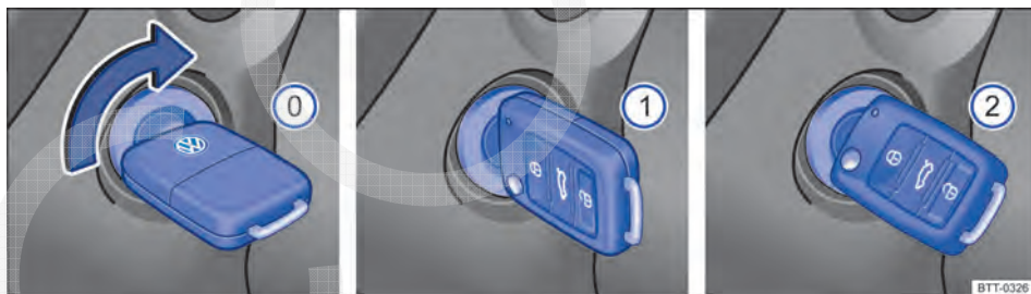
Fig. 134 Posições da chave do veículo no cilindro da ignição.
