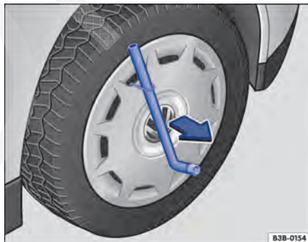
Fig. 227 Retirar a calota integral.
