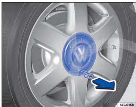
Fig. 225 Retirar a calota central.
