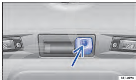
Fig. 158 Na tampa do compartimento de bagagem: local de instalação do assistente de condução em marcha a ré.
