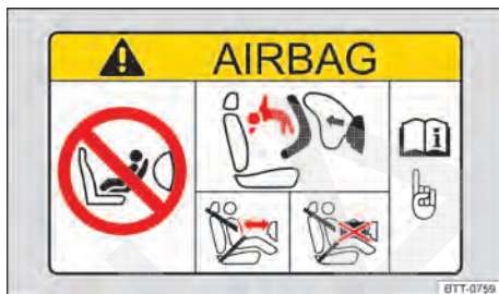
Fig. 82 Etiqueta do airbag no para-sol (representação esquemática).
