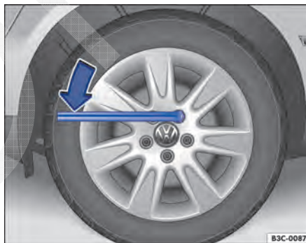
Fig. 229 Troca de roda: Afrouxar os parafusos de roda.
