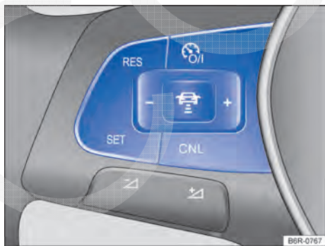
Fig. 167 Lado esquerdo do volante multifunções: botões para comandar a regulagem automática de distância.
