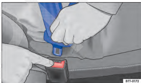
Fig. 71 Soltar a lingueta do cinto de segurança do fecho do cinto de segurança.
