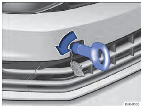
Fig. 250 No para-choque dianteiro à direita: rosquear a argola de reboque.
