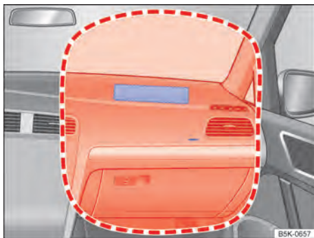
Fig. 77 Local de instalação e área de expansão do airbag frontal do passageiro dianteiro.
