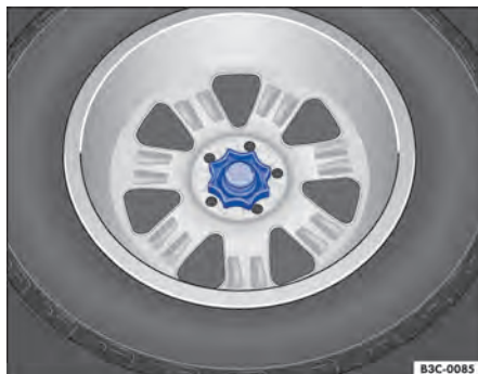
Fig. 208 No compartimento de bagagem: manípulo para fixação da roda sobressalente.
