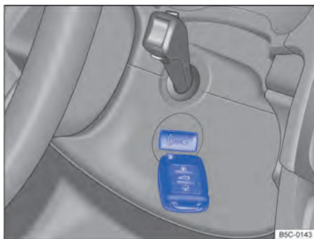
Fig. 136 À direita na coluna de direção: função de partida de emergência em veículos com Keyless Access. ▶
