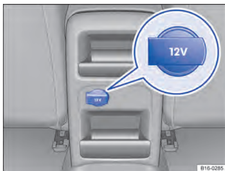
Fig. 131 Tomada 12 V no console central - variante 2.
