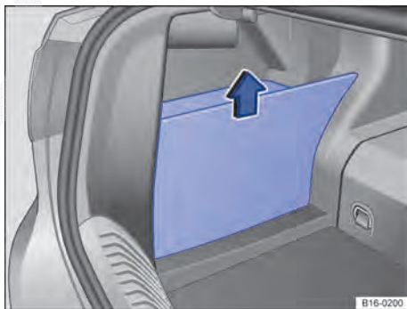
Fig. 26 A bateria do veículo 12 V no compartimento de bagagem: desinstalar a cobertura da bateria do veículo 12 V.
