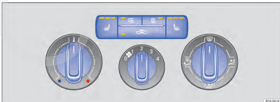
Fig. 183 Na parte superior do console central: comandos do sistema de ventilação e aquecimento.
