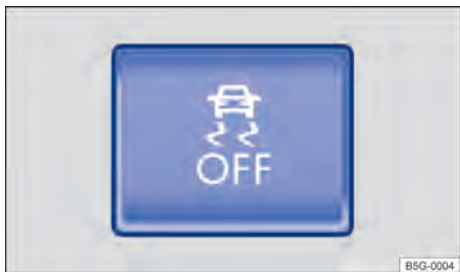
Fig. 147 Na parte inferior do console central: botão para desligar e ligar o ASR manualmente (dependendo do modelo).
