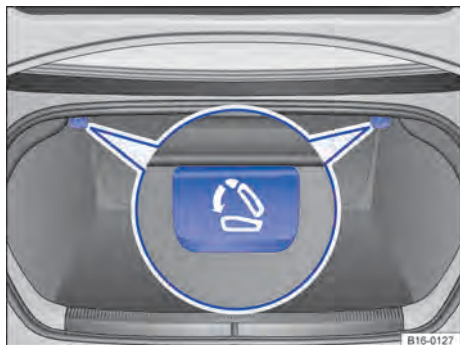
Fig. 62 No compartimento de bagagem: alavanca de destravamento para o encosto do banco traseiro.
