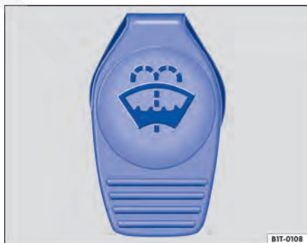
Fig. 98 No compartimento do motor: tampa do reservatório de água dos lavadores do para-brisa.
