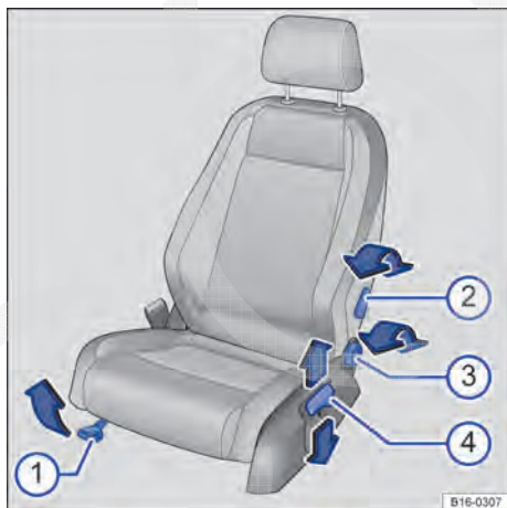
Fig. 51 Comandos do banco dianteiro esquerdo (variante 2).
