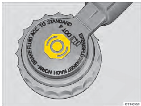
Fig. 148 No compartimento do motor: tampa do reservatório do fluido de freio.
