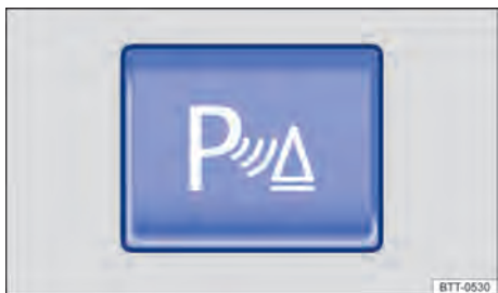
Fig. 152 Na parte inferior do console central: botão para ligar e desligar o Park Pilot.
