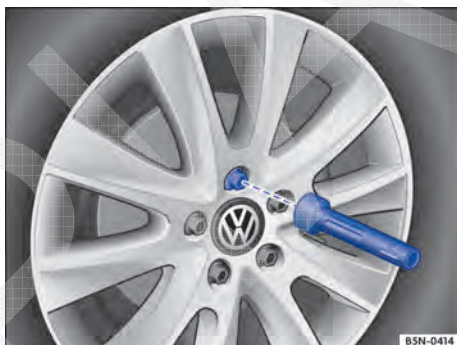
Fig. 235 Troca de roda: desaparafusar os parafusos de roda com o punho da chave de fenda.
