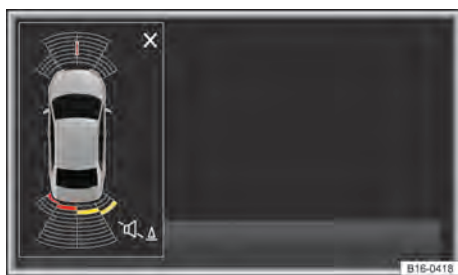
Fig. 154 Indicação do display (display a cores) da vista em miniatura nos arredores do veículo (representação esquemática).
