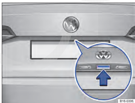
Fig. 42 Abrir a tampa do compartimento de bagagem por fora.
