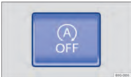
Fig. 150 Na parte inferior do console central: botão do sistema Start-Stop.
