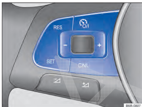
Fig. 163 Lado esquerdo do volante multifunções: botões para comandar o GRA.
