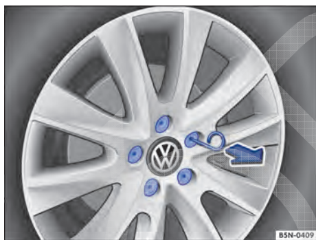
Fig. 228 Remover as capas de cobertura dos parafusos de roda.
