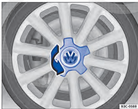
Fig. 226 Virar a calota central.
