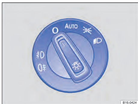
Fig. 89 Ao lado do volante: interruptor das luzes (representação esquemática).
