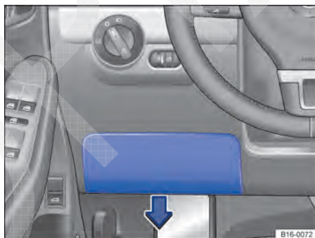
Fig. 237 No lado do condutor do painel de instrumentos: cobertura da caixa de fusíveis.
