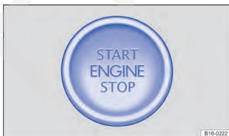
Fig. 135 Na parte inferior do console central: botão de partida do sistema de travamento e de partida Keyless Access.
