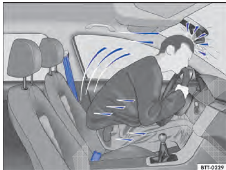
Fig. 67 O condutor sem cinto de segurança é lançado para frente.
