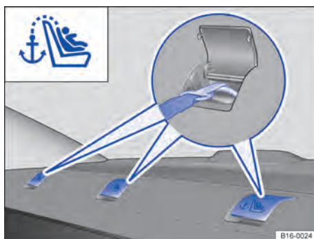
Fig. 87 Nos porta-objetos atrás da superfície atrás do banco traseiro: olhai de retenção para o cinto de fixação superior.
