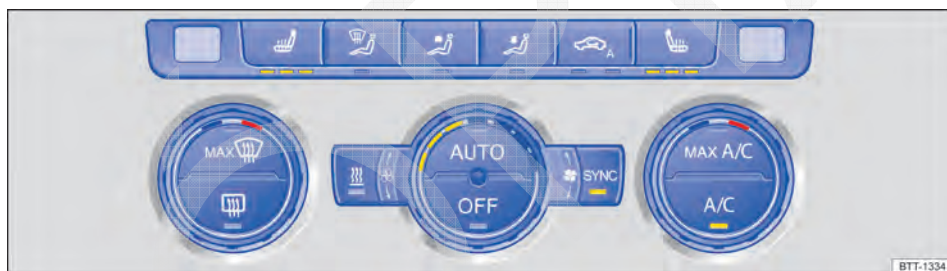
Fig. 182 Na parte superior do console central: comandos do Climatronic.
