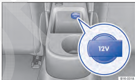
Fig. 130 Tomada 12 V no console central - variante 1.
