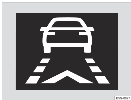
Fig. 171 No display do instrumento combinado: exibição do alerta antecipado.
