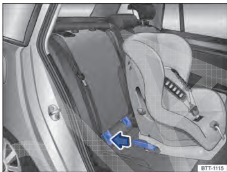
Fig. 86 Instalar a cadeira de criança ISOFIX com os braços de apoio com ajuda dos auxílios de inserção (representação esquemática)
