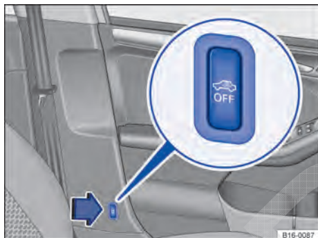
Fig. 37 Ao lado do banco do condutor: botão para desligar o monitoramento do interior do veículo e o alarme antirrebocagem.
