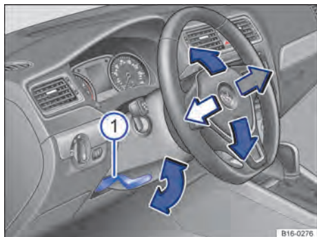
Fig. 58 Embaixo do volante no revestimento da coluna de direção: alavanca de ajuste mecânico da posição do volante.
