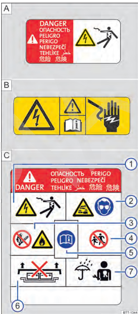
Fig. 18 Placas de advertência: A componente de alta tensão, B placa de advertência geral para alta tensão, C placa de advertência na bateria de alta tensão (representação esquemática).
