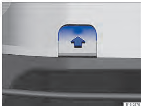
Fig. 249 No para-choque dianteiro à direita: retirar cobertura.
