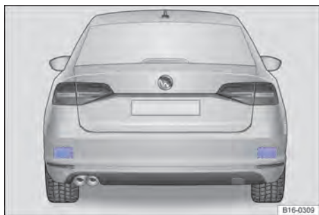
Fig. 174 Vista traseira do veículo: área dos sensores do radar.
