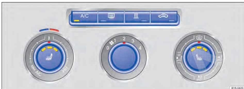
Fig. 180 Na parte superior do console central: comandos do ar-condicionado (manual) (variante 1).
