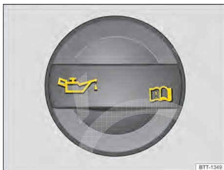
Fig. 197 No compartimento do motor: tampa da abertura para enchimento de óleo do motor (representação esquemática).
