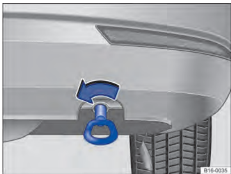
Fig. 252 No para-choque traseiro à direita: rosquear a argola de reboque.
