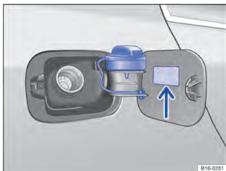
Fig. 24 Portinhola do tanque aberta com a tampa do tanque pendurada.
