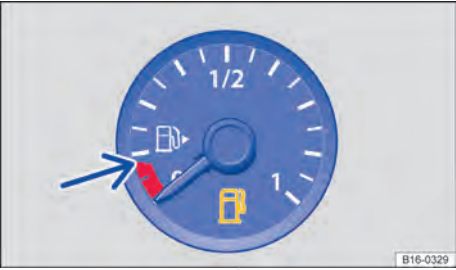
Fig. 188 No instrumento combinado: indicador de reserva de combustível (variante 1).
