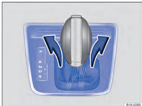
Fig. 221 Desinstalar a cobertura do quadro da alavanca seletora.
