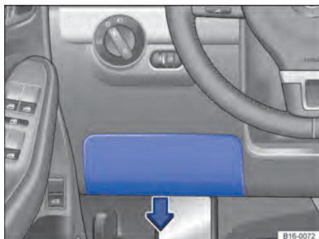
Fig. 229 No lado do condutor do painel de instrumentos: cobertura da caixa de fusíveis.
