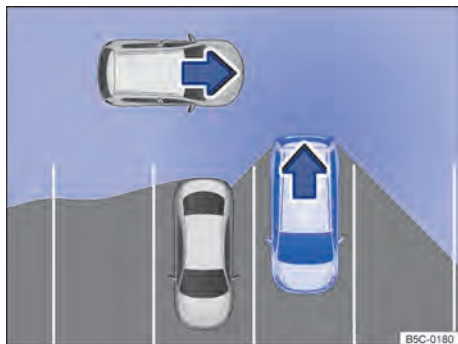
Fig. 172 Representação esquemática do assistente de saída de vaga de estacionamento: área monitorada ao redor do veículo.
