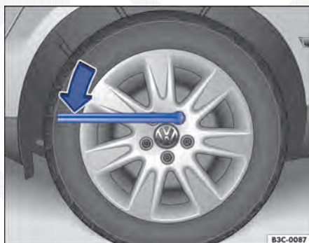
Fig. 223 Troca de roda: Afrouxar os parafusos de roda.
