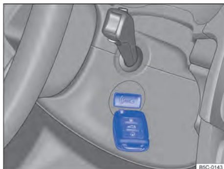
Fig. 142 À direita na coluna de direção: função de partida de emergência em veículos com Keyless Access.
