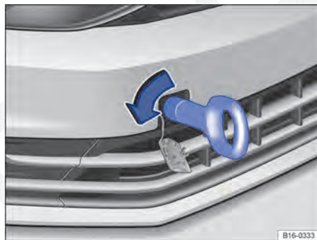
Fig. 243 No para-choque dianteiro à direita: rosquear a argola de reboque.
