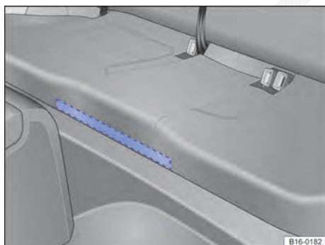
Fig. 26 Alimentação de ar para a bateria de alta tensão embaixo do banco traseiro.
