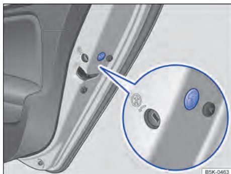
Fig. 209 Na parte dianteira da porta traseira direita: travamento de emergência, coberto por uma vedação de borracha.
