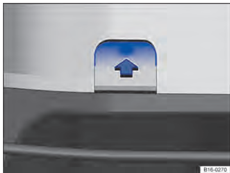
Fig. 242 No para-choque dianteiro à direita: retirar cobertura.
