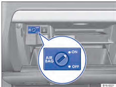
Fig. 85 No porta-luvas: interruptor acionado pela chave para desligar e ligar o airbag frontal do passageiro.
