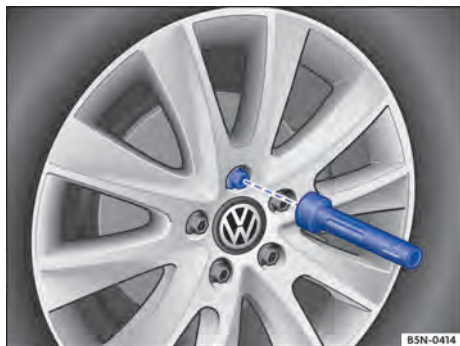
Fig. 227 Troca de roda: desaparafusar os parafusos de roda com o punho da chave de fenda.
