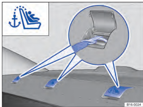
Fig. 93 Nos porta-objetos atrás do encosto do banco traseiro: olhal de retenção para o cinto de fixação superior.
