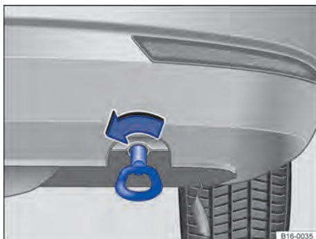
Fig. 245 No para-choque traseiro à direita: rosquear a argola de reboque.
