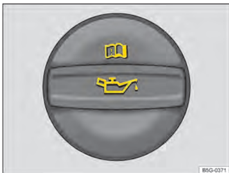
Fig. 190 No compartimento do motor: tampa da abertura de enchimento de óleo do motor.
