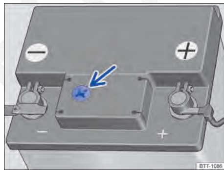
Fig. 28 Representação esquemática: visor no lado superior da bateria do veículo 12 V.
