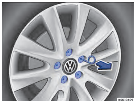
Fig. 222 Remover as capas de cobertura dos parafusos de roda.
