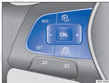
Fig. 167 Lado esquerdo do volante multifunções: botões para comandar o GRA.
