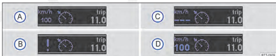
Fig. 165 No display do instrumento combinado: indicadores de status do GRA.
