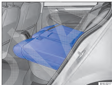
Fig. 96 Banco traseiro: encosto do banco traseiro dobrado para frente.
