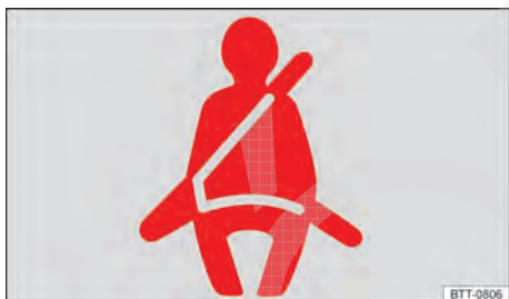
Fig. 57 Luz de advertência do instrumento combinado.
