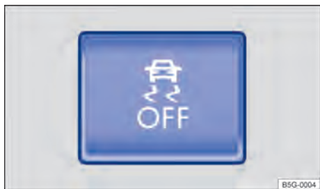
Fig. 139 Na parte inferior do console central: botão para desligar e ligar manualmente o ASR, ASR com ESC ou ESC Sport.
