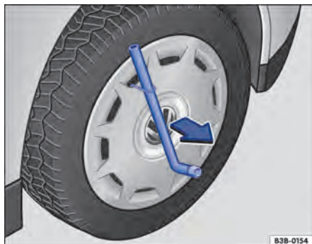
Fig. 209 Retirar a calota integral.
