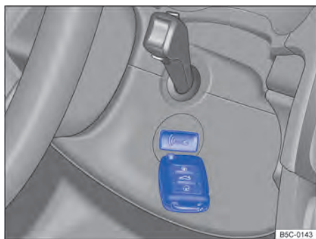
Fig. 128 À direita na coluna de direção: função de partida de emergência em veículos com Keyless Access.
