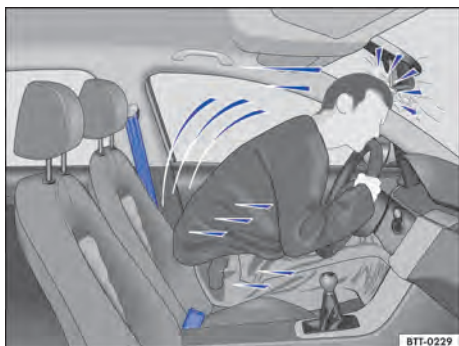
Fig. 60 O condutor sem cinto de segurança é lançado para frente.
