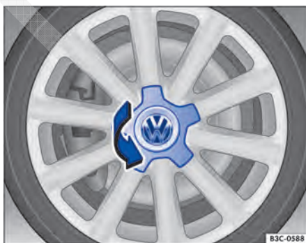
Fig. 208 Virar a calota central.
