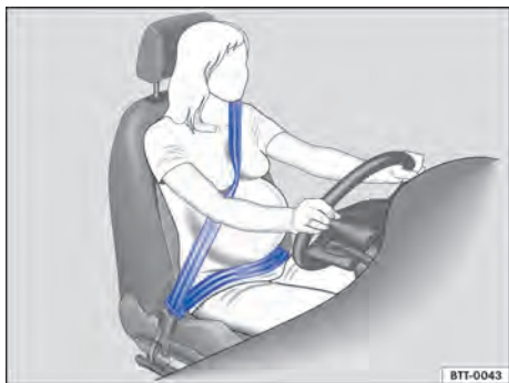
Fig. 66 Posição correta do cadarço do cinto de segurança para mulheres grávidas.
