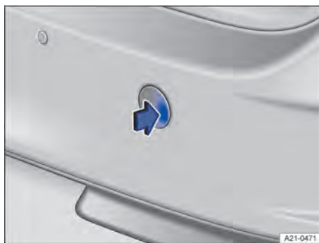
Fig. 176 No para-choque traseiro à direita: remover cobertura.
