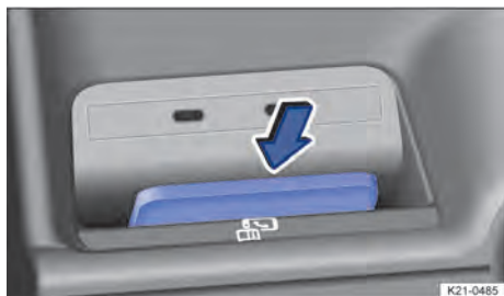
Fig. 128 Função de carregamento sem fio: bandeja de armazenamento com tapete de revestimento para a função de carregamento sem fio.
