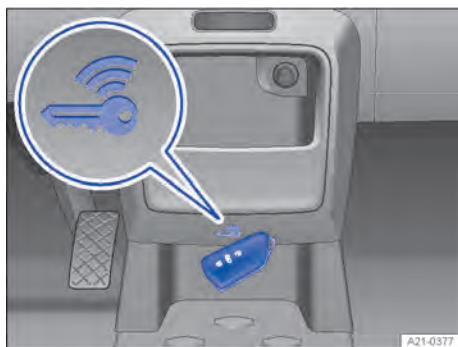
Fig. 90 Na área inferior do console central: função de partida de emergência (representação esquemática).
