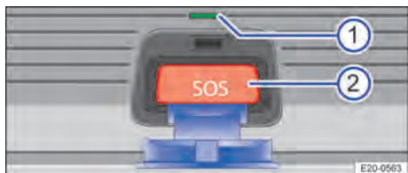
Fig. 40 Elemento de comando para chamada de emergência: luz de controle e botão.
