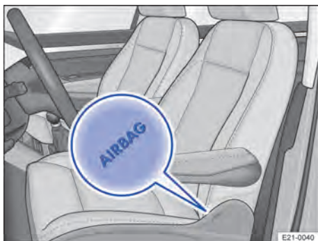
Fig. 28 Lateralmente no banco dianteiro: local de instalação do airbag lateral.
