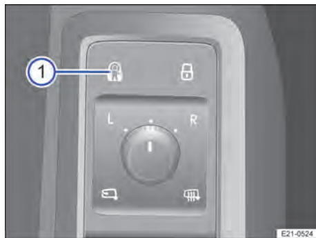
Fig. 52 Na porta do condutor: painel de controle para a trava de segurança para crianças elétrica.
