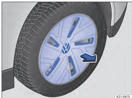
Fig. 190 Retirar a calota integral. (variante 1).
