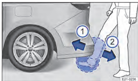
Fig. 56 Tampa traseira com fechamento controlado por sensor (Easy Close).
