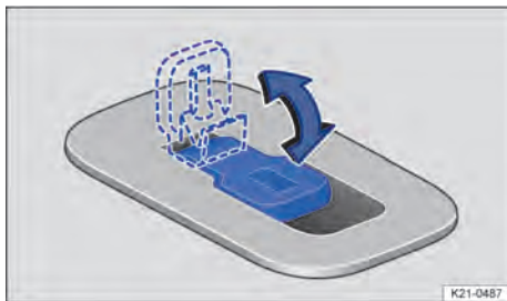
Fig. 124 No assoalho do veículo: olhais rebatíveis.
