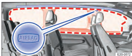
Fig. 29 No lado esquerdo do veículo: local de instalação e área de expansão do airbag para cabeça.
