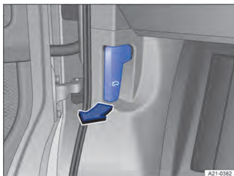
Fig. 180 Na área para os pés do lado esquerdo: alavanca de destravamento da tampa dianteira (representação esquemática).
