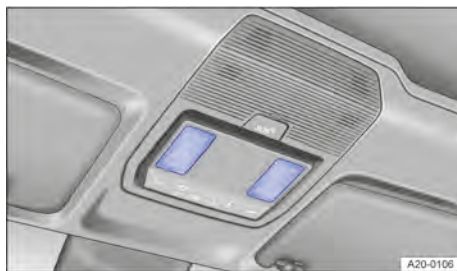
Fig. 81 No console do teto: lanterna de leitura sensível ao toque.
