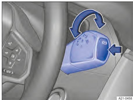
Fig. 91 No volante: Seletor da posição de marcha com o botão para o freio de estacionamento eletrônico (seta).
