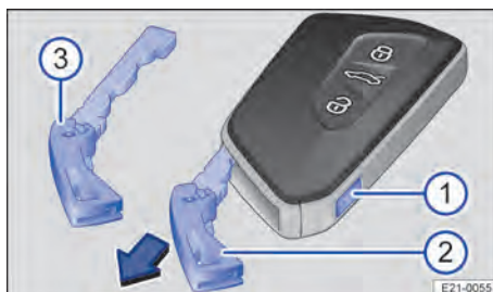
Fig. 41 Chave do veículo: destravamento da chave de emergência.
