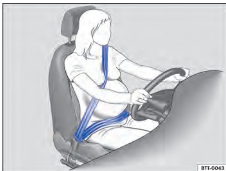
Fig. 20 Posição correta do cadarço do cinto de segurança para mulheres grávidas.
