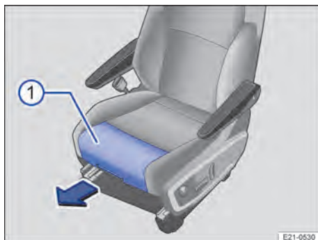
Fig. 62 No banco dianteiro esquerdo: ajuste de profundidade do banco.
