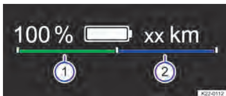
Fig. 12 No instrumento combinado digital: indicador de potência (representação esquemática).
