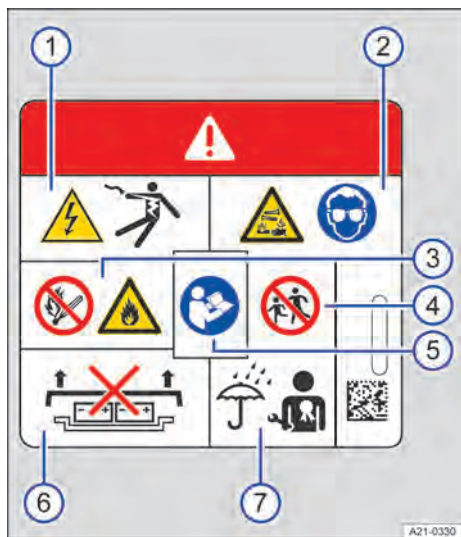
Fig. 151 Placa de advertência na bateria de alta tensão.
