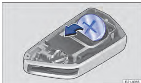
Fig. 43 Chave do veículo: trocar a pilha-botão.
