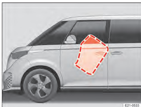
Fig. 27 No lado esquerdo do veículo: áreas de expansão do airbag lateral.
