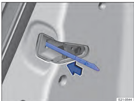
Fig. 51 Travamento de emergência da porta do veículo com a chave de emergência (Variante 2).
