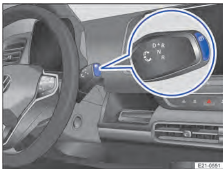
Fig. 108 No seletor da posição de marcha: botão do freio de estacionamento eletrônico (representação esquemática).
