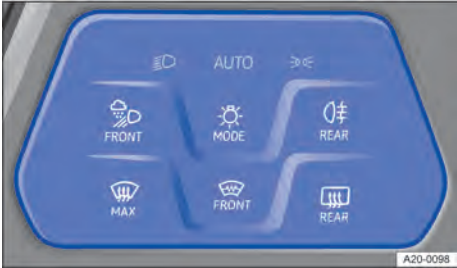
Fig. 78 Ao lado do volante: painel de controle para ligar a iluminação de condução.
