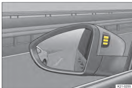
Fig. 107 Na carcaça dos espelhos retrovisores externos: indicações visuais do Side Assist.
