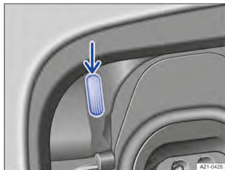
Fig. 156 Atrás da tampa do carregamento da bateria: indicador do processo de carregamento.
