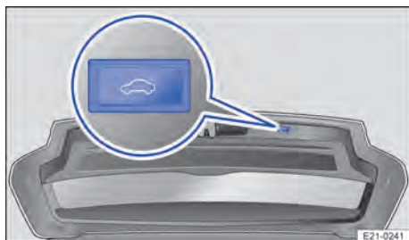
Fig. 53 Na tampa traseira aberta: botão para fechar eletricamente a tampa traseira.
