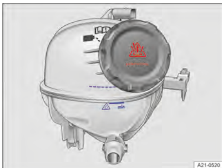
Fig. 184 No compartimento dianteiro: marcações no reservatório de expansão do líquido de arrefecimento (representação esquemática).
