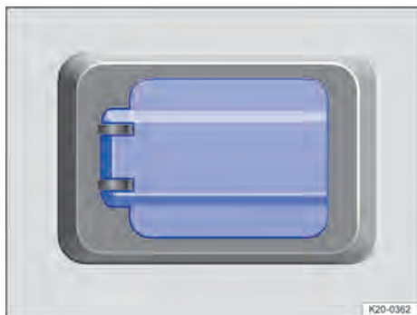
Fig. 127 Na parte inferior do banco do passageiro dianteiro: tomada de contato de proteção 230 V rebatível (representação esquemática).
