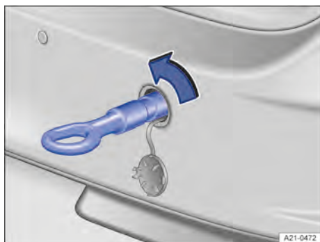
Fig. 177 No para-choque traseiro à direita: rosquear a argola de reboque.
