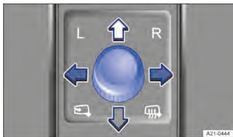
Fig. 86 Na porta do condutor: botão rotativo dos espelhos retrovisores externos.
