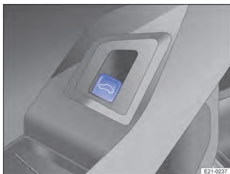
Fig. 54 Na porta do condutor aberta: botão para abertura elétrica da tampa traseira.
