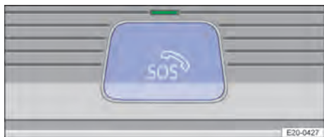
Fig. 39 No console do teto: comando do sistema de chamada de emergência eCall obrigatório por lei (atrás da cobertura dos botões).
