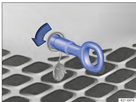
Fig. 179 No para-choque dianteiro à direita: rosquear a argola de reboque.
