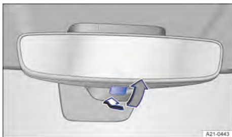
Fig. 85 No revestimento do teto: espelho retrovisor interno com antiofuscante manual.
