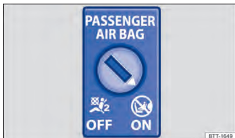
Fig. 24 No porta-luvas: interruptor acionado pela chave para desligar e ligar o airbag frontal do passageiro dianteiro.
