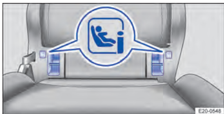
Fig. 34 Nos bancos traseiros: variantes de identificação dos pontos de ancoragem ISOFIX para cadeiras de criança.
