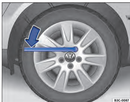
Fig. 194 Troca de roda: afrouxar os parafusos de roda.
