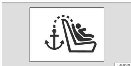
Fig. 36 Representação esquemática: identificação do ponto de fixação Top Tether.
