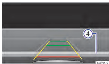
Fig. 113 Exibição do display no sistema Infotainment: alinhar o veículo dentro da vaga de estacionamento.
