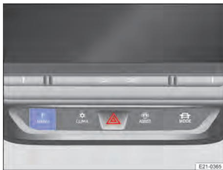
Fig. 110 No console central: painel de controle das funções de estacionamento.
