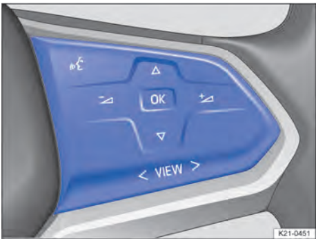
Fig. 9 Lado direito do volante multifunções: botões para comando dos menus e telas de informação do instrumento combinado digital.
