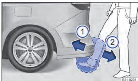
Fig. 55 Tampa traseira com abertura controlada por sensor (Easy Open).
