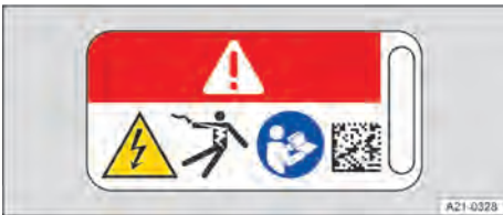
Fig. 149 Placa de advertência dos componentes de alta tensão.
