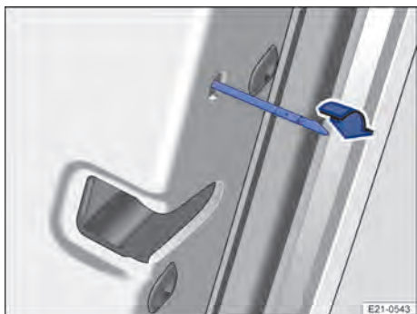
Fig. 50 Travamento de emergência da porta do veículo com a chave de emergência (Variante 1).
