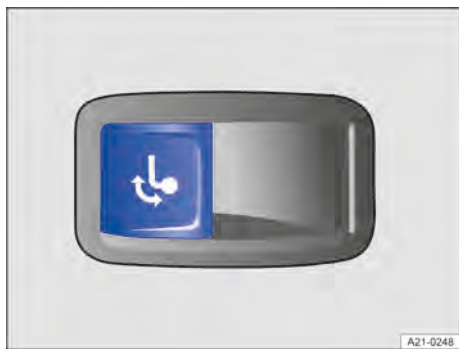
Fig. 144 No compartimento de bagagem: botão para girar para fora o engate de reboque.
