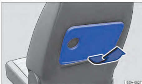
Fig. 125 No banco dianteiro ou nos bancos da segunda fileira de bancos: posicionar uma mesa dobrável.
