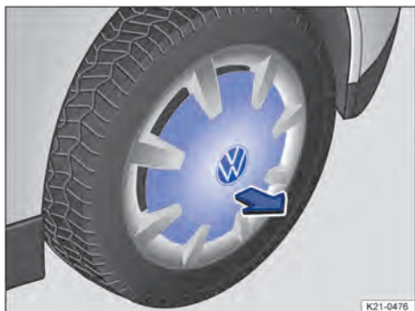
Fig. 191 Retirar a calota integral. (variante 2).
