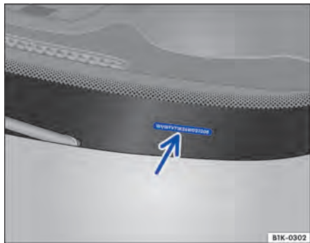
Fig. 209 No para-brisa: número de identificação do veículo.
