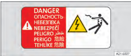
Fig. 148 Placa de advertência do carregador de bateria e de outros componentes de alta tensão.
