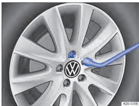
Fig. 199 Troca de roda: desaparafusar os parafusos de roda com a chave de roda.
