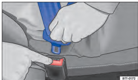
Fig. 18 Soltar a lingueta do cinto de segurança do fecho do cinto de segurança.
