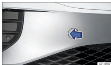
Fig. 183 No para-choque dianteiro à direita: retirar cobertura.
