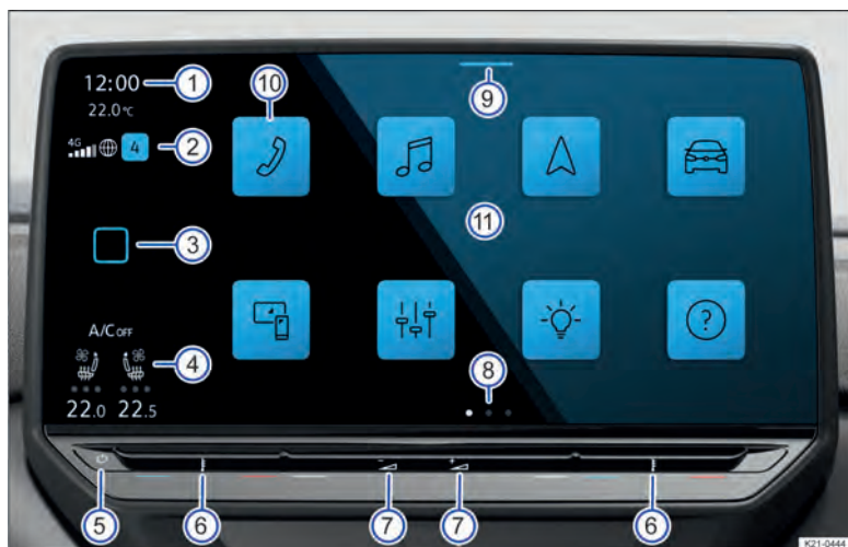
Fig. 128 Vista geral: unidade indicadora e de comando na variante de 12".
