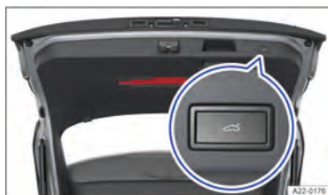
Fig. 63 Na tampa traseira aberta: botão para fechar eletricamente a tampa traseira (representação esquemática).
