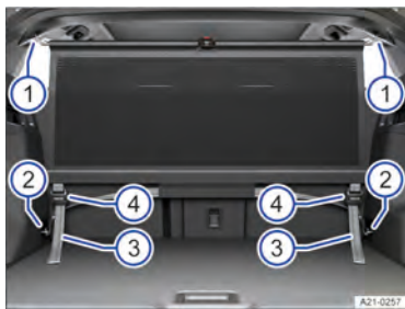
Fig. 136 No compartimento de bagagem: rede divisória instalada atrás do banco traseiro.
