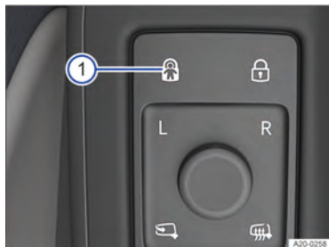
Fig. 58 Na porta do condutor: painel de controle para a trava de segurança para crianças elétrica.
