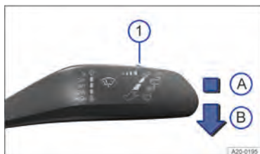
Fig. 88 À direita da coluna de direção: alavanca dos limpadores dos vidros.
