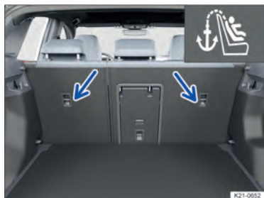
Fig. 38 No lado de trás do banco traseiro: pontos de ancoragem Top Tether do cinto de segurança Top Tether.
