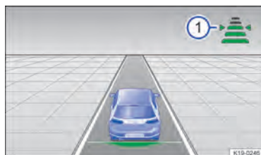
Fig. 106 No display do instrumento combinado: distância regulada ①, o ACC está regulando (representação esquemática).
