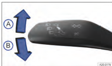
Fig. 80 À esquerda na coluna de direção: alavanca dos indicadores de direção e do farol alto.
