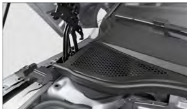
Fig. 213 Entre o compartimento dianteiro e o para-brisa: caixa coletora de água (representação esquemática).
