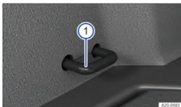
Fig. 138 No compartimento de bagagem: olhal de amarração (representação esquemática).
