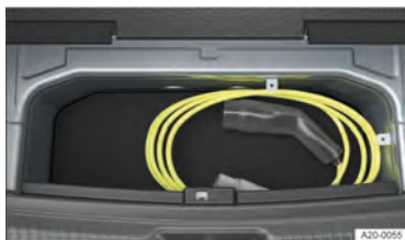
Fig. 164 Sob o assoalho do compartimento de bagagem: porta-objetos do cabo de carregamento (representação esquemática).
