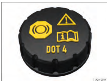
Fig. 195 No compartimento dianteiro: tampa do reservatório do fluido de freio.
