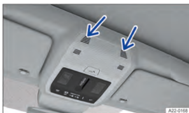
Fig. 59 No console do teto: sensores do monitoramento do interior do veículo (setas).
