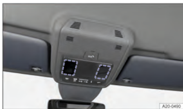
Fig. 85 No console do teto: lanterna de leitura sensível ao toque.
