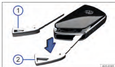
Fig. 50 Chave do veículo: abrir a tampa do compartimento da bateria.
