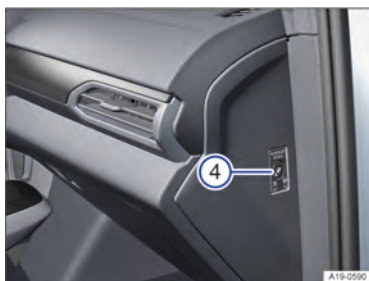
Fig. 8 Com a porta do passageiro aberta (veículo com direção à esquerda): interruptor de chave no painel de instrumentos (em veículos com direção à direita, a disposição dos elementos é espelhada).
