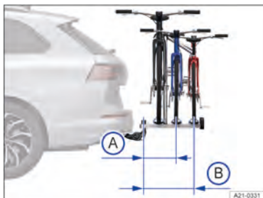
Fig. 146 Representação esquemática da largura máxima de um suporte de bicicletas para duas ou três bicicletas.
