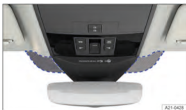
Fig. 93 Ao lado da base do espelho: janela de comunicação (representação esquemática).
