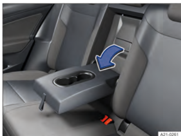
Fig. 141 Dispositivo para transporte de objetos longos no encosto do banco traseiro.
