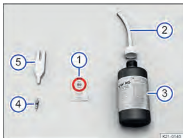
Fig. 209 Representação esquemática: componentes do kit de reparo dos pneus.
