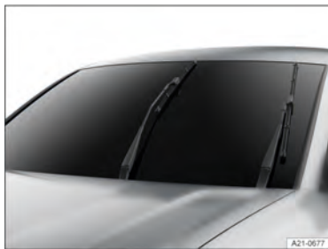
Fig. 169 Limpadores dos vidros na posição de serviço (representação esquemática).
