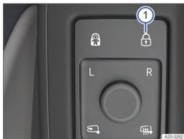
Fig. 54 Na porta do condutor: painel de controle para travamento central.
