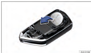
Fig. 51 Chave do veículo: trocar a pilha-botão.
