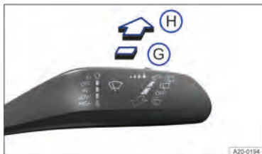
Fig. 87 À direita da coluna de direção: comandar o limpador do vidro traseiro.
