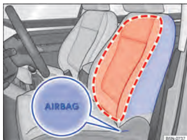
Fig. 30 Lateralmente em ambos os bancos dianteiros: local de instalação e área de expansão do airbag lateral.
