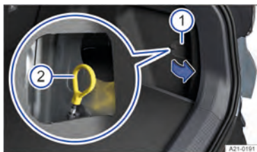
Fig. 159 Atrás da tampa do revestimento do compartimento de bagagem do lado direito: destravamento de emergência do conector de carregamento.
