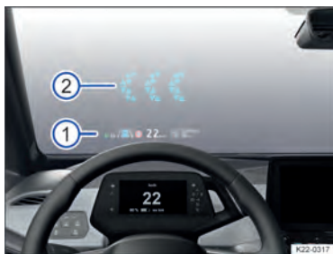
Fig. 14 No campo de visão do condutor: área próxima do HUD ① e AR-HUD ②.
