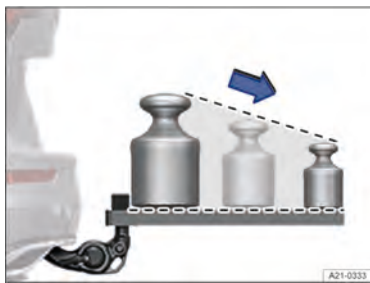
Fig. 145 Distribuição de peso recomendada no sistema de bagageiro traseiro
