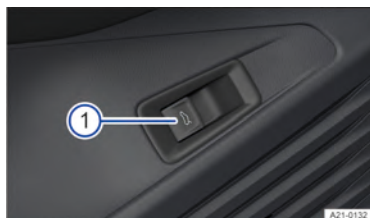
Fig. 62 Na porta do condutor: botão de destravamento da tampa traseira.
