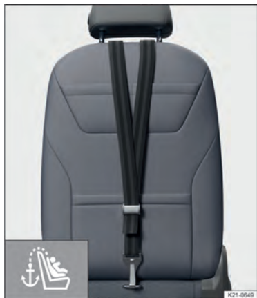
Fig. 39 No lado de trás do banco do passageiro dianteiro (de acordo com o país): cinto de fixação superior preso.
