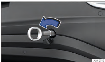
Fig. 186 No para-choque traseiro à direita: rosquear a argola de reboque.
