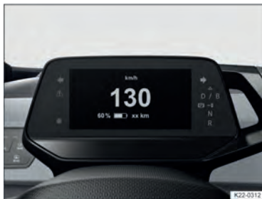
Fig. 9 Instrumento combinado digital no painel de instrumentos (representação esquemática).
