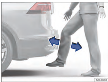
Fig. 65 Representação esquemática da tampa traseira com fechamento controlado por sensor (Easy Close).
