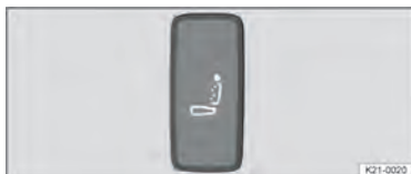
Fig. 79 Na região inferior do banco do condutor: botão da função de massagem.
