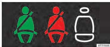
Fig. 19 No display do instrumento combinado: solicitação para colocar o cinto de segurança para os assentos traseiros (representação esquemática).
