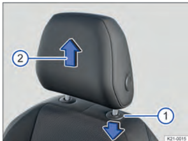
Fig. 75 Representação esquemática: remover o apoio para cabeça dianteiro.
