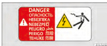
Fig. 147 Placa de advertência do carregador de bateria e de outros componentes de alta tensão.
