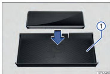
Fig. 130 Ilustração esquemática: porta-objetos com esteira para a função de carga sem fio.
