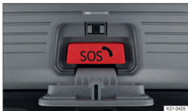
Fig. 44 No console do teto: botão para serviço de chamada de emergência.
