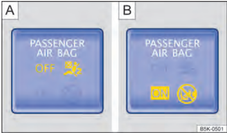
Fig. 40 Na parte superior do console central: luz de controle para o airbag frontal do passageiro dianteiro desligado A ou luz de controle para o airbag frontal do passageiro dianteiro ligado B.
