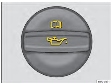
Fig. 227 No compartimento do motor: tampa da abertura para enchimento de óleo do motor.
