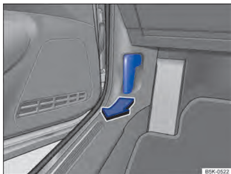
Fig. 222 No área para os pés no lado do condutor: alavanca de destravamento da tampa do compartimento do motor.
