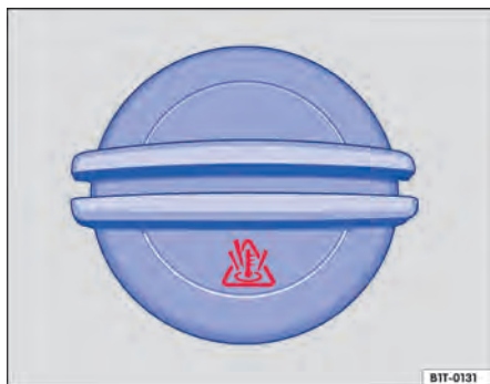
Fig. 229 No compartimento do motor: tampa do reservatório de expansão do líquido de arrefecimento do motor.
