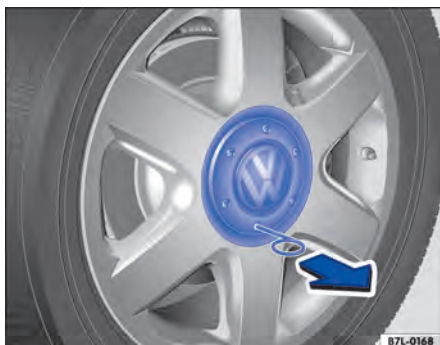
Fig. 238 Retirar a calota central.
