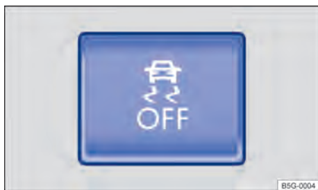
Fig. 157 No controle central: botão para desligar e ligar o ASR manualmente.
