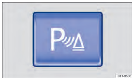
Fig. 148 No console central: botão para ligar e desligar o auxílio ao estacionamento (dependendo da versão).
