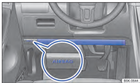
Fig. 47 No lado do condutor: local de instalação do airbag para joelhos.
