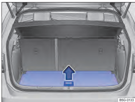
Fig. 186 No compartimento de bagagem: levantar o assoalho do compartimento de bagagem variável. ►
