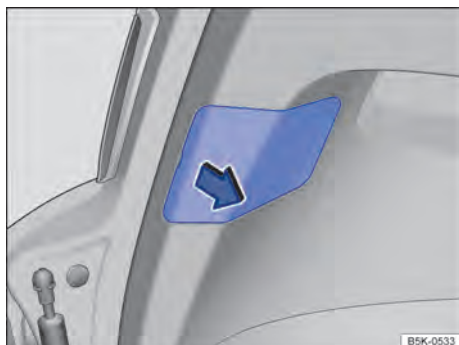
Fig. 208 Na tampa do compartimento de bagagem: retirar a cobertura.
