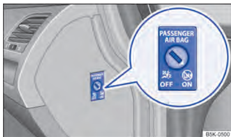
Fig. 43 No painel de instrumentos no lado do passageiro dianteiro: interruptor acionado pela chave para desligar e ligar o airbag frontal do passageiro dianteiro.
