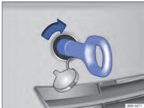
Fig. 219 No para-choque dianteiro à direita: rosquear a argola de reboque.
