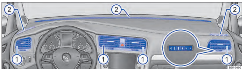
Fig. 111 No painel de instrumentos: difusores de ar.
