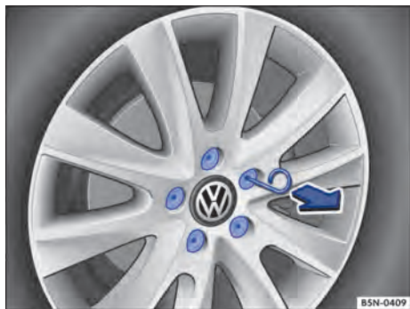
Fig. 241 Remover as capas de cobertura dos parafusos de roda.
