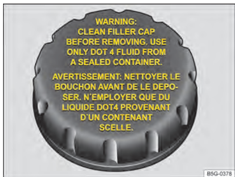
Fig. 225 No compartimento do motor: Tampa do reservatório de fluido de freio (versão 2).
