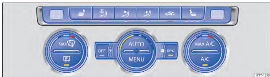
Fig. 110 Na parte superior do console central: comandos do Climatronic.
