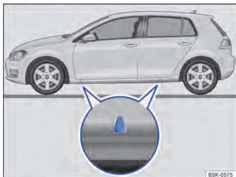
Fig. 244 Pontos de apoio do macaco.
