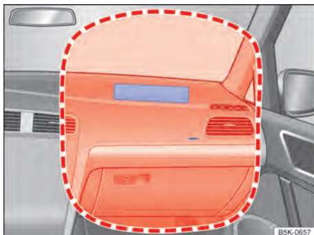
Fig. 42 Local de instalação e área de expansão do airbag frontal do passageiro dianteiro.
