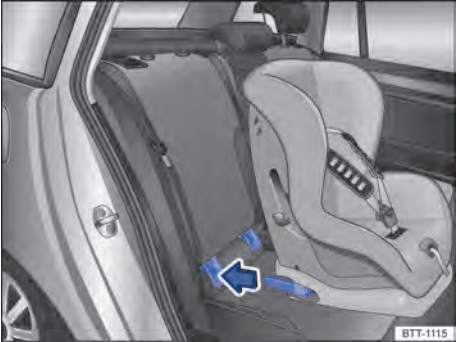
Fig. 53 Representação esquemática: instalar a cadeira de criança ISOFIX com os braços de apoio.
