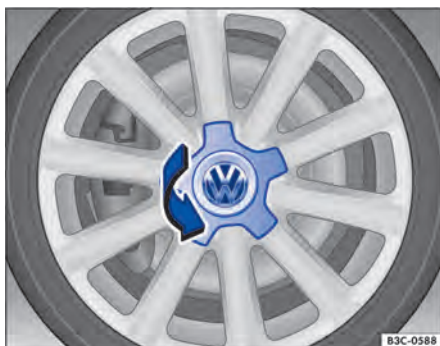
Fig. 239 Virar a calota central.
