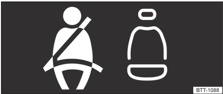
Fig. 29 Indicador de status do cinto de segurança no display do instrumento combinado para os assentos traseiros.
