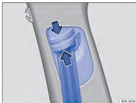
Fig. 39 Ao lado dos bancos dianteiros: regulagem de altura do cinto de segurança.
