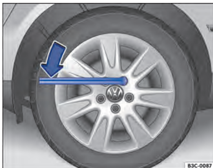
Fig. 242 Troca de roda: soltar os parafusos de roda.
