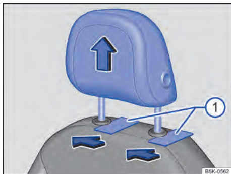
Fig. 88 Desinstalar o apoio para cabeça dianteiro.
