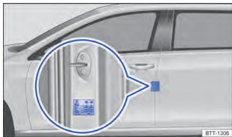
Fig. 234 Na coluna da porta do condutor: etiqueta de pressão dos pneus (alternativamente no lado interno da portinhola do tanque).
