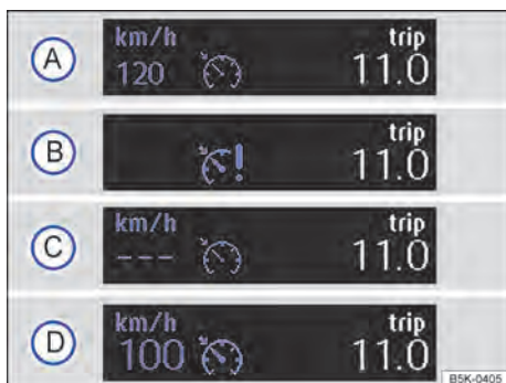
Fig. 133 No display do instrumento combinado: indicadores de status do GRA (representação esquemática).
