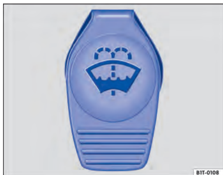
Fig. 103 No compartimento do motor: tampa do reservatório de água dos lavadores dos vidros.
