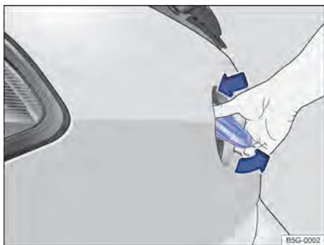
Fig. 73 Abrir a tampa do compartimento de bagagem por fora.
