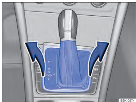
Fig. 126 Desinstalar a cobertura do quadro da alavanca seletora.
