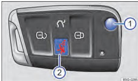
Fig. 18 Chave do veículo com botão do alarme.
