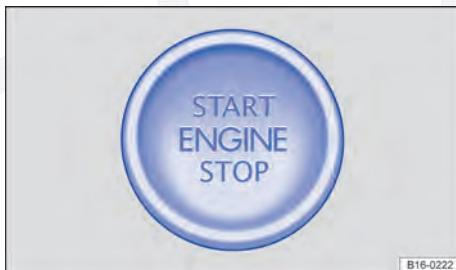
Fig. 120 Na parte inferior do console central: botão de partida do sistema de travamento e de partida Keyless Access.
