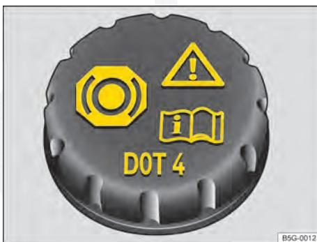
Fig. 131 No compartimento do motor: Tampa do reservatório de fluido de freio (versão 1).
