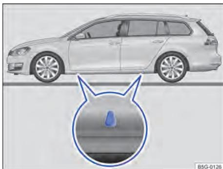
Fig. 209 Pontos de apoio do macaco.
