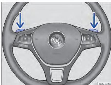
Fig. 128 Volante com 2 seletores basculantes do Tiptronic.
