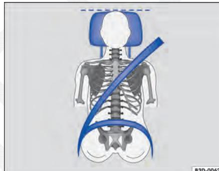
**Fig. 39** Posição correta do cinto de segurança e ajuste correto do apoio para cabeça.
