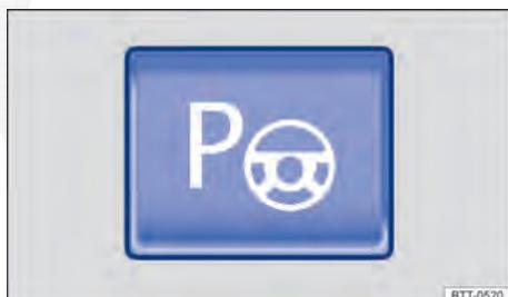
**Fig. 144** Na parte inferior do console central: botão para ligar o assistente de direção para estacionamento.
