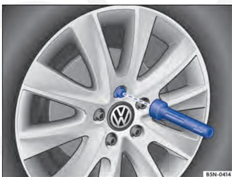
Fig. 215 Troca de roda: remover os parafusos de roda com o punho da chave de fenda.
