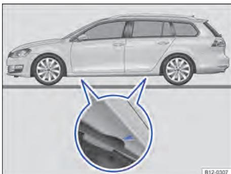
Fig. 211 Pontos de apoio do macaco.
