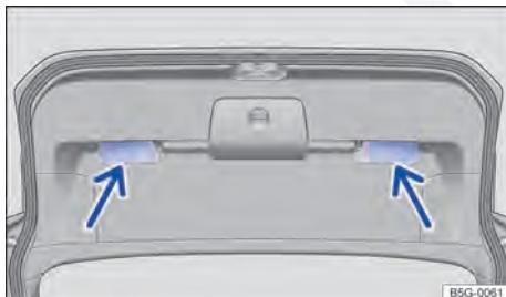
Fig. 34 Tampa do compartimento de bagagem aberta: rebaixos para puxar.
