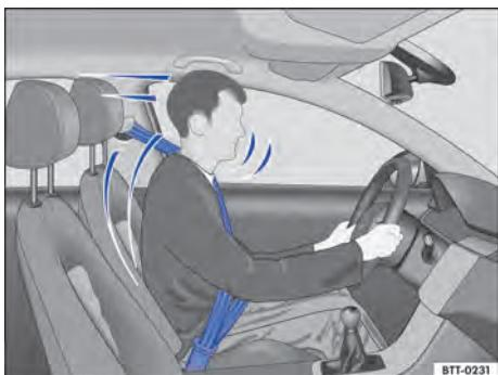
**Fig. 58** Condutor protegido pelo cinto de segurança colocado corretamente numa manobra de frenagem súbita.
