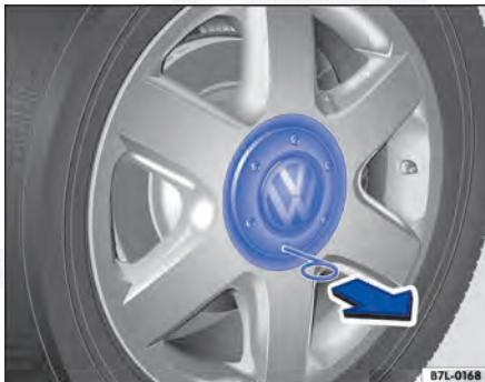
Fig. 203 Retirar a calota central.
