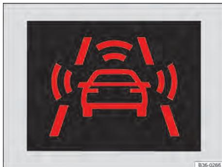
**Fig. 161** No display do instrumento combinado: exibição do alerta antecipado.
