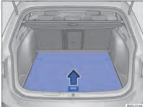
Fig. 201 No compartimento de bagagem: abrir o assoalho do compartimento de bagagem.
