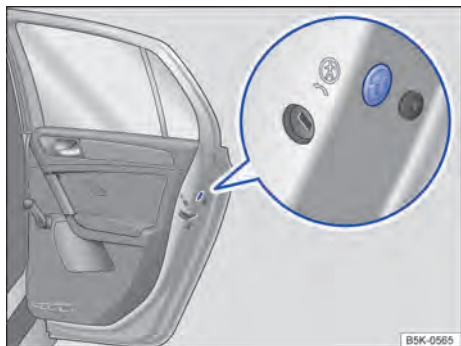
Fig. 200 Na parte dianteira da porta traseira direita: travamento de emergência, coberto por uma vedação de borracha.
