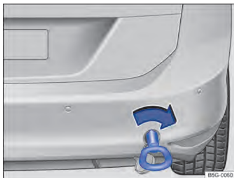
Fig. 237 No para-choque traseiro à direita: rosquear a argola de reboque.
