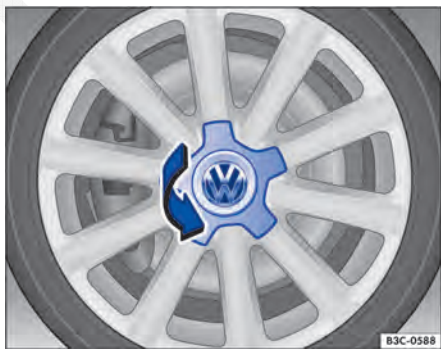
Fig. 210 Virar a calota central.
