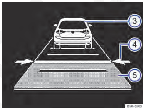
Fig. 159 No display do instrumento combinado: ACC ativo, veículo à frente reconhecido, distância temporal regulada.
