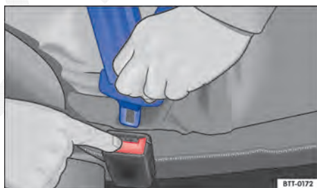
Fig. 65 Soltar a lingueta do fecho do cinto de segurança.
