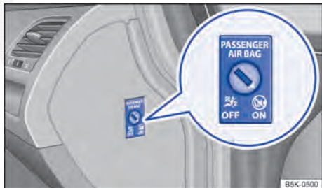
Fig. 72 No painel de instrumentos no lado do passageiro dianteiro: interruptor acionado pela chave para desligar e ligar o airbag frontal do passageiro dianteiro.
