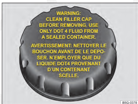
Fig. 136 No compartimento do motor: tampa do reservatório do fluido de freio (representação esquemática).
