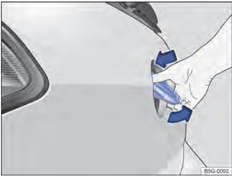
Fig. 38 Abrir a tampa traseira por fora.
