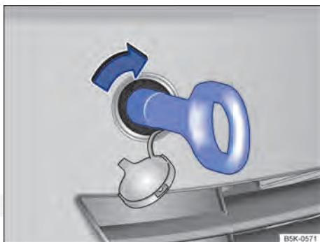
Fig. 235 No para-choque dianteiro à direita: rosquear a argola de reboque.
