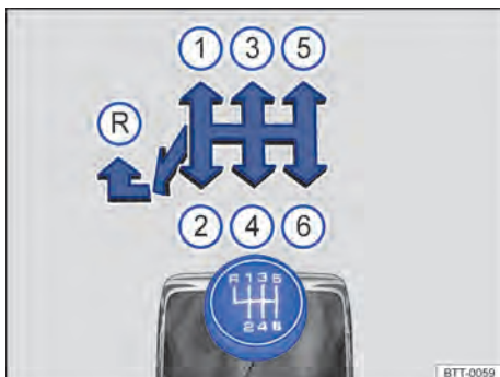
Fig. 130 Esquema de troca de marchas da transmissão manual de 6 velocidades.
