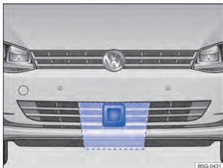
Fig. 161 Área que deve ficar livre ao redor do sensor do radar.
