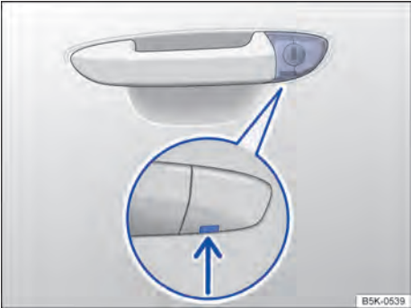
Fig. 199 Maçaneta da porta do condutor: cilindro da fechadura coberto.
