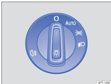
Fig. 85 Ao lado do volante: interruptor de luzes (uma variante).
