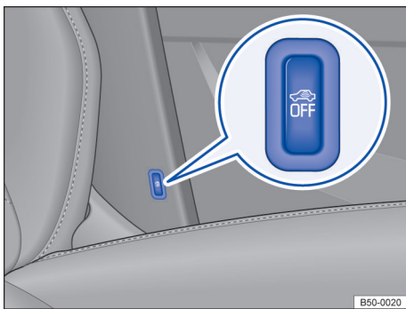
Fig. 63 Ao lado do banco do condutor: botão para desligar o monitoramento do interior do veículo e o alarme antirrebocagem (dependendo da versão).
