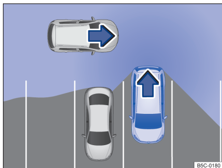
Fig. 135 Representação esquemática do assistente de saída de vaga: área monitorada ao redor do veículo.
