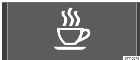
Fig. 19 No display do instrumento combinado: símbolo do sistema de reconhecimento de cansaço.
