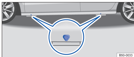
Fig. 208 Pontos de apoio do macaco.
