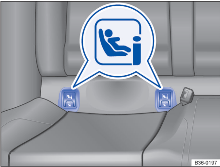
Fig. 49 Identificação dos pontos de ancoragem do i-Size para cadeiras de criança.
