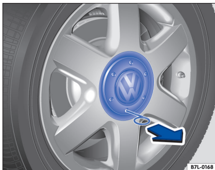
Fig. 202 Retirar a calota central.
