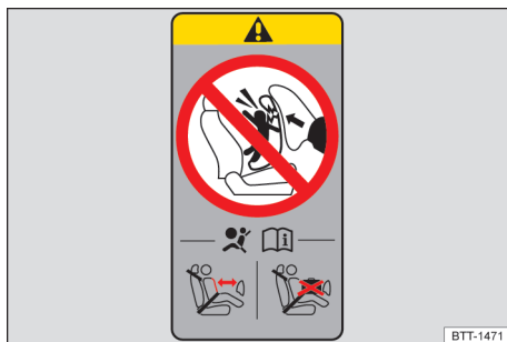
Fig. 47 Representação esquemática: etiqueta do airbag na coluna B.
