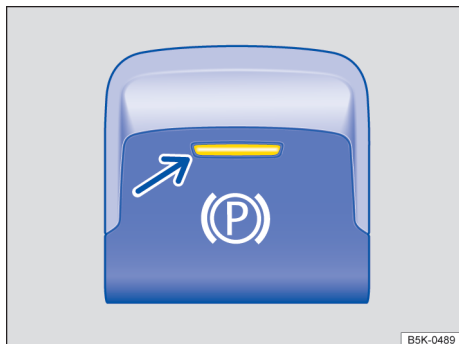
Fig. 124 No console central: botão do freio de estacionamento eletrônico (representação esquemática).
