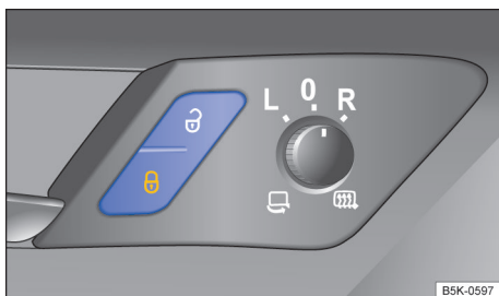
Fig. 58 Na porta do condutor: botão do travamento central.
