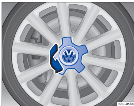
Fig. 203 Virar a calota central.
