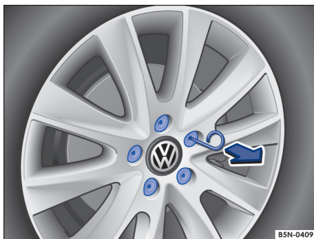
Fig. 205 Remover as capas de cobertura dos parafusos de roda.
