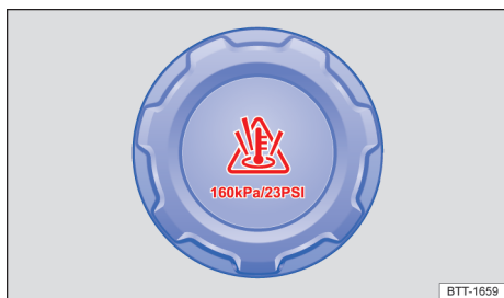
Fig. 194 No compartimento do motor: tampa do reservatório de expansão do líquido de arrefecimento (representação esquemática).
