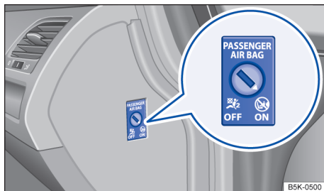
Fig. 44 No porta-luvas: interruptor acionado pela chave para desligar e ligar o airbag frontal do passageiro.
