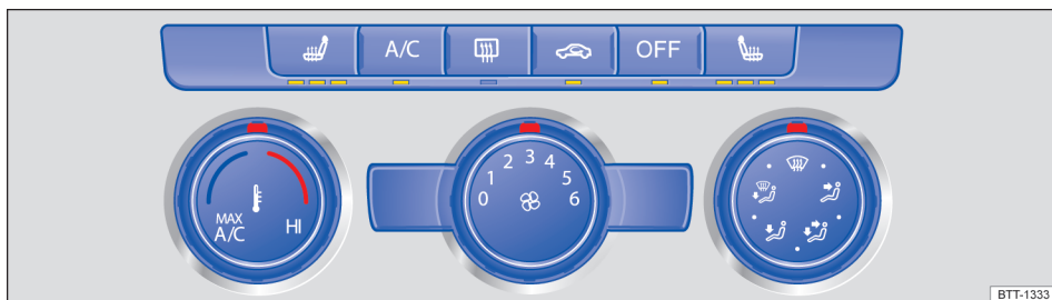
Fig. 101 Na parte superior do console central: comandos do ar-condicionado manual.
