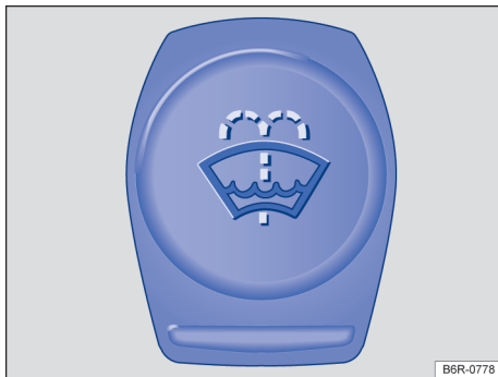
Fig. 213 No compartimento do motor: tampa do reservatório da água dos lavadores dos vidros.
