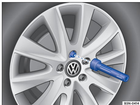
Fig. 238 Substituição de roda: desrosquear os parafusos de roda com o cabo da chave de fenda.
