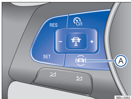
Fig. 23 Lado esquerdo do volante multifunções: botão dos sistemas de assistência ao condutor.
