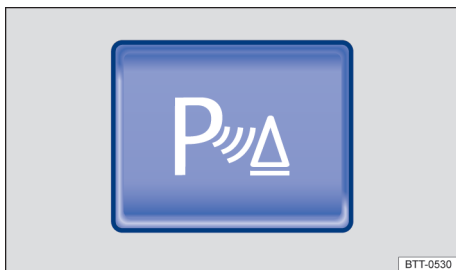
Fig. 131 No console central: botão para ligar e desligar o auxílio de estacionamento (dependendo da versão).
