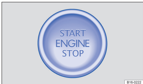
Fig. 109 Na parte inferior do console central: botão de partida para colocar o motor em funcionamento.
