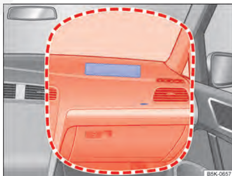
Fig. 16 Local de instalação e área de expansão do airbag frontal do passageiro dianteiro.
