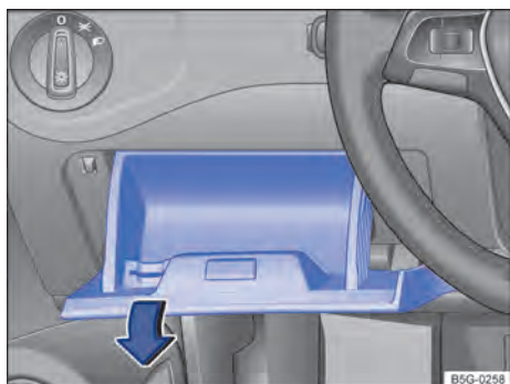
Fig. 213 À esquerda do volante: cobertura da caixa de fusíveis no painel de instrumentos.
