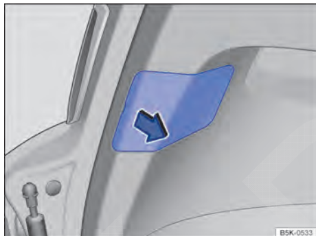
Fig. 205 Na tampa do compartimento de bagagem: retirar a cobertura.
