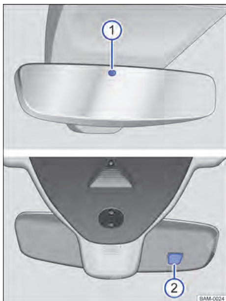
Fig. 107 No para-brisa: espelho retrovisor interno com antiofuscante automático.
