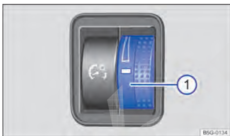
Fig. 98 Ao lado do volante: Regulador para iluminação dos instrumentos e dos interruptores ①.
