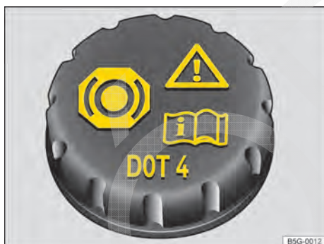
Fig. 225 No compartimento do motor: Tampa do reservatório de fluido de freio (versão 1).
