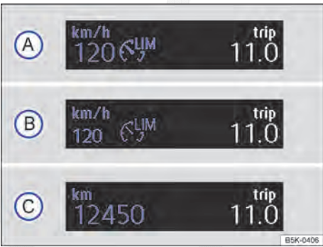
Fig. 151 No display do instrumento combinado: indicadores de status do limitador de velocidade.
