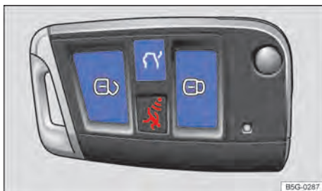
Fig. 27 Chave do veículo com botão do alarme.
