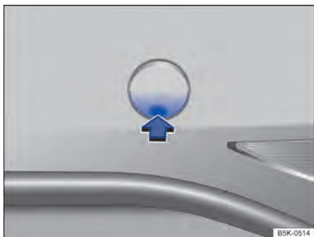
Fig. 234 No para-choque traseiro à direita: remover a cobertura.
