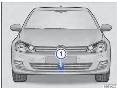
Fig. 156 No para-choque dianteiro: sensor do radar.
