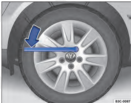
Fig. 207 Troca de roda: soltar os parafusos de roda.
