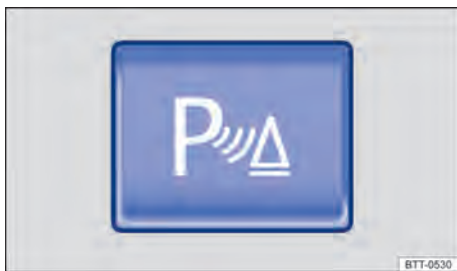
Fig. 136 Na parte inferior do console central: botão para ligar e desligar o Park Pilot.
