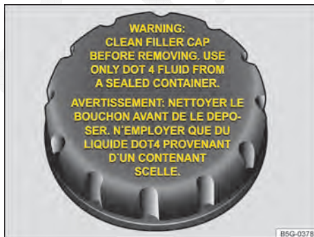
Fig. 131 No compartimento do motor: Tampa do reservatório de fluido de freio (versão 2).
