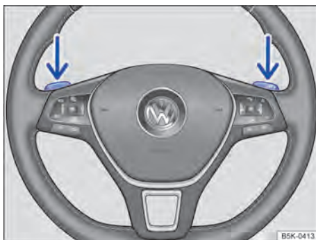
Fig. 126 Volante com 2 seletores basculantes do Tiptronic.
