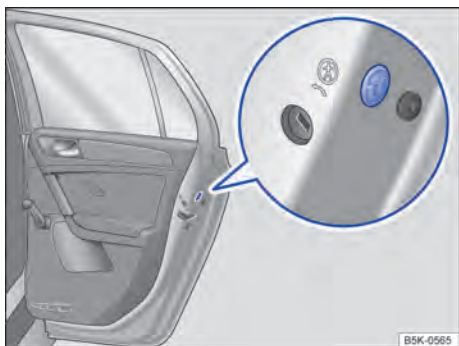
Fig. 196 Na parte dianteira da porta traseira direita: travamento de emergência, coberto por uma vedação de borracha.
