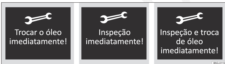
Fig. 12 Representação esquemática: exemplos de indicações no display do instrumento combinado para um evento de serviço próximo de vencer.
