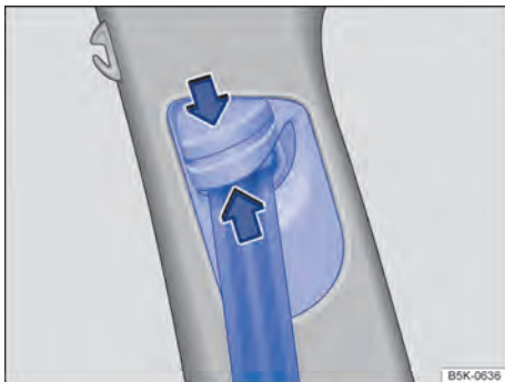
Fig. 65 Ao lado dos bancos dianteiros: regulagem de altura do cinto de segurança.
