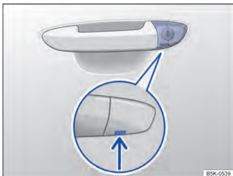
Fig. 195 Maçaneta da porta do condutor: cilindro da fechadura coberto.
