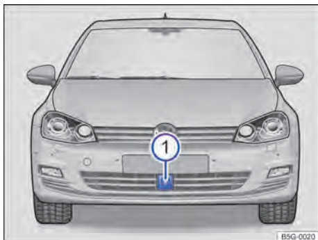
Fig. 163 No para-choque dianteiro: sensor do radar.
