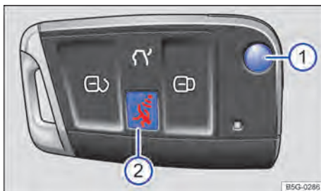
Fig. 21 Chave do veículo com botão do alarme.
