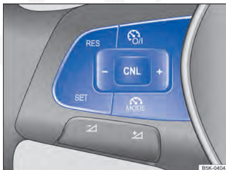
Fig. 153 Lado esquerdo do volante multifunções: botões para comandar o limitador de velocidade.
