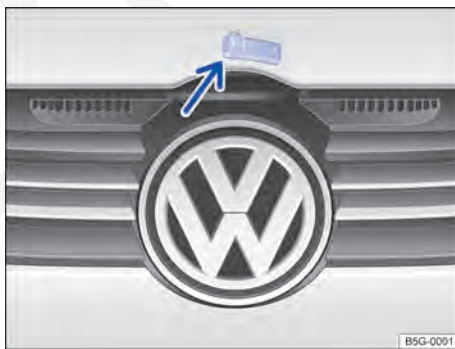
Fig. 174 Alavanca de destravamento para abrir a tampa do compartimento do motor na grade do radiador.
