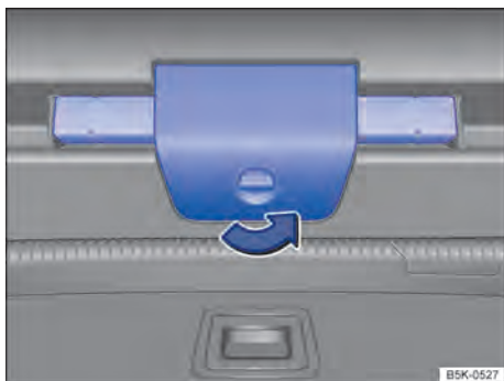
Fig. 198 Na tampa do compartimento de bagagem: abrir o suporte para o triângulo de segurança.
