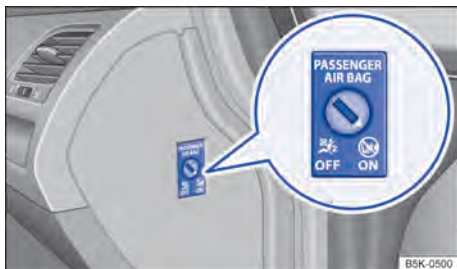
Fig. 69 No painel de instrumentos no lado do passageiro dianteiro: interruptor acionado pela chave para desligar e ligar o airbag frontal do passageiro dianteiro.
