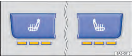
Fig. 53 Na parte superior do console central: botões do aquecimento dos bancos dianteiros.
