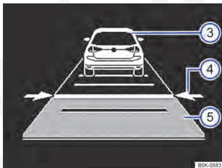
Fig. 155 No display do instrumento combinado: ACC ativo, veículo à frente reconhecido, distância temporal regulada.
