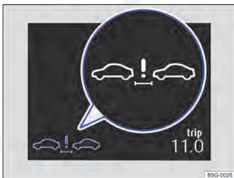
Fig. 161 No display do instrumento combinado: exibição do alerta de distância.
