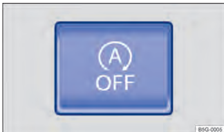
Fig. 134 Na parte inferior do console central: botão do sistema Start-Stop.
