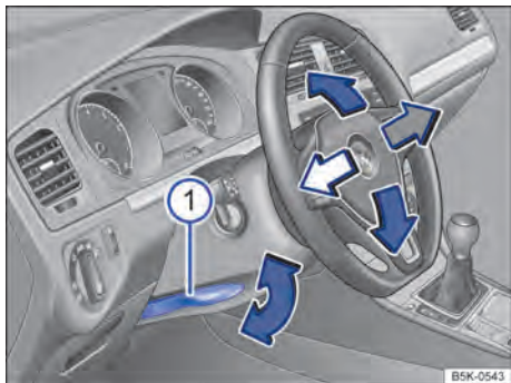
Fig. 49 Embaixo do volante no revestimento da coluna de direção: alavanca de ajuste mecânico da posição do volante.
