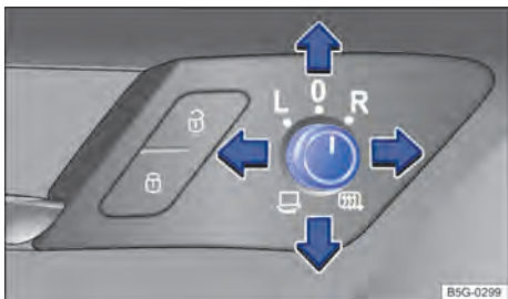
Fig. 91 Na porta do condutor: botão rotativo dos espelhos retrovisores externos.
