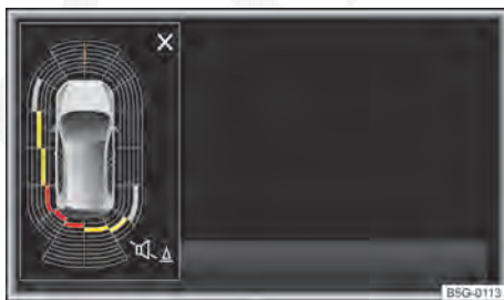
Fig. 138 Exibição do display da vista em miniatura nos arredores do veículo.
