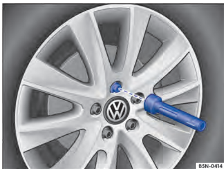
Fig. 213 Troca de roda: desaparafusar os parafusos de roda com o punho da chave de fenda.
