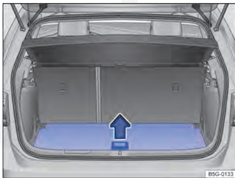
Fig. 100 No compartimento de bagagem: levantar o assoalho do compartimento de bagagem variável.
