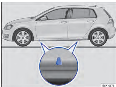
Fig. 208 Pontos de apoio do macaco.
