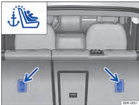
Fig. 77 Olhais de retenção para o cinto de fixação superior no lado de trás do banco traseiro.
