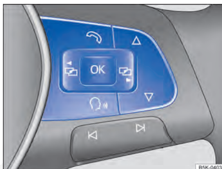
Fig. 15 Lado direito do volante multifunções: botões para comando dos menus e exibições de informação do instrumento combinado.
