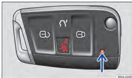
Fig. 23 Luz de controle da chave do veículo com botão do alarme.
