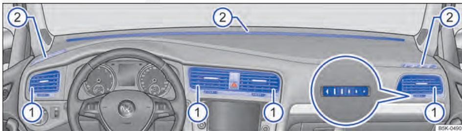
Fig. 170 No painel de instrumentos: difusores de ar.
