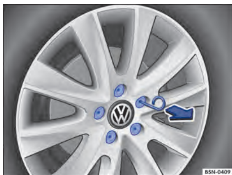
Fig. 206 Remover as capas de cobertura dos parafusos de roda.
