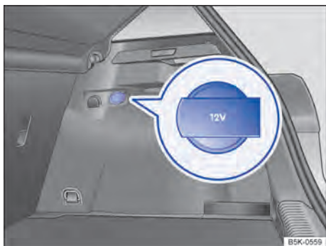
Fig. 116 No compartimento de bagagem: tomada 12 V.
