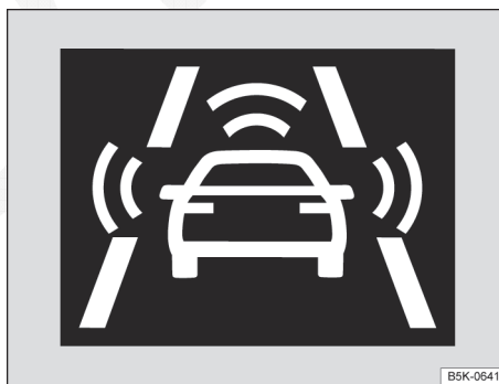
Fig. 162 No display do instrumento combinado: exibição do alerta antecipado.
