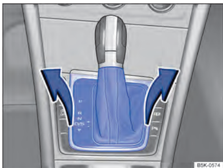
Fig. 200 Desinstalar a cobertura do quadro da alavanca seletora.
