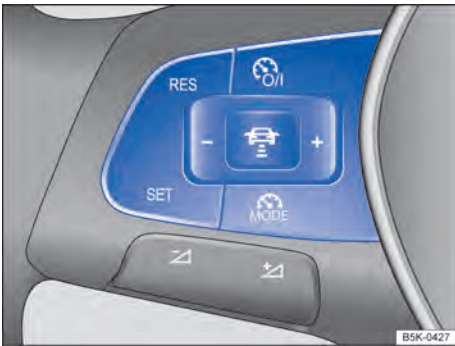
Fig. 158 Lado esquerdo do volante multifunções: botões para comandar a regulação automática de distância.
