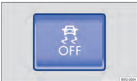
Fig. 129 Na parte inferior do console central: botão para desligar e ligar manualmente o ASR, ASR com ESC ou ESC Sport.
