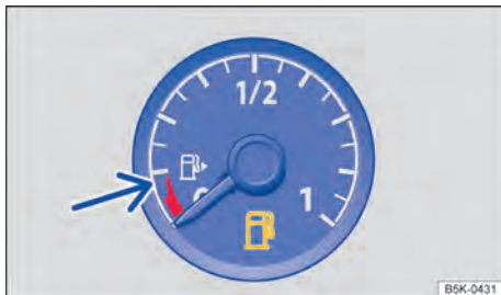
Fig. 171 No instrumento combinado: indicador do nível de combustível para gasolina.
