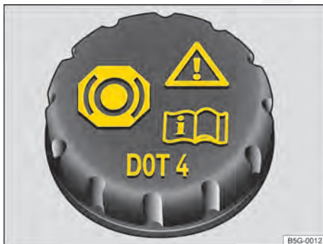
Fig. 130 No compartimento do motor: Tampa do reservatório de fluido de freio (versão 1).
