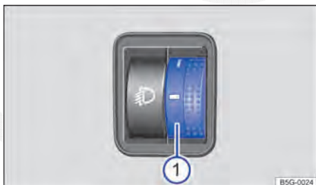
Fig. 80 Ao lado do volante: regulador da regulagem de alcance do farol
