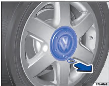
Fig. 204 Retirar a calota central.
