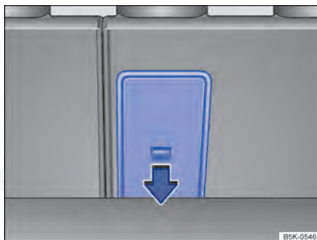
Fig. 95 No compartimento de bagagem: abrir o dispositivo para transporte de objetos longos.
