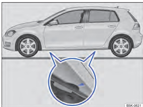
Fig. 210 Pontos de apoio do macaco.
