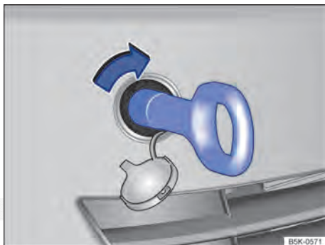
Fig. 233 No para-choque dianteiro à direita: rosquear a argola de reboque.
