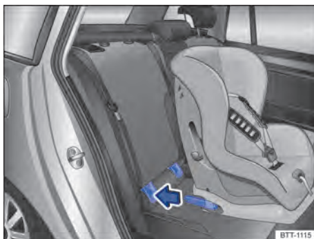
Fig. 76 Representação esquemática: instalar a cadeira de criança ISOFIX com os braços de apoio.
