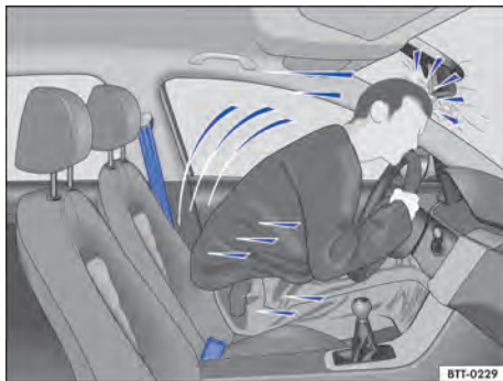
Fig. 58 O condutor sem cinto de segurança é lançado para frente.
