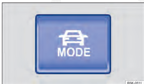
Fig. 167 Na parte inferior do console central: botão de seleção do perfil de condução.
