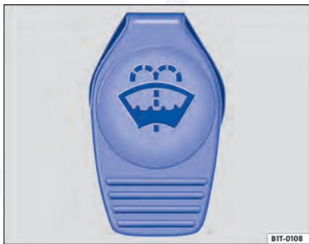
Fig. 88 No compartimento do motor: tampa do reservatório de água dos lavadores dos vidros.
