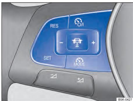
**Fig. 156** Lado esquerdo do volante multifunções: botões para comandar a regulagem automática de distância.
