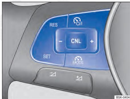
**Fig. 151** Lado esquerdo do volante multifunções: botões para comandar o limitador de velocidade.
