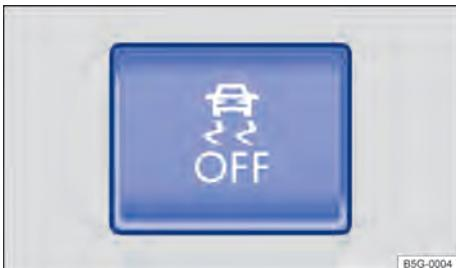
**Fig. 129** Na parte inferior do console central: botão para desligar e ligar manualmente o ASR, ASR com ESC ou ESC Sport.
