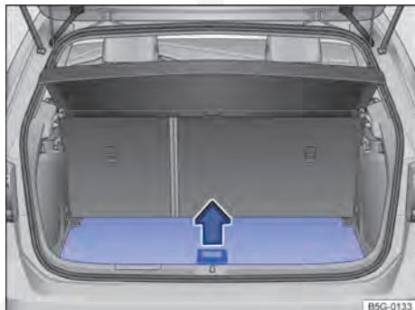
Fig. 100 No compartimento de bagagem: levantar o fundo do compartimento de bagagem variável.
