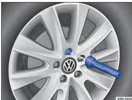
**Fig. 211** Troca de roda: desaparafusar os parafusos de roda com o punho da chave de fenda.
