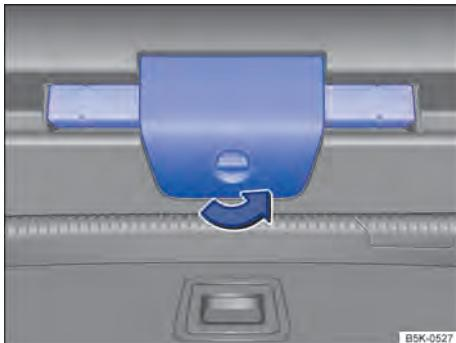
**Fig. 196** Na tampa traseira: abrir o suporte do triângulo de segurança.
