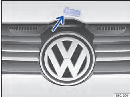
Fig. 172 Alavanca de destravamento para abrir a tampa do compartimento do motor na grade do radiador.
