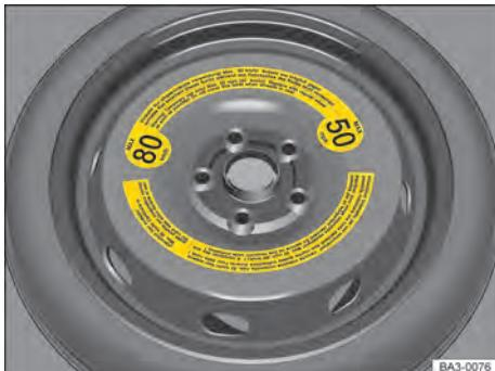
**Fig. 186** No compartimento de bagagem: roda de emergência.
