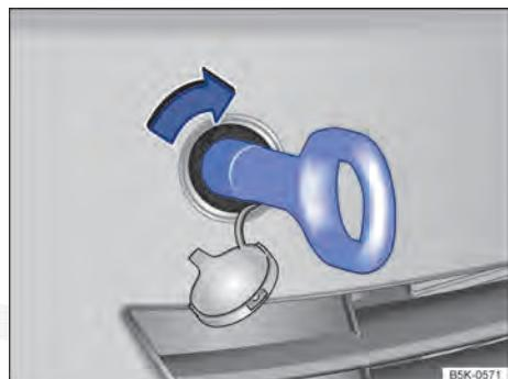
Fig. 229 No para-choque dianteiro à direita: rosquear a argola de reboque.
