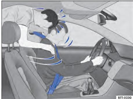
**Fig. 59** O passageiro sem cinto de segurança no banco traseiro é lançado para frente sobre o condutor com cinto de segurança.
