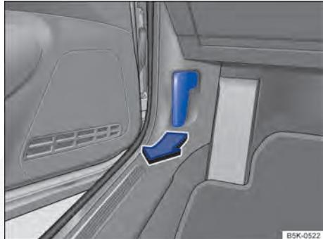
Fig. 171 No área para os pés no lado do condutor: alavanca de destravamento da tampa do compartimento do motor.
