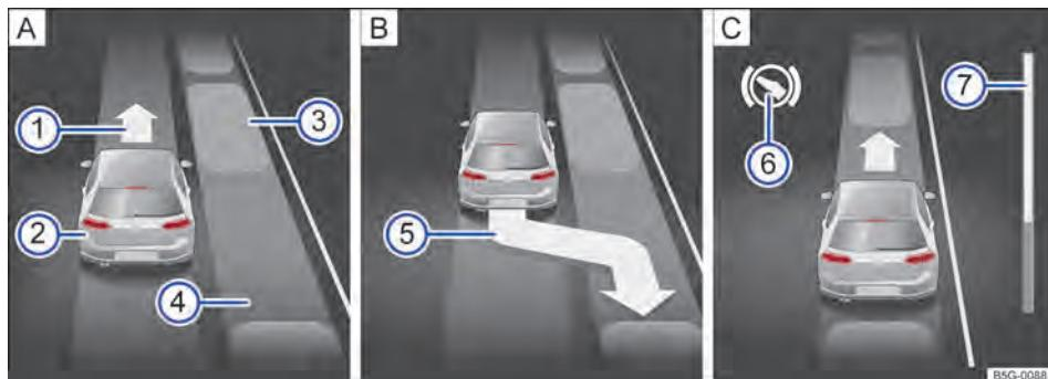
**Fig. 143** No display do instrumento combinado: entrar na vaga de estacionamento paralelo à pista. **A** Procurar vaga de estacionamento, **B** posição em relação à entrada na vaga de estacionamento, **C** manobrar.
