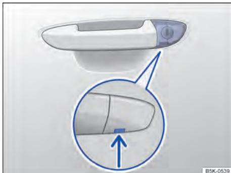
**Fig. 193 Maçaneta na porta do condutor: cilindro da fechadura coberto.**
