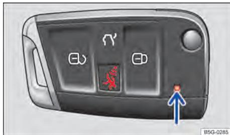
**Fig. 23** Luz de controle da chave do veículo com botão de alarme.
