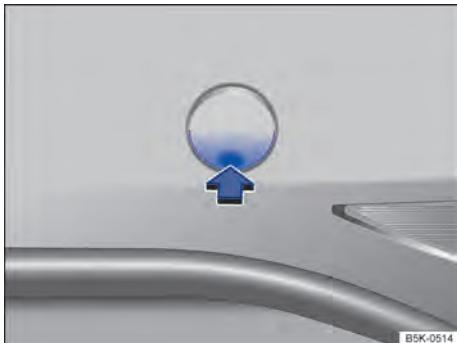
Fig. 230 No para-choque traseiro à direita: retirar a cobertura.
