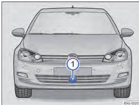
Fig. 161 No para-choque dianteiro: sensor do radar.
