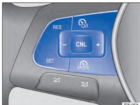
**Fig. 148** Lado esquerdo do volante multifunções: botões para comandar o GRA.
