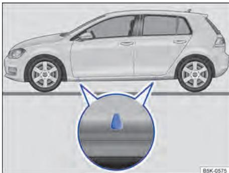
Fig. 206 Pontos de apoio do macaco.
