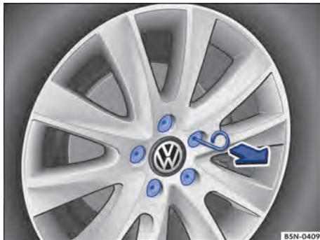
Fig. 204 Remover as capas de cobertura dos parafusos de roda.
