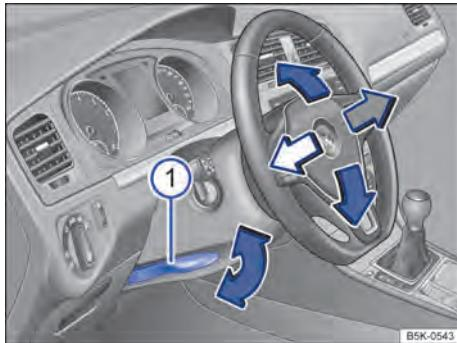
Fig. 50 Ajustar a posição do volante mecanicamente.
