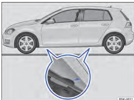
Fig. 208 Pontos de apoio do macaco.
