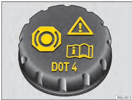
Fig. 130 No compartimento do motor: tampa do reservatório do fluido de freio.
