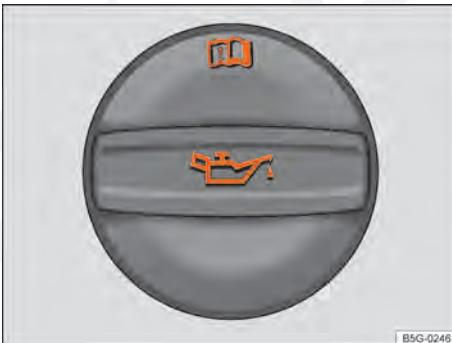
Fig. 174 No compartimento do motor: tampa da abertura para enchimento de óleo do motor.
