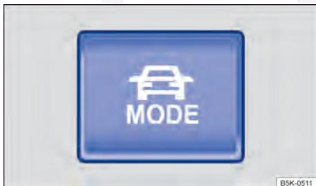
Fig. 165 Na parte inferior do console central: botão de seleção do perfil de condução.
