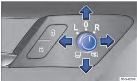
**Fig. 91** Na porta do condutor: botão giratório dos espelhos retrovisores externos.
