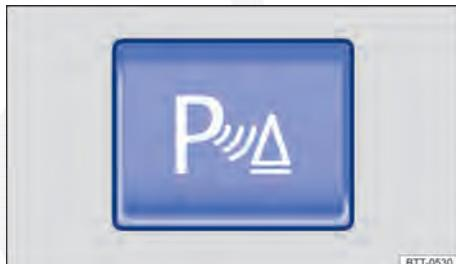
Fig. 134 Na parte inferior do console central: botão para ligar e desligar o Park Pilot.
