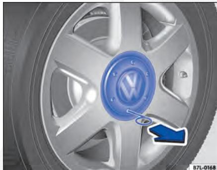
Fig. 202 Retirar a calota central.
