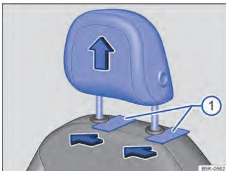
Fig. 47 Desinstalar o apoio para cabeça dianteiro.
