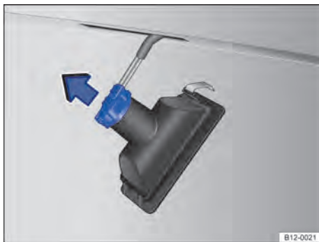
Fig. 160 Lanterna da placa de licença: remover o suporte da lâmpada.
