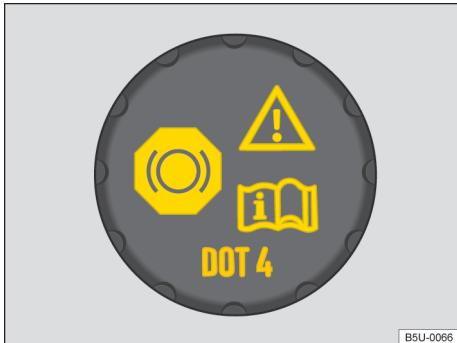
Fig. 132 No compartimento do motor: tampa do reservatório de fluido de freio.
