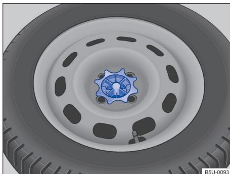
**Fig. 139** No compartimento de bagagem: manípulo para fixação da roda de emergência.
