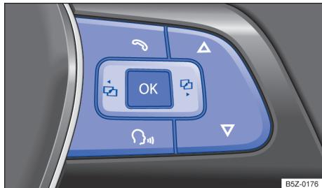
**Fig. 20** Lado direito do volante multifunções: teclas de comando dos menus do instrumento combinado.
