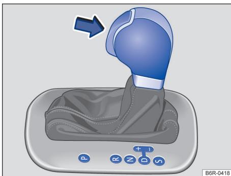
**Fig. 84** Alavanca seletora da transmissão automática com botão bloqueador (seta).
