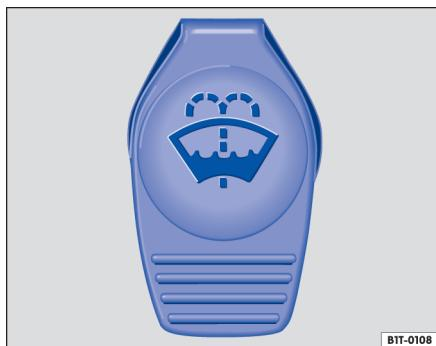
**Fig. 127** No compartimento do motor: tampa do reservatório de água dos lavadores dos vidros.
