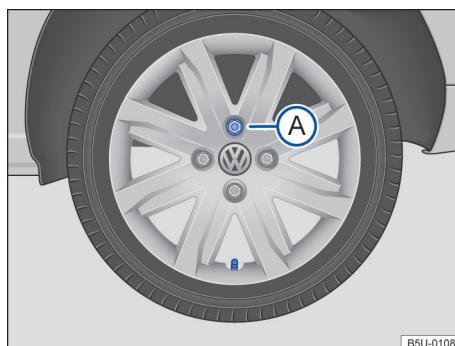
Fig. 142 Retirar a supercalota.
