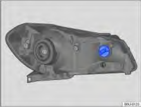
Fig. 175 No compartimento do motor: localização da lâmpada incandescente do indicador de direção dianteiro.
