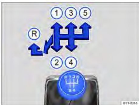
Fig. 100 Esquema de troca da transmissão manual de 5 marchas.
