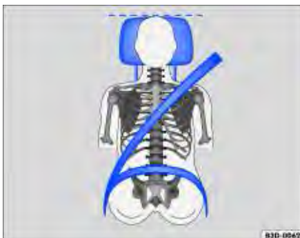
Fig. 37 Posição correta do cadarço do cinto de segurança e ajuste correto do apoio para cabeça.
