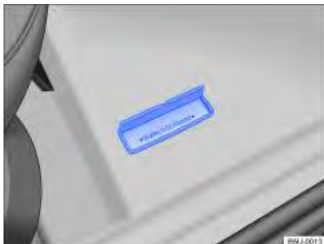
Fig. 19 Em frente ao banco do passageiro dianteiro: número de identificação do veículo (número do chassi) no assoalho, em frente ao banco do passageiro dianteiro.
