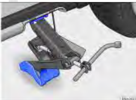
Fig. 163 Pontos de apoio do macaco e macaco posicionado no lado esquerdo traseiro do veículo - veículos com soleiras externas.
