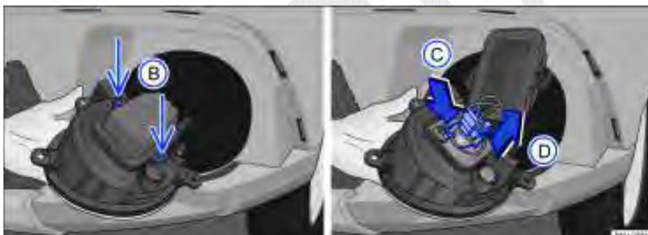
Fig. 185 Remover a cobertura para acesso da lâmpada e acesso à lâmpada do farol de neblina.
