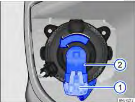
Fig. 187 Trocar a lâmpada incandescente do farol de neblina.
