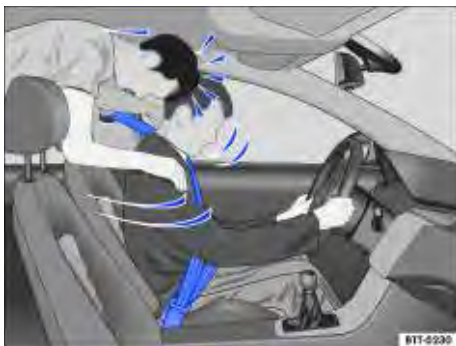
Fig. 48 O passageiro sem cinto de segurança no banco traseiro é lançado para frente sobre o condutor com cinto de segurança.
