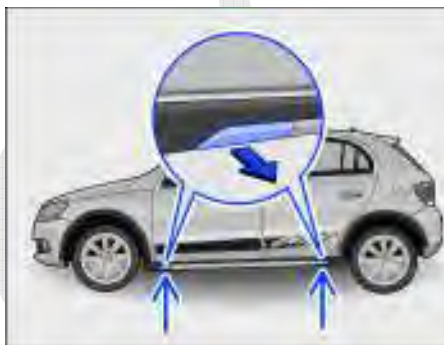
Fig. 163 Pontos de apoio do macaco e macaco posicionado no lado esquerdo traseiro do veículo - veículos com soleiras externas.
