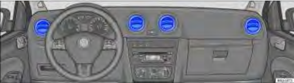
Fig. 119 Difusores de ar no painel de instrumentos.
