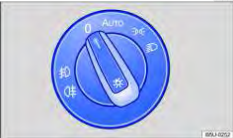
Fig. 65 No painel: interruptor giratório das luzes.
