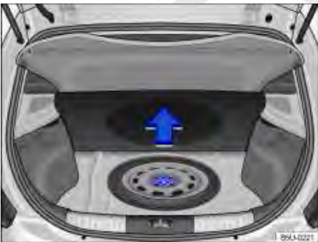
Fig. 155 No compartimento de bagagem, sob o revestimento de assoalho: roda de emergência e ferramentas de bordo.
