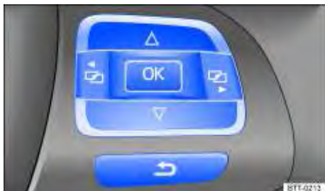
Fig. 14 Lado direito do volante multifunções: teclas de comando dos menus do instrumento combinado.
