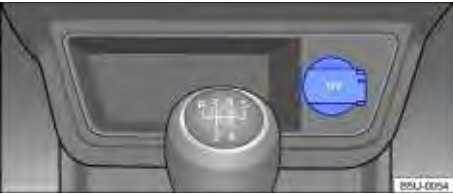
Fig. 94 No console central dianteiro: tomada 12 V.
