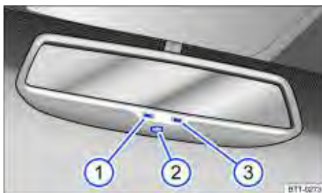
Fig. 73 No para-brisa: espelho retrovisor interno com antiofuscante automático.
