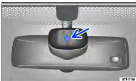
Fig. 70 No para-brisa: superfície sensível do sensor de chuva.
