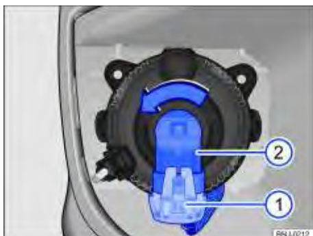
Fig. 186 Trocar a lâmpada incandescente do farol de neblina.
