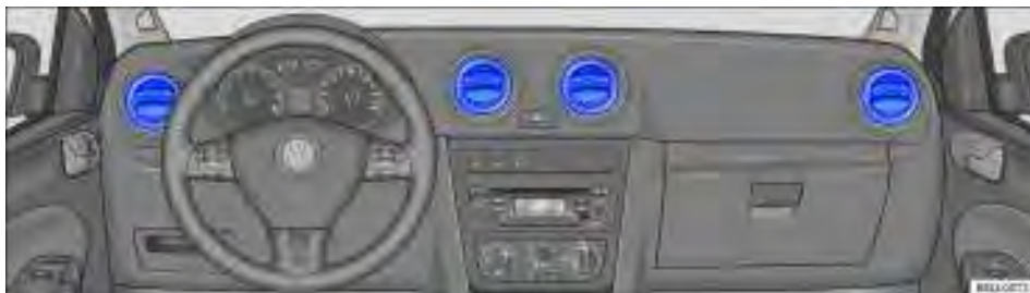
Fig. 118 Difusores de ar no painel de instrumentos.
