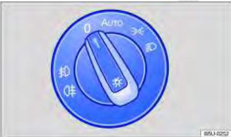
Fig. 64 No painel: interruptor giratório das luzes.
