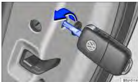
Fig. 154 Travamento de emergência do veículo com a chave do veículo.
