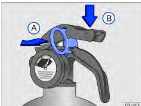
Fig. 150 Sequência de utilização do extintor de incêndio.
