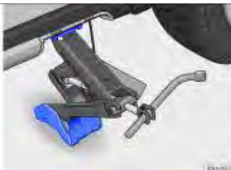
Fig. 162 Pontos de apoio do macaco e macaco posicionado no lado esquerdo traseiro do veículo - veículos com soleiras externas.
