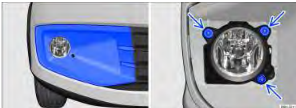
Fig. 185 No para-choque dianteiro: desinstalar o farol de neblina.
