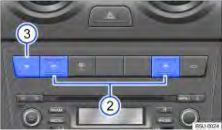
Fig. 34 No console central: teclas dos vidros elétricos traseiros.
