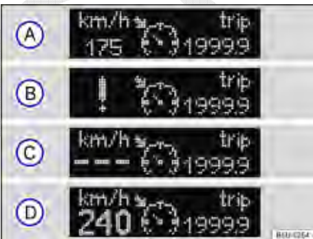
Fig. 114 No display do instrumento combinado: indicadores de status do GRA.
