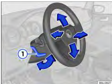
Fig. 42 Ajustar a posição do volante mecanicamente.
