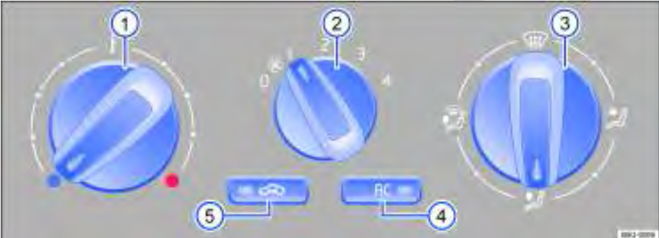
Fig. 117 No console central: comandos do ar-condicionado.
