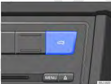
Fig. 31 Na parte superior do console central: tecla de abertura da tampa traseira.
