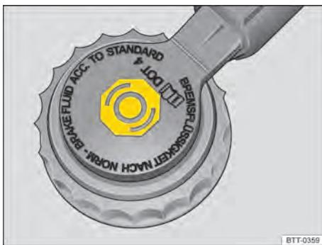
**Fig. 116** No compartimento do motor: tampa do reservatório do fluido de freio.
