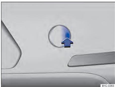
**Fig. 201** No para-choque traseiro à direita: retirar a cobertura.
