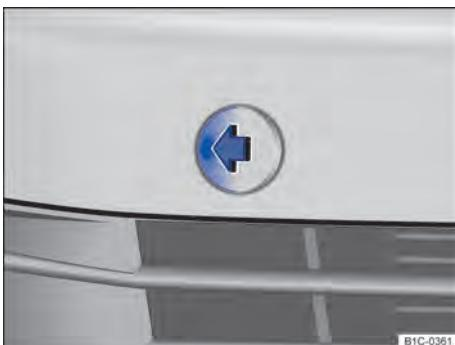
**Fig. 199** No para-choque dianteiro à direita: retirar a cobertura.
