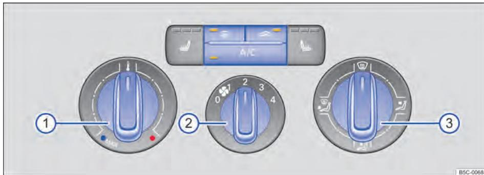
Fig. 133 No console central: comandos do ar-condicionado (manual).
