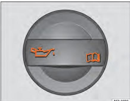
Fig. 142 No compartimento do motor: tampa da abertura para enchimento de óleo do motor.
