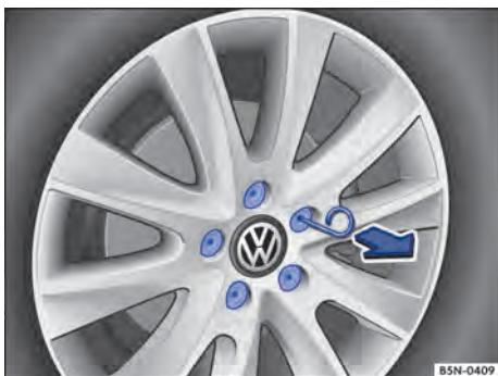
**Fig. 172** Remover as capas de cobertura dos parafusos de roda.
