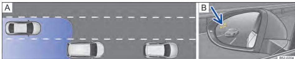
Fig. 129 Representação esquemática: A: situação de condução ao ultrapassar com o trânsito traseiro. B: indicador do sensor Blind Spot no espelho retrovisor externo esquerdo.
