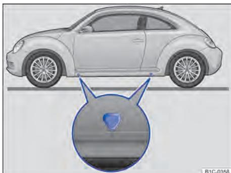
Fig. 175 Pontos de apoio do macaco.
