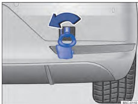
**Fig. 204** No para-choque traseiro à direita: rosquear a argola de reboque.
