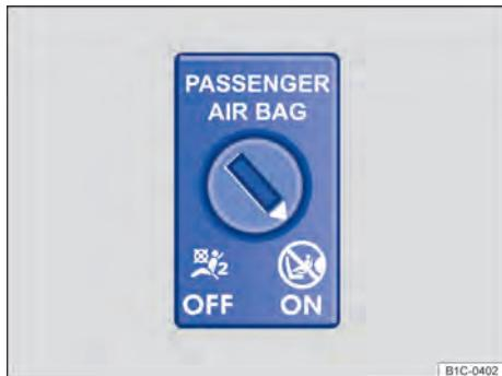
**Fig. 67** Ao lado do painel de instrumentos no lado do passageiro: interruptor acionado pela chave para desligar e ligar o airbag frontal do passageiro dianteiro.
