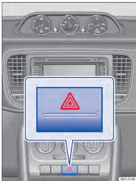
**Fig. 158** Na parte superior do console central: interruptor das luzes de advertência.
