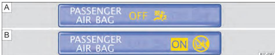
**Fig. 64** Luz de controle parte superior do console central: variante A para o airbag frontal do passageiro dianteiro desligado, variante B para o airbag frontal do passageiro dianteiro ligado.
