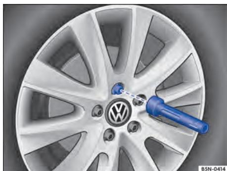
**Fig. 177** Troca de roda: desaparafusar os parafusos de roda com o punho da chave de fenda.
