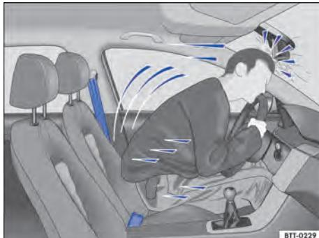
**Fig. 57** O condutor sem cinto de segurança é lançado para frente.
