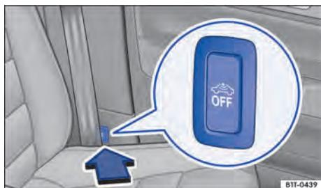
Fig. 31 Ao lado do banco do condutor: botão para desligar o monitoramento do interior do veículo e o alarme antirrebocagem.
