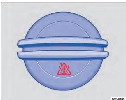
**Fig. 144** No compartimento do motor: tampa do reservatório de expansão do líquido de arrefecimento do motor.
