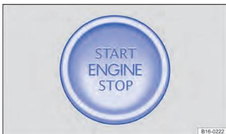
**Fig. 106** No console central: botão de partida do sistema de travamento e de partida Keyless Access.
