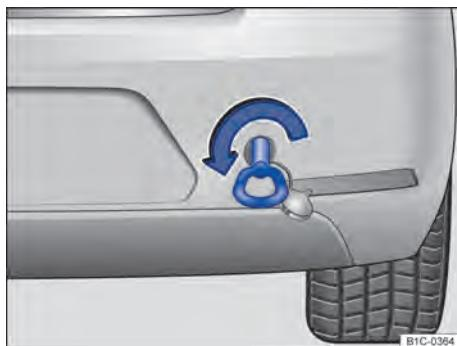
**Fig. 202** No para-choque traseiro à direita: rosquear a argola de reboque.
