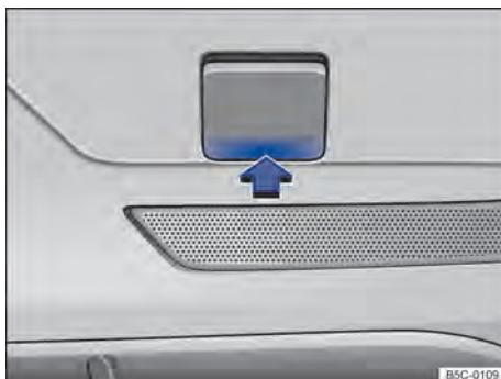
**Fig. 203** No para-choque traseiro à direita: retirar a cobertura.
