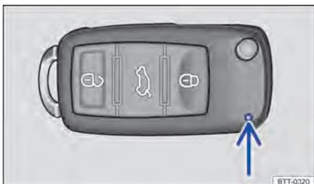
Fig. 23 Luz de controle da chave do veículo.
