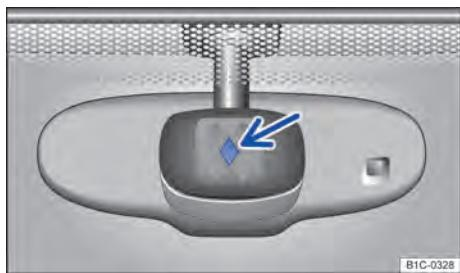
**Fig. 83** No para-brisa acima do espelho retrovisor interno: superfície sensível do sensor de chuva e de luz.
