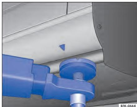
Fig. 156 Pontos de apoio dianteiros para a suspensão com plataforma elevatória ou com macaco.
