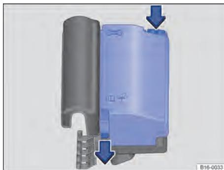
**Fig. 180** No compartimento do motor: cobertura da caixa de fusíveis.
