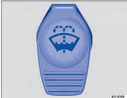
**Fig. 84** No compartimento do motor: tampa do reservatório de água dos lavadores do para-brisa.
