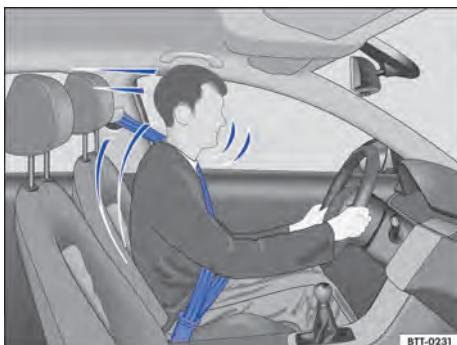
**Fig. 59** Condutor protegido pelo cinto de segurança colocado corretamente em uma manobra de frenagem súbita.
