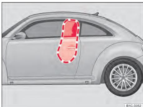
Fig. 69 Área de expansão do airbag para cabeça e lateral combinado.
