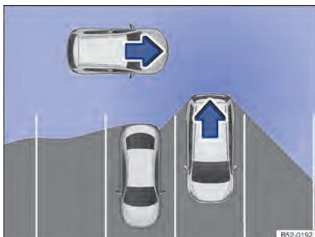
**Fig. 131** Representação esquemática do assistente de saída de vaga de estacionamento: área monitorada ao redor do veículo.
