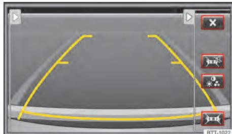
Fig. 124 Exibição do display do rádio ou do sistema de navegação: câmera de marcha a ré ligada.
