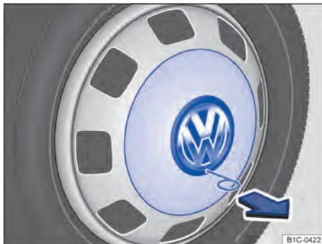
Fig. 171 Retirar a calota integral. (variante 2)
