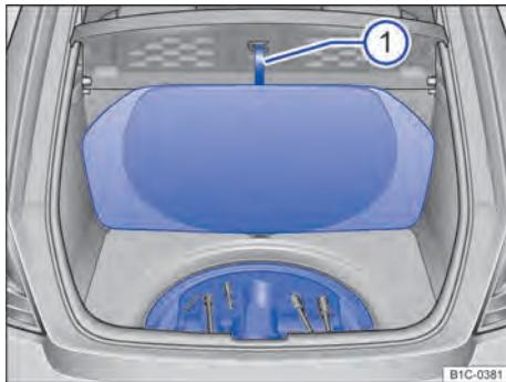
Fig. 166 No compartimento de bagagem: revestimento do assoalho rebaixado para cima e pendurado ①.
