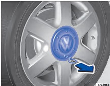
Fig. 168 Retirar a calota central.
