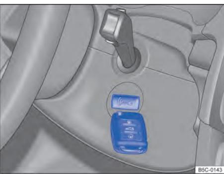
**Fig. 107** Na coluna de direção: função de partida de emergência em veículos com Keyless Access.
