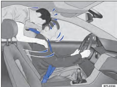
**Fig. 58** O passageiro sem cinto de segurança no banco traseiro é lançado para frente sobre o condutor com cinto de segurança.
