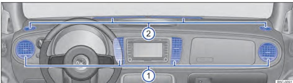
Fig. 136 Difusores de ar no painel de instrumentos.
