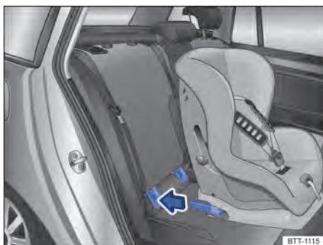
Fig. 73 Representação esquemática: instalar a cadeira de criança ISOFIX com os braços de apoio.
