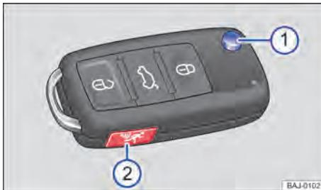
Fig. 22 Chave do veículo com botão do alarme.
