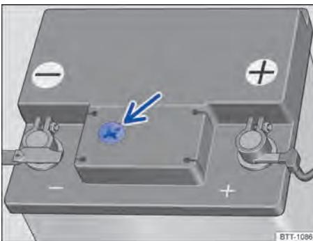
Fig. 146 Representação esquemática: visor no lado superior da bateria do veículo.
