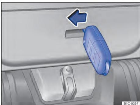
**Fig. 163** No compartimento de bagagem: destraravar a tampa traseira.
