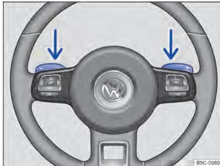
Fig. 114 Volante com 2 seletores basculantes do Tiptronic.
