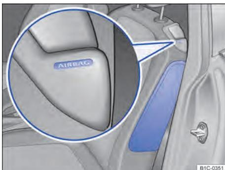
Fig. 68 Lateralmente no assento dianteiro: local de montagem do airbag combinado para a cabeça e lateral.
