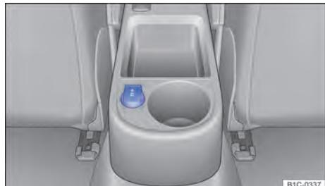
Fig. 104 Tomada 12 V no console central traseiro. ►
