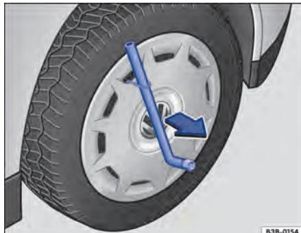
Fig. 170 Retirar a calota integral. (variante 1)
