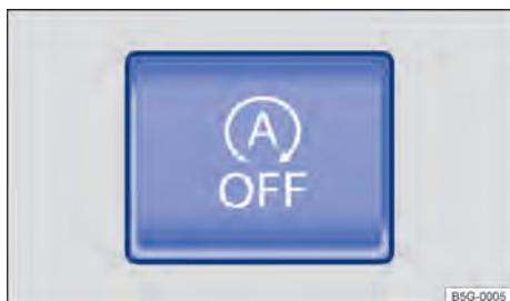
**Fig. 118** No console central: botão do sistema Start-Stop.
