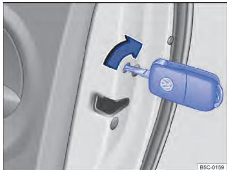
**Fig. 162** Na parte dianteira da porta do passageiro dianteiro: travamento de emergência do veículo com a chave do veículo.
