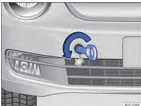
**Fig. 200** No para-choque dianteiro à direita: rosquear a argola de reboque.
