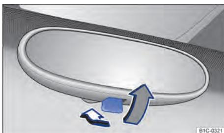
Fig. 86 No para-brisa: eselho retrovisor interno com antifuscante manual.
