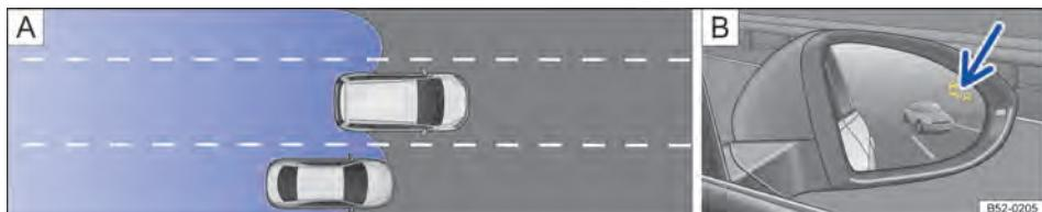
Fig. 130 Representação esquemática: A: situação de condução ao ultrapassar e mudar frequentemente de faixa. B: indicador do sensor Blind Spot no espelho retrovisor externo direito.
