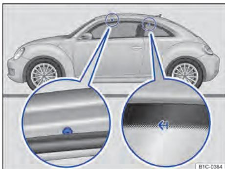
Fig. 92 Pontos de fixação dos suportes de base e bagageiro do teto.
