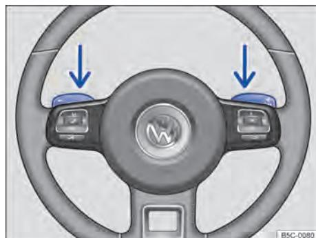
**Fig. 113** Volante com 2 seletores basculantes do Tiptronic.
