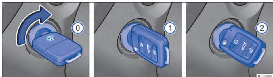
Fig. 104 Posições da chave do veículo no cilindro da ignição.
