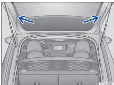
**Fig. 88** No compartimento de bagagem: desprender e prender as cintas de fixação da cobertura do compartimento de bagagem na tampa traseira.
