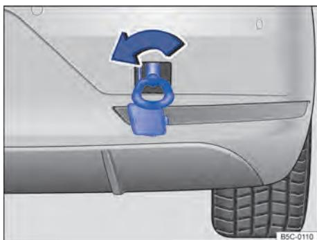
**Fig. 196** No para-choque traseiro à direita: rosquear a argola de reboque.
