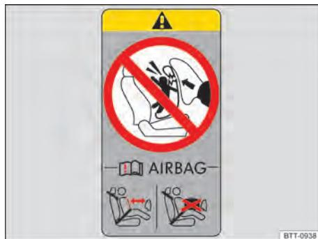
Fig. 70 Na coluna B do lado do passageiro dianteiro: etiqueta adesiva do airbag.
