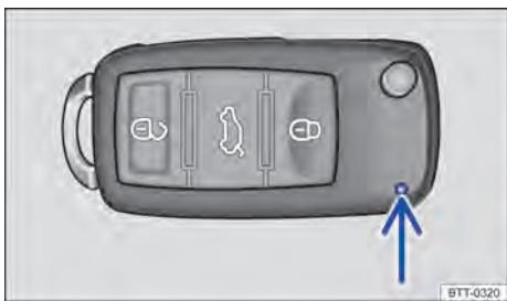
Fig. 23 Luz de controle da chave do veículo.
