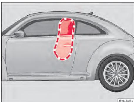
Fig. 67 Área de expansão do airbag para cabeça e lateral combinado.
