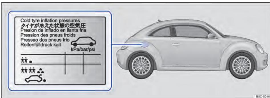
Fig. 142 Do lado interno da portinhola do tanque: etiqueta de pressão dos pneus.
