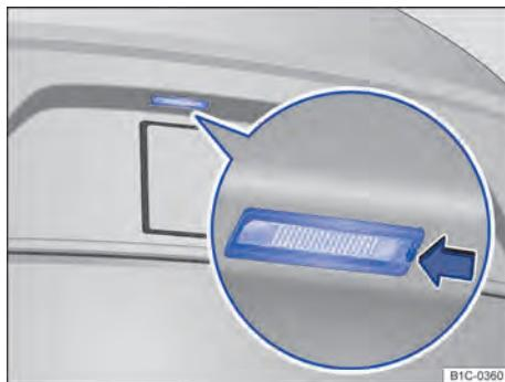
Fig. 187 No para-choque traseiro: lanterna da placa de licença.
