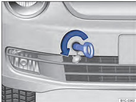
**Fig. 192** No para-choque dianteiro à direita: rosquear a argola de reboque.
