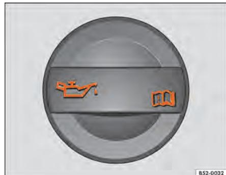
Fig. 136 No compartimento do motor: tampa da abertura para enchimento de óleo do motor.
