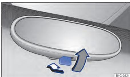
Fig. 85 Espelho retrovisor interno com antifuscante manual.
