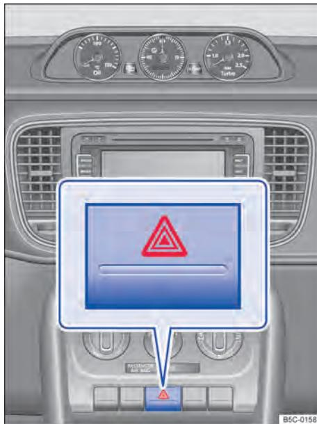
Fig. 150 Na parte superior do console central: interruptor das luzes de advertência.
