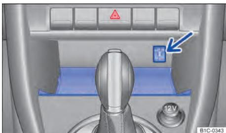
Fig. 93 Na parte inferior do console central: porta-objetos.
