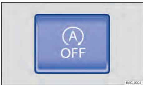
**Fig. 117** No console central: botão do sistema Start-Stop.
