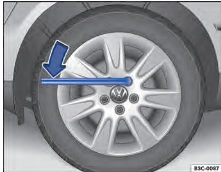
Fig. 165 Troca de roda: soltar os parafusos de roda.
