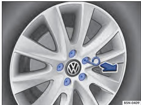
**Fig. 164** Remover as capas de cobertura dos parafusos de roda.
