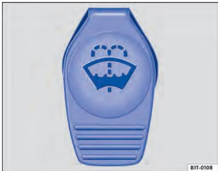
**Fig. 83** No compartimento do motor: tampa do reservatório de água dos lavadores do para-brisa.
