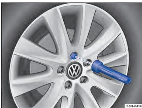
**Fig. 169** Troca de roda: desaparafusar os parafusos de roda com o punho da chave de fenda.
