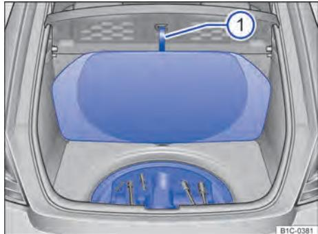
Fig. 158 No compartimento de bagagem: revestimento do assoalho rebatido para cima e pendurado ①.
