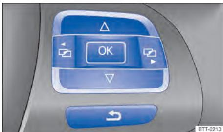
**Fig. 17** Lado direito do volante multifunções: botões para comandar os menus do instrumento combinado.
