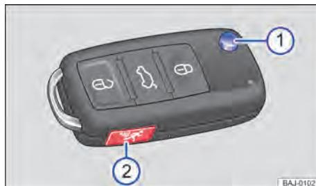
Fig. 22 Chave do veículo com botão do alarme.
