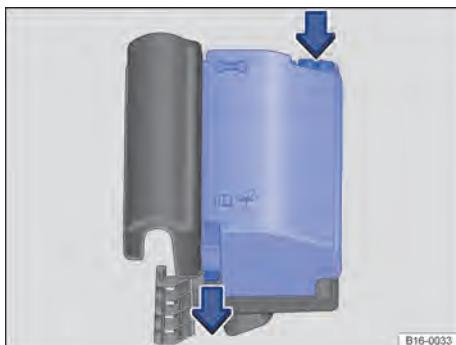
**Fig. 172** No compartimento do motor: cobertura da caixa de fusíveis.
