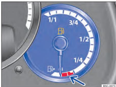
**Fig. 131** No instrumento combinado: indicador do nível de combustível para gasolina e óleo diesel.
