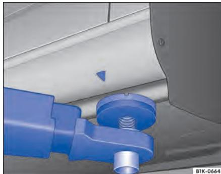
Fig. 148 Pontos de apoio dianteiros para a suspensão com plataforma elevatória ou com macaco.
