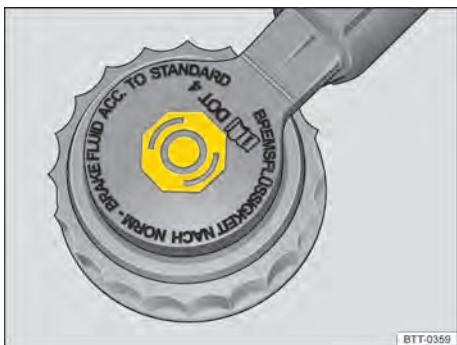
**Fig. 115** No compartimento do motor: tampa do reservatório do fluido de freio.
