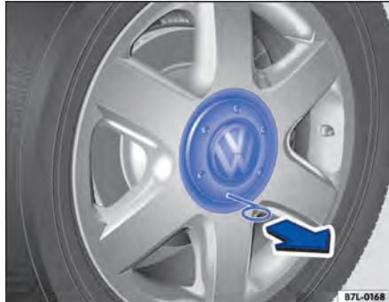
Fig. 160 Retirar a calota central.
