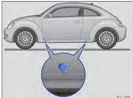
Fig. 167 Pontos de apoio do macaco.
