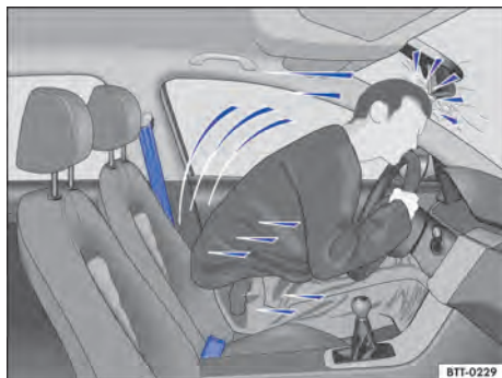
Fig. 55 O condutor sem cinto de segurança é lançado para frente.
