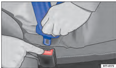
Fig. 59 Soltar a lingueta do cinto de segurança do fecho do cinto de segurança.
