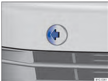
Fig. 190 No para-choque dianteiro à direita: retirar a cobertura.
