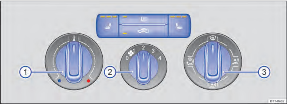
Fig. 128 No console central: regulador rotativo do sistema de ventilação e aquecimento com comandos.
