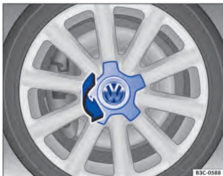
Fig. 160 Virar a calota central.
