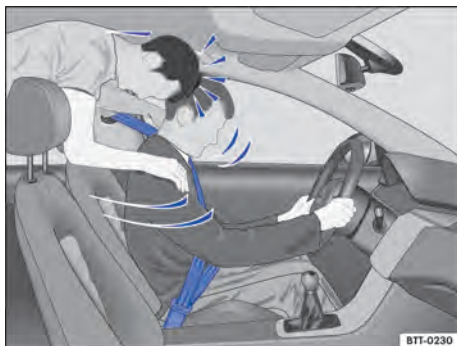
Fig. 56 O passageiro sem cinto de segurança no banco traseiro é lançado para frente sobre o condutor com cinto de segurança.
