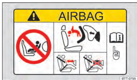
Fig. 69 No para-sol do lado do passageiro dianteiro: etiqueta adesiva do airbag.
