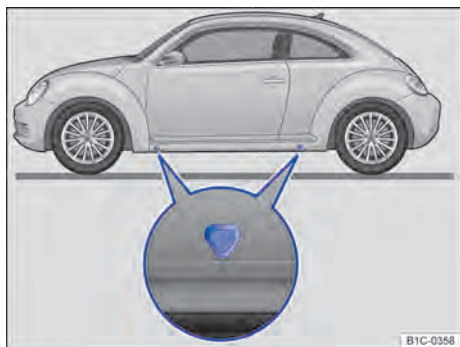
Fig. 166 Pontos de apoio do macaco.
