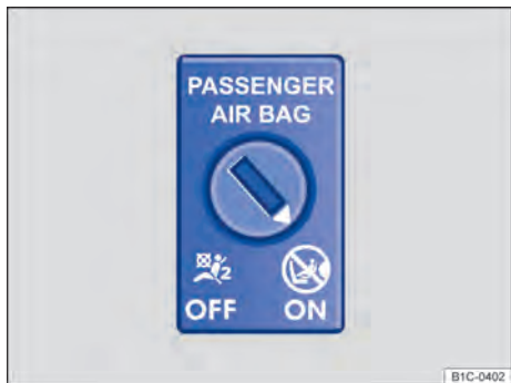
Fig. 65 Ao lado do painel de instrumentos no lado do passageiro: interruptor acionado pela chave para desligar e ligar o airbag frontal do passageiro dianteiro.
