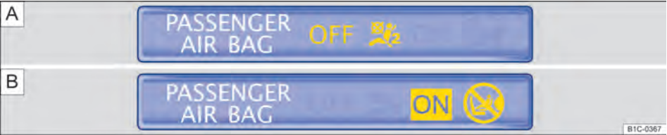
Fig. 62 Luz de controle parte superior do console central: variante A para o airbag frontal do passageiro dianteiro desligado, variante B para o airbag frontal do passageiro dianteiro ligado.
