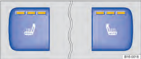
Fig. 49 No console central: botões do aquecimento dos bancos dianteiros (variante 1).
