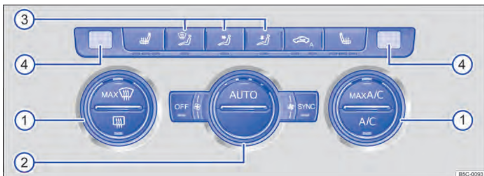
Fig. 127 No console central: comandos do Climatronic.
