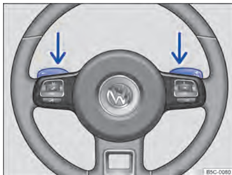
Fig. 112 Volante com 2 seletores basculantes do Tiptronic.
