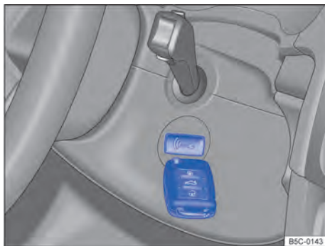
Fig. 105 Na coluna de direção: função de partida de emergência em veículos com Keyless Access.
