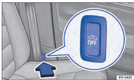
Fig. 31 Ao lado do banco do condutor: botão para desligar o monitoramento do interior do veículo e o alarme antirrebocagem.
