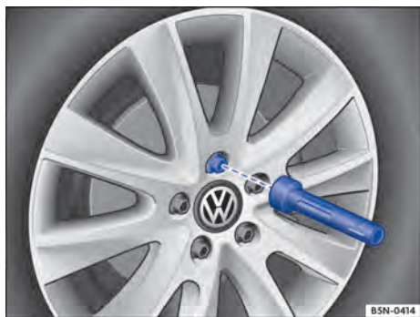
Fig. 168 Troca de roda: desaparafusar os parafusos de roda com o punho da chave de fenda.
