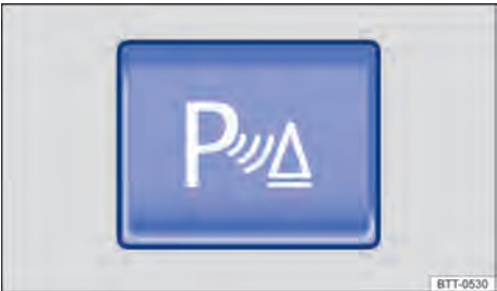
Fig. 118 No console central: botão para ligar e desligar o Park Pilot.
