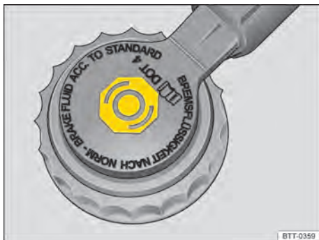
Fig. 114 No compartimento do motor: tampa do reservatório do fluido de freio.
