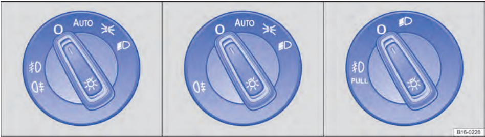
Fig. 74 Ao lado do volante: representação de algumas variantes do interruptor das luzes.
