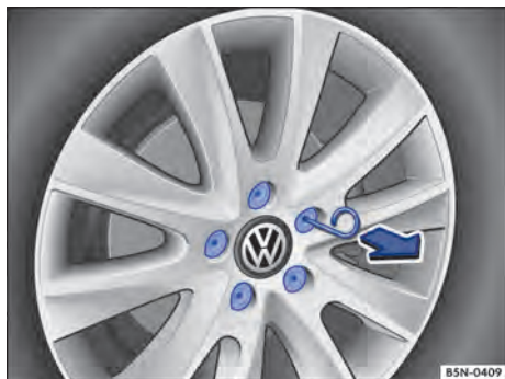
Fig. 163 Remover as capas de cobertura dos parafusos de roda.
