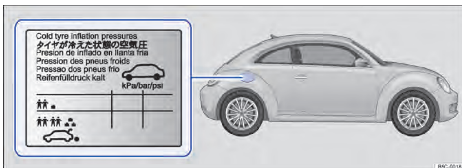
Fig. 141 Do lado interno da portinhola do tanque: etiqueta de pressão dos pneus.
