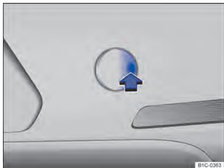
Fig. 192 No para-choque traseiro à direita: retirar a cobertura.
