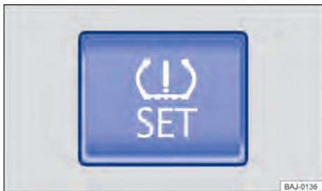
Fig. 125 No porta-luvas inferior: botão do indicador de controle dos pneus.
