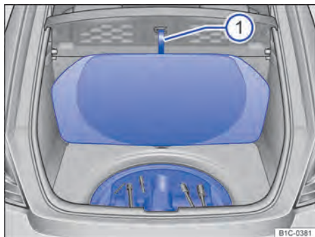
Fig. 157 No compartimento de bagagem: revestimento do assoalho rebatido para cima e pendurado ①.
