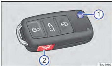
Fig. 22 Chave do veículo com botão do alarme.
