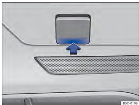
Fig. 194 No para-choque traseiro à direita: retirar a cobertura.
