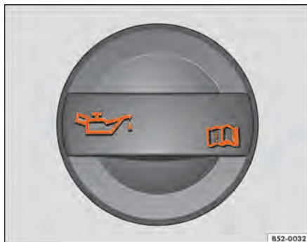
Fig. 135 No compartimento do motor: tampa da abertura para enchimento de óleo do motor.
