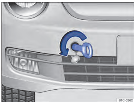
Fig. 191 No para-choque dianteiro à direita: rosquear a argola de reboque.
