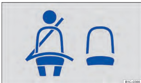
Fig. 52 Indicador de status do cinto de segurança no display do instrumento combinado para os assentos traseiros.
