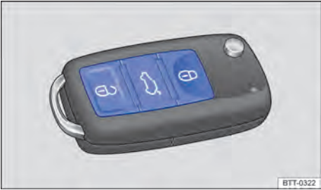
Fig. 26 Botões da chave do veículo.
