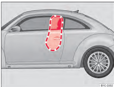
Fig. 67 Área de expansão do airbag combinado para a cabeça e lateral.
