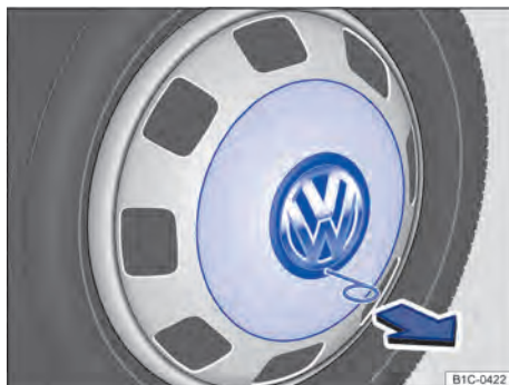
Fig. 162 Retirar a calota integral. (versão 2)
