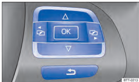
Fig. 17 Lado direito do volante multifunções: botões para comandar os menus do instrumento combinado.
