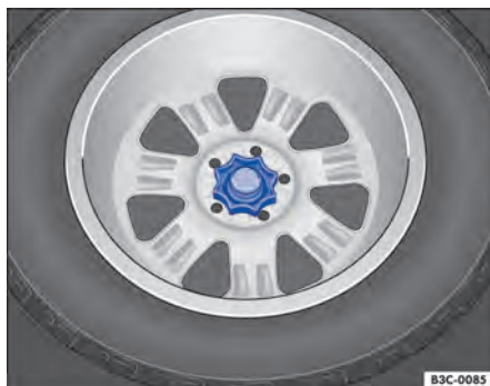
Fig. 143 No compartimento de bagagem: manípulo para fixação da roda sobressalente.
