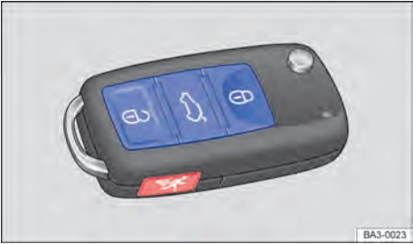
Fig. 27 Chave do veículo com botão do alarme.
