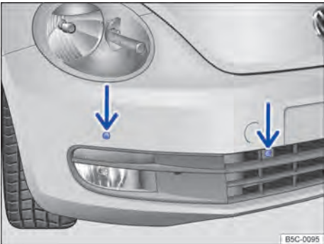
Fig. 117 No para-choque: sensores de ultrassom do Park Pilot.
