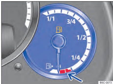
Fig. 130 No instrumento combinado: indicador do nível de combustível para gasolina e óleo diesel.
