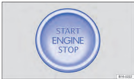
Fig. 104 No console central: botão de partida do sistema de fechamento e partida Keyless Access.
