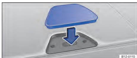
Fig. 146 No console central: fechar a abertura do alojamento do suporte de iPhone.
