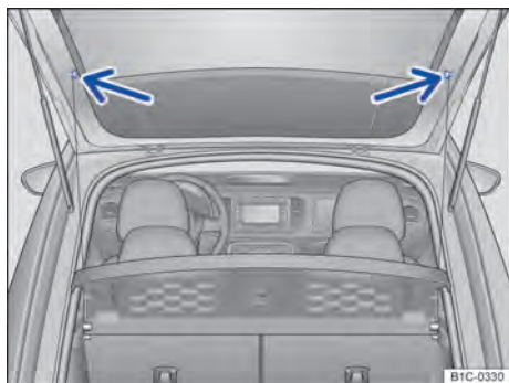
Fig. 87 No compartimento de bagagem: desprender e prender as cintas de fixação da cobertura do compartimento de bagagem na tampa traseira.
