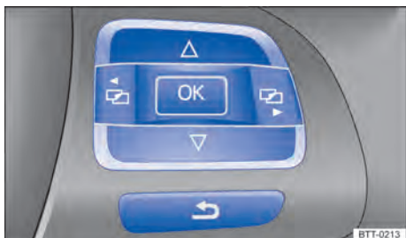
Fig. 14 Lado direito do volante multifunções: botões para comandar os menus do instrumento combinado.
