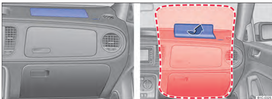
Fig. 59 Local de instalação e área de expansão do airbag frontal do passageiro dianteiro.
