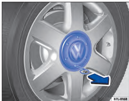
Fig. 159 Retirar a calota central.
