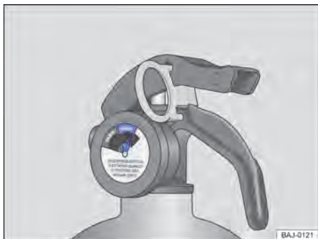
Fig. 151 No extintor de incêndio: indicador da pressão.
