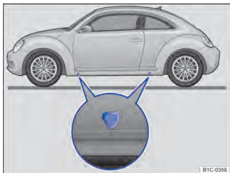
Fig. 166 Pontos de apoio do macaco.
