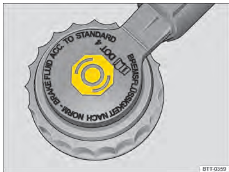
Fig. 112 No compartimento do motor: tampa do reservatório do fluido de freio.
