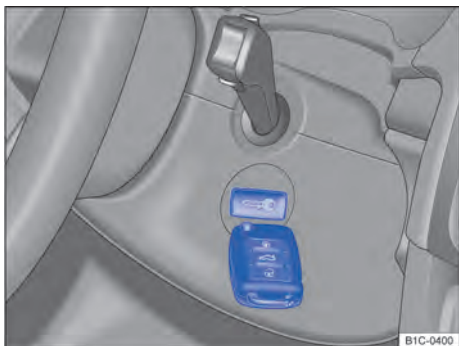
Fig. 103 Na coluna de direção: função de partida de emergência em veículos com Keyless Access.
