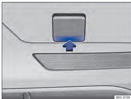
Fig. 195 No para-choque traseiro à direita: retirar a cobertura.
