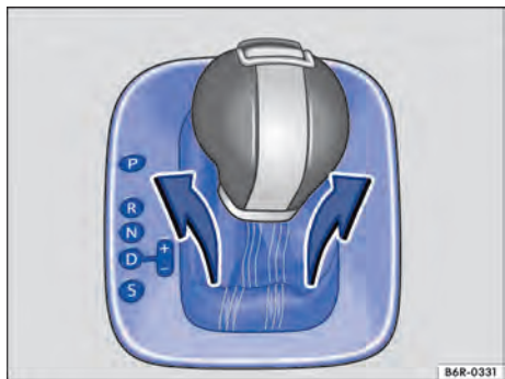
Fig. 155 Desmontar a cobertura do quadro da alavanca seletora.
