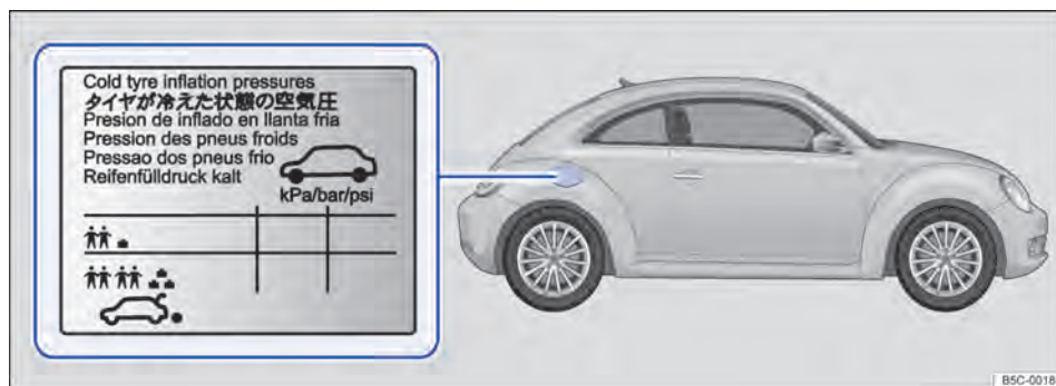
Fig. 139 Na portinhola do tanque: etiqueta da pressão dos pneus.
