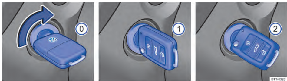
Fig. 101 Posições da chave do veículo no cilindro da ignição.
