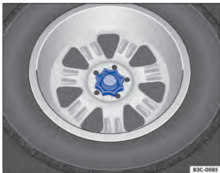
Fig. 141 No compartimento de bagagem: manípulo para fixação da roda sobressalente.
