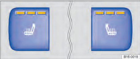
Fig. 46 No console central: botões do aquecimento dos bancos dianteiros (variante 1).
