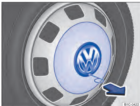
Fig. 162 Retirar a calota integral. (versão 2)
