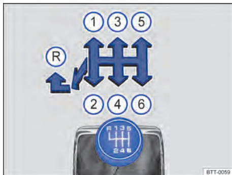
Fig. 107 Esquema de troca da transmissão manual de 6 marchas.
