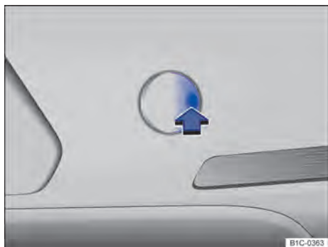
Fig. 193 No para-choque traseiro à direita: retirar a cobertura.
