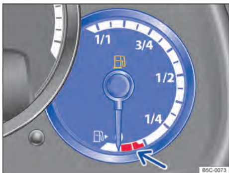
Fig. 127 No instrumento combinado: indicador do nível de combustível para gasolina e óleo diesel.
