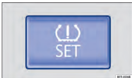
Fig. 122 No porta-luvas inferior: botão do indicador de controle dos pneus.
