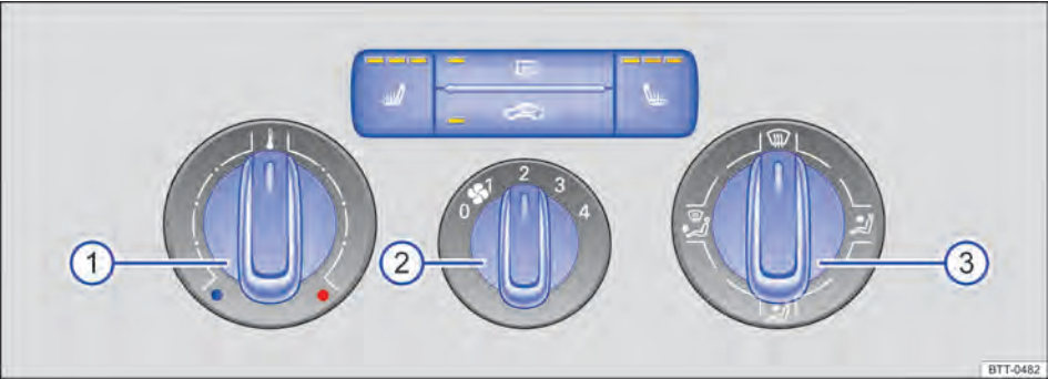
Fig. 125 No console central: regulador rotativo do sistema de ventilação e aquecimento com comandos.
