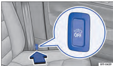
Fig. 28 Ao lado do banco do condutor: botão para desligar o monitoramento do interior do veículo e o alarme antirrebocagem.
