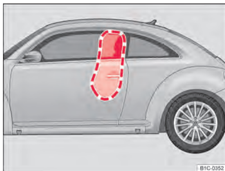
Fig. 61 Área de expansão do airbag lateral.
