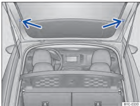
Fig. 84 No compartimento de bagagem: desprender e prender as cintas de fixação da cobertura do compartimento de bagagem na tampa traseira.
