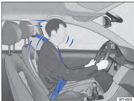
Fig. 53 Conductor protegido pelo cinto de segurança colocado corretamente em uma manobra de frenagem súbita.
