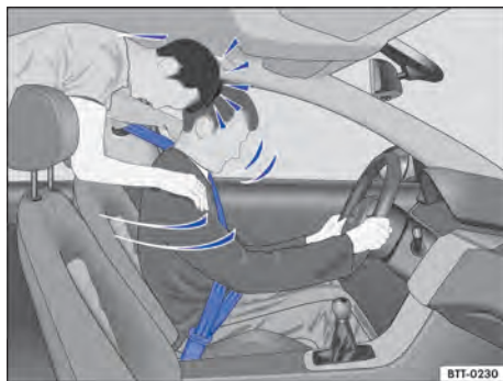
Fig. 52 O passageiro sem cinto de segurança no banco traseiro é lançado para frente sobre o condutor com cinto de segurança.
