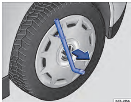
Fig. 161 Retirar a calota integral. (versão 1)
