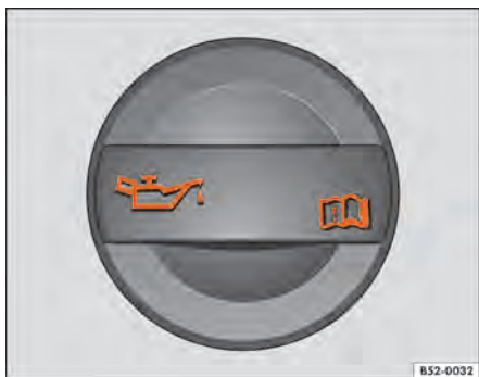
Fig. 132 No compartimento do motor: tampa da abertura para enchimento de óleo do motor.
