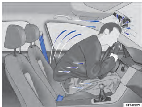
Fig. 51 O condutor sem cinto de segurança é lançado para frente.
