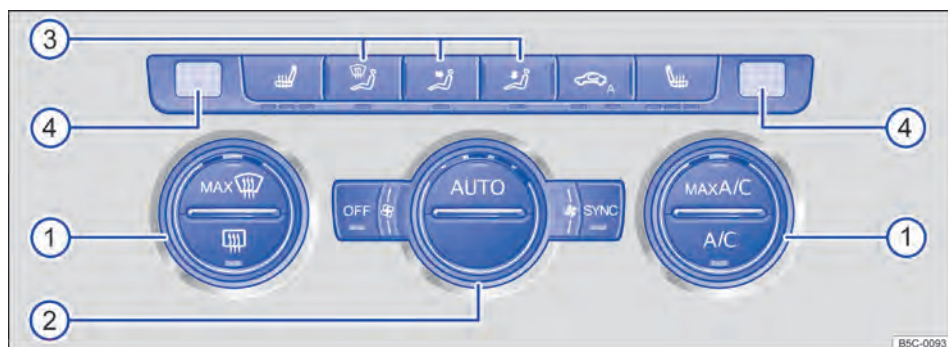
Fig. 124 No console central: comandos do Climatronic.
