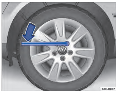
Fig. 164 Troca de roda: soltar os parafusos de roda.
