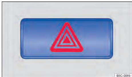
Fig. 145 No centro do painel de instrumentos: interruptor das luzes de advertência.
