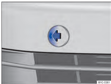
Fig. 191 No para-choque dianteiro à direita: retirar a cobertura.
