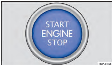
Fig. 102 No console central: botão de partida do sistema de fechamento e partida Keyless Access.
