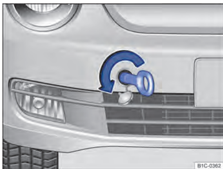
Fig. 192 No para-choque dianteiro à direita: rosquear a argola de reboque.
