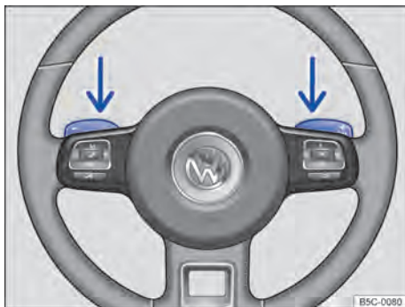
Fig. 110 Volante com 2 seletores basculantes do Tiptronic.
