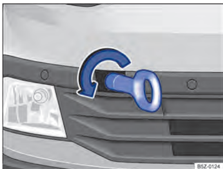
Fig. 170 No para-choque dianteiro à direita: rosquear a argola de reboque.
