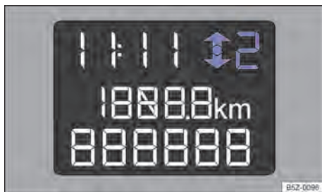
Fig. 82 No instrumento combinado: indicador de troca de marcha (variante 2).
