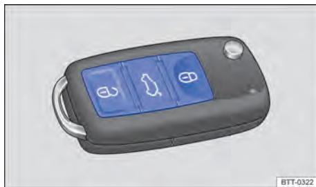
Fig. 45 Botões na chave do veículo com comando remoto.
