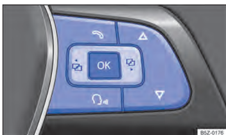
Fig. 16 Lado direito do volante multifunções: botões para comando dos menus do instrumento combinado.
