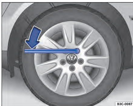
Fig. 192 Troca de roda: soltar os parafusos da roda.
