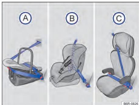
Fig. 32 As ilustrações A, B e C mostram a fixação do sistema de retenção para crianças apenas com o cinto de segurança do veículo.
