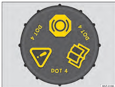
Fig. 181 No compartimento do motor: tampa do reservatório de fluido de freio (variante 2).
