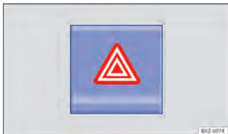
Fig. 38 Na parte superior do console central: interruptor das luzes de advertência.
