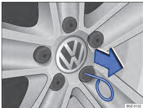
Fig. 190 Retirar as capas de cobertura dos parafusos da roda.
