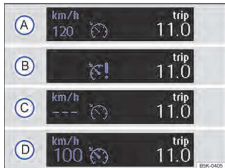
Fig. 87 No display do instrumento combinado: indicadores de status do GRA.
