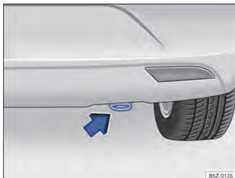
Fig. 171 No para-choque traseiro à direita: argola de reboque.
