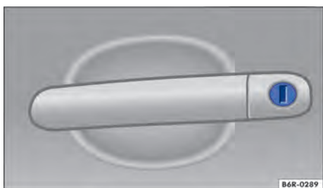
Fig. 49 Maçaneta da porta do condutor com cilindro da fechadura.
