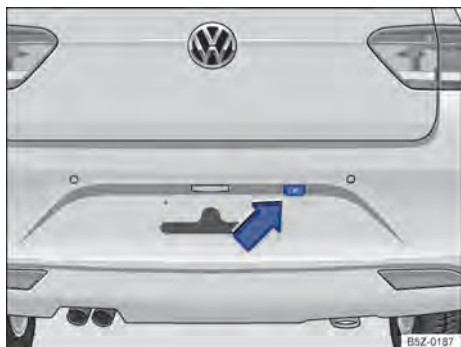
Fig. 93 No parachoque traseiro: local de instalação do assistente de condução em marcha a ré.
