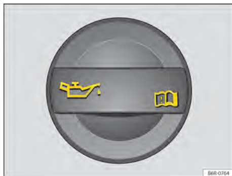
Fig. 177 No compartimento do motor: tampa da abertura para enchimento de óleo do motor.
